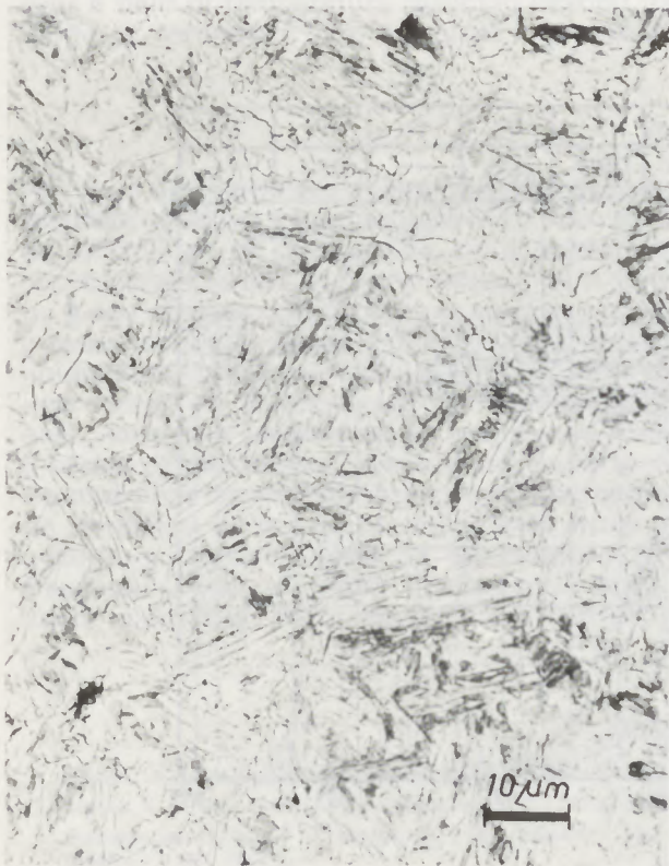
Abb. 25 37MnSi5; 1000 °C/5'; 18 °C/sec; Kurve b (Abb. 27) Ätzmittel: Nital
