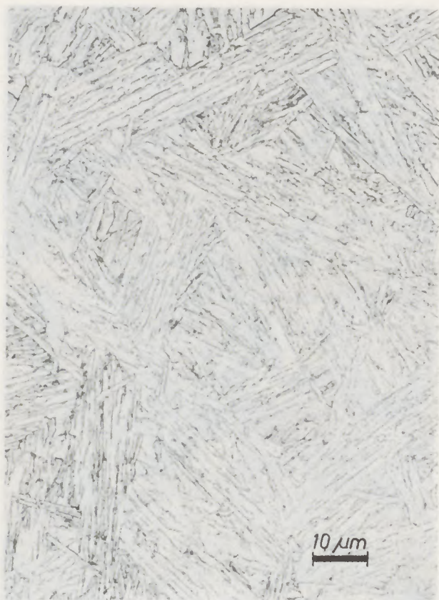
Abb. 10. 12MnSi7; 1000 °C/5'; 71 °C/sec; Kurve a (Abb. 14) Ätzmittel: Nital
