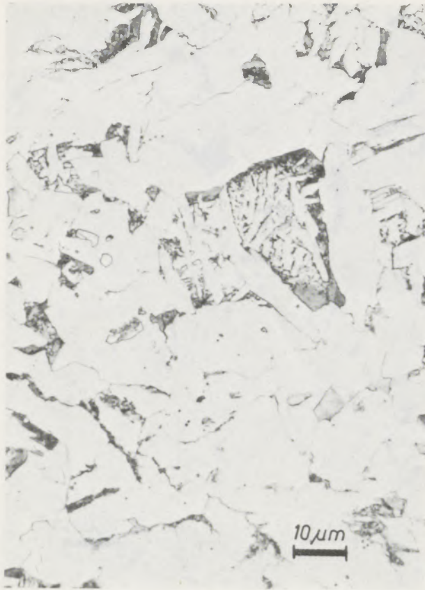
Abb. 15 12Mn6Al; 1000 °C/5'; 5,6 °C/sec; Kurve d (Abb. 22) Ätzmittel: Nital
