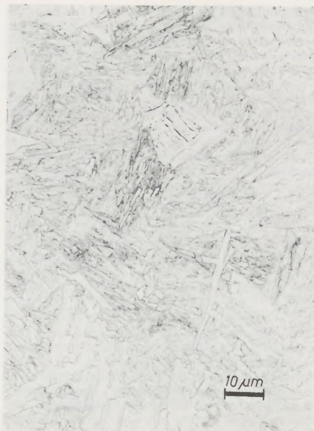
Abb. 11 12MnSi7; 1000 °C/5'; 11 °C/sec; von 600 °C abgeschreckt Kurve e, (Abb. 14); Ätzmittel: Nital
