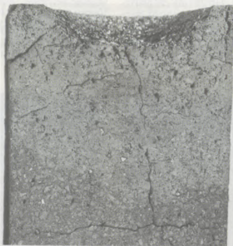
Abb. 7 Wie Abb. 5, jedoch SM-Ofenschlacke + 10% CaF 2 Links oben ganzer Tiegel, unten zusammengesetzter Tiegel, Parallelschnitt
