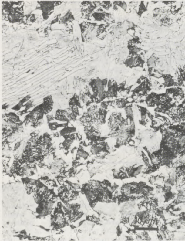
Abb. 23 37MnSi5; 1000 °C/5'; 9 °C/sec; Kurve d (Abb. 27) Ätzmittel: Nital
