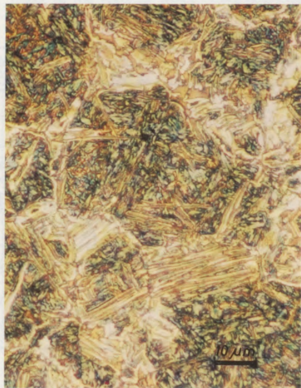
Abb. 26 37MnSi5; 1000 °C/5'; 18 °C/sec; Kurve b (Abb. 27) Ätzmittel: Klemm. Dieselbe Gefügestelle wie Abb. 25
