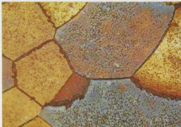
Zirkon-Niob-Legierung mit 35 % Nb, nach  $1000^{\circ}/2$  h abgekühlt mit  $80^{\circ}/h$ .
