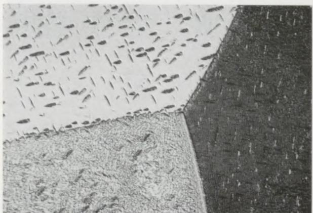
Zirkon-Niob-Legierung mit 10 % Nb, abgeschreckt von 1000 ° in Wasser. Die Phase  $\omega$  oder  $\beta''$  liegt in der  $\beta$ -Grundmasse. Die verschiedene Farbtonung ergibt sich aus der verschiedenen Orientierung der Beta-Körner.
