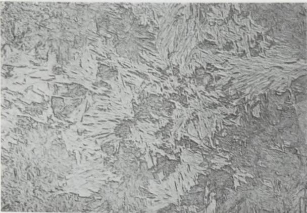
Zirkon-Niob-Legierung mit 2,5 % Nb, abgeschreckt von 1000 ° in Wasser. Das Gefüge besteht aus der  $\alpha'$ -Phase, die durch ihre verschiedene Orientierung unterschiedlich angegriffen ist.
