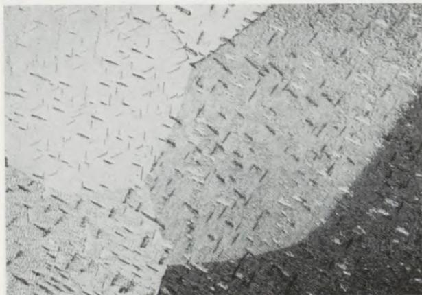
Zirkon-Niob-Legierung mit 10 % Nb, abgeschreckt von 1000° in Wasser, Omegaphase in  $\beta$ -Grundmasse.
