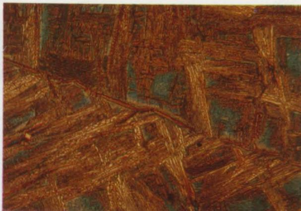
Zirkon-Niob-Legierung mit 10 % Nb, nach 1000<sup>0</sup>/2 h abgekühlt mit 30<sup>0</sup>/h. Die  $\alpha$ -Phase erscheint stärker aufgelöst und in größerer Menge gegenüber Abb. 6018. (Es ist offensichtlich, daß sich die  $\alpha$ -Phase an den Korngrenzen bildet.)
