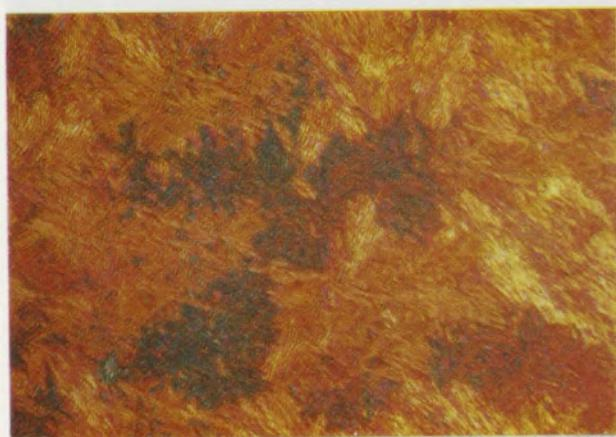
Zirkon-Niob-Legierung mit 2,5 % Nb, abgeschreckt von  $1000^{\circ}$  in Wasser. Die Farbprüfung zeigt das Vorhandensein von verschieden orientierten Bereichen.
