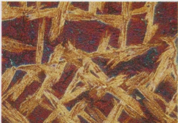
Zirkon-Niob-Legierung mit 10 % Nb, nach 1000<sup>0</sup>/2 h abgekühlt mit 80<sup>0</sup>/h. Die  $\alpha$ -Phase erscheint gelb und das Monotektoid rot-blau.
