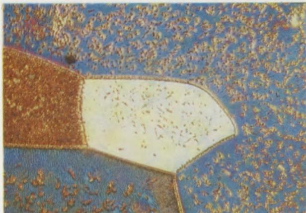
Zirkon-Niob-Legierung mit 25 % Nb, nach  $1000^{\circ}/2$  h abgekühlt mit  $80^{\circ}/h$ . Die verschiedene Färbung der Körner ist eine Funktion der unterschiedlichen Orientierung.
