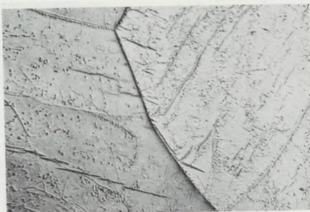
Zirkon-Niob-Legierung mit 10 % Nb, abgeschreckt von 1000° in Wasser und angelassen 4 Stunden bei 400°. Das Gefüge besteht aus angelassener Omegaphase, Beta-Niob und  $\alpha$ -Lamellen.
