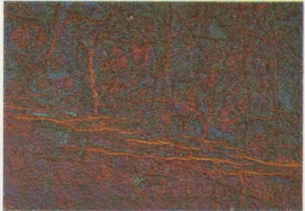
Zirkon-Niob-Legierung mit 10 % Nb, nach Abschrecken von 1000° in Wasser und Anlassen durch 4 Stunden bei 400°.
