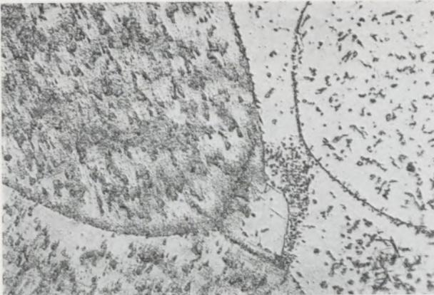
Zirkon-Niob-Legierung mit 20 % Nb, nach 1000 °/2 h abgekühlt mit 80 °/h. Das Gefüge besteht hauptsächlich aus dem Monotektoid.
