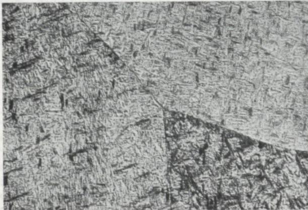
Zirkon-Niob-Legierung mit 10 % Nb, nach 1000 °/2 h abgekühlt mit 80 °/h. Das Gefüge besteht aus α-Lamellen in einer Grundmasse aus dem Monotektoid.
