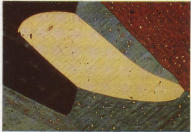
Zirkon-Niob-Legierung mit 25 % Nb, abgeschreckt von 1000° in Wasser; Betakörner verschieden orientiert.
