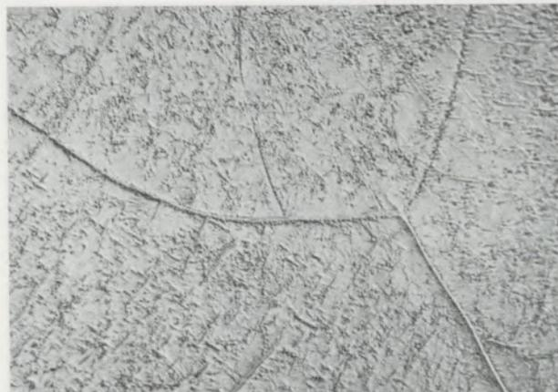
Zirkon-Niob-Legierung mit 10 % Nb, abgeschreckt von 1000° in Wasser und angelassen 2 Stunden bei 400°. Das Gefüge besteht aus angelassener Omegaphase und Beta-Niob.
