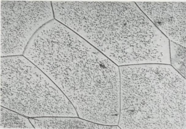
Zirkon-Niob-Legierung mit 25 % Nb, nach 1000 °/2 h abgekühlt mit 80 °/h. Das Gefüge besteht aus Monotektoid und Beta-Niob an den Korngrenzen.
