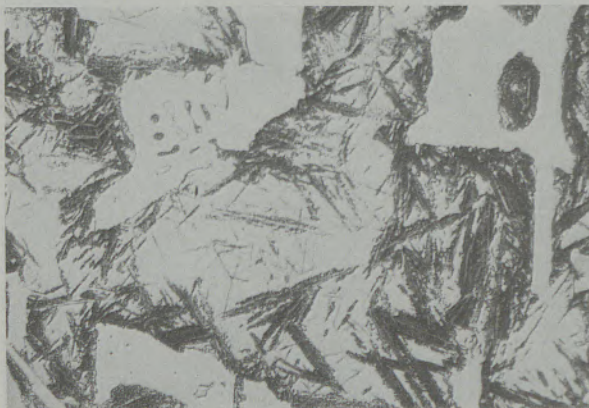
Ni-hard Typ 1 nach Behandlung Nr. 4, Bainit in Form feinsten Nadeln
