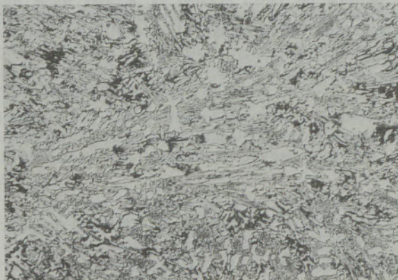
Ni-hard Typ 2: Gußzustand, Karbide und Primärkristalle, vornehmlich aus Austenit
