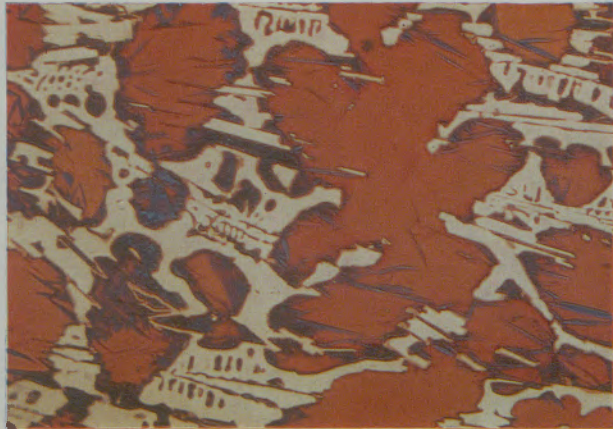
Ni-hard Typ 2: Gußzustand, Martensitnadeln an den Rändern der Primärkörner
