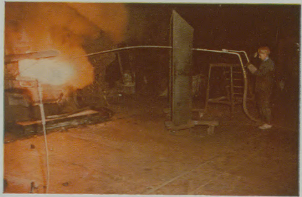
Abb. 26 Entkohlen mit der Sauerstofflanze. Gleichzeitig wird Kalk eingeblasen
