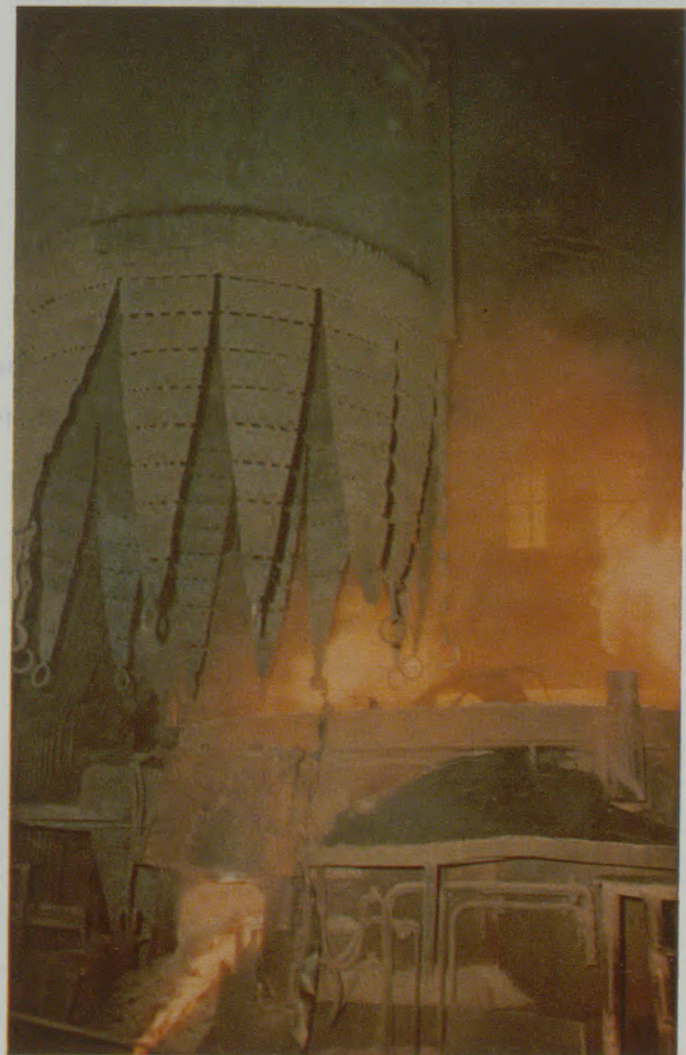
Abb. 4 Nach dem Chargieren eines der Elektro-Öfen
