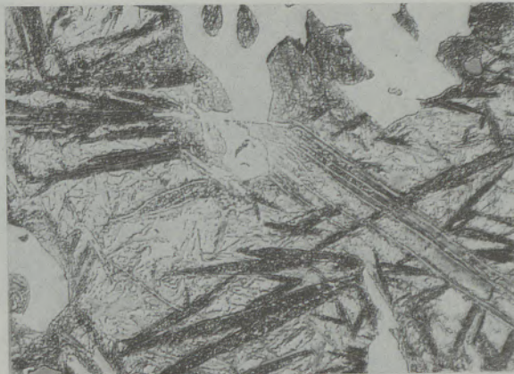
Ni-hard Typ 1 nach Behandlung Nr. 1 und allmählicher Abkühlung
