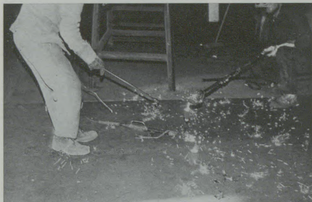
Abb. 17 Gießen der Erstarrungsprobe für die Kohlenstoffbestimmung
