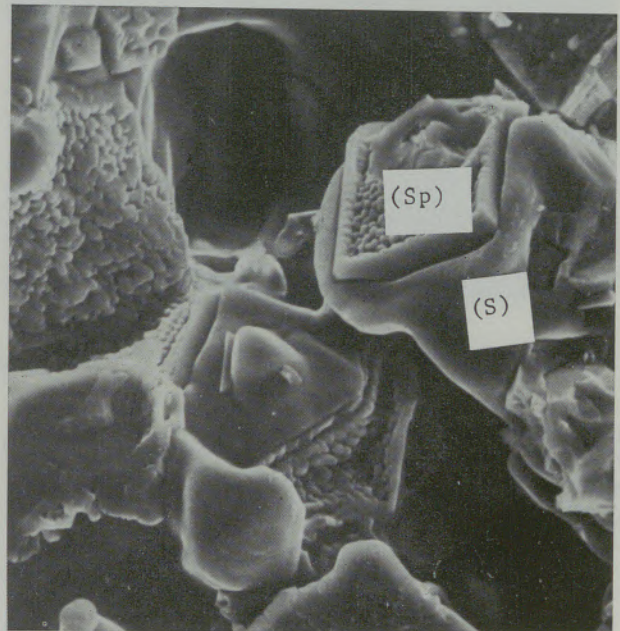
Abb. 7 V = 1000\times 1480 °C. Oberfläche nach Heißbruchversuch der Mischung 17 C/S = 0,29 (Sp) Spinell (S) Silikat
