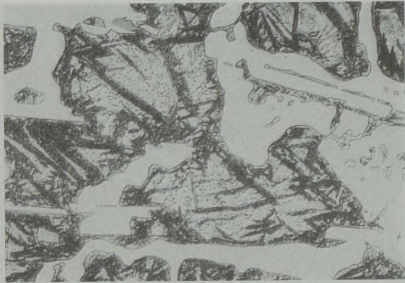
Ni-hard Typ 1 nach Behandlung Nr. 1: Die Primärkristalle bestehen aus groben, angelassenen Martensitnadeln, feinem Martensit, Restaustenit
