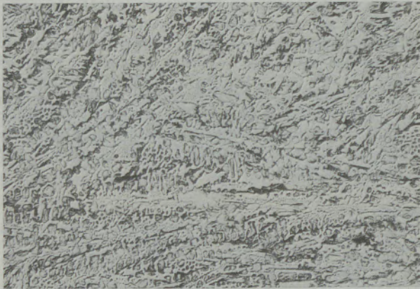
Ni-hard Typ 1: Gußzustand, Außenseite des Abgusses; komplexe Karbide aus Fe und Cr und Primärkristalle, bestehend aus Martensit, Bainit und Restaustenit
