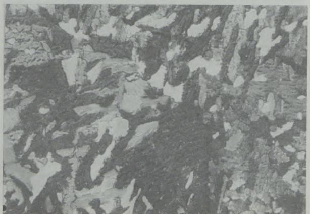
3325 Aus dem  $\beta$ -Bereich gehärtetes Zirkonium (980 °C).
