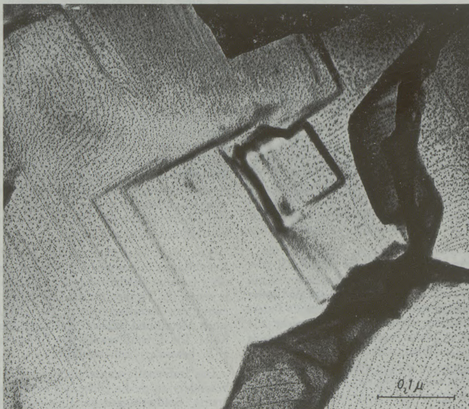
Abb. 4 b Platindekoration einer Kochsalzaufdampfschicht, Kohleabdruck Vergrößerung 200.000 : 1
