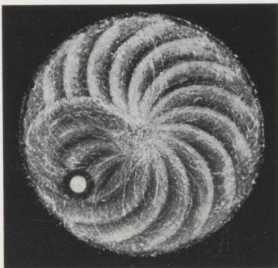
Der helle Fleck entsteht regelmäßig durch Kornstau unter dem Meßbolzen.
