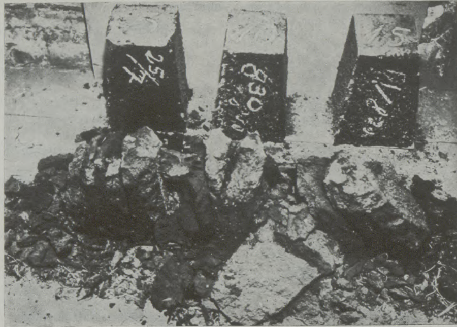
Abb. 19 Beständigkeit gepreßter Steine an Luft. Aussehen 5 Tage nach Herstellung
