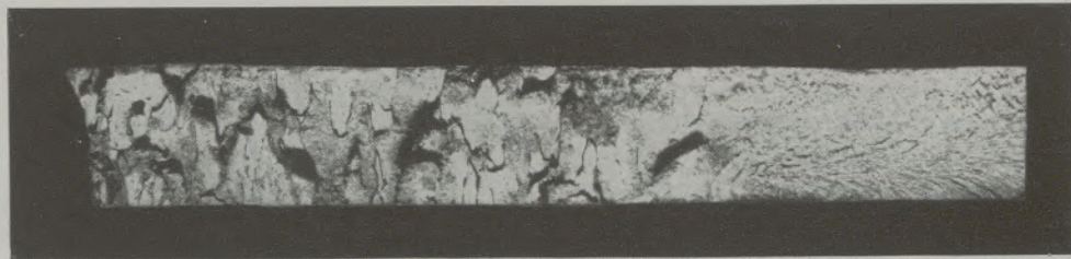
Abb. 1 Flocken im Bruchgefüge einer Scheibe
