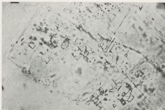
20. Poren im Magnetitkorn
