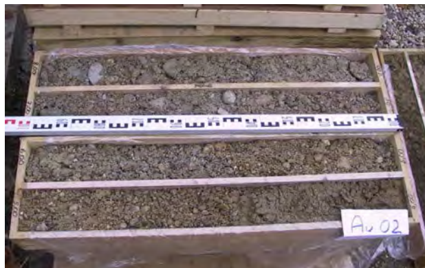
Abbildung 99: Bohrkerne Au 02: -4 bis -8 m
