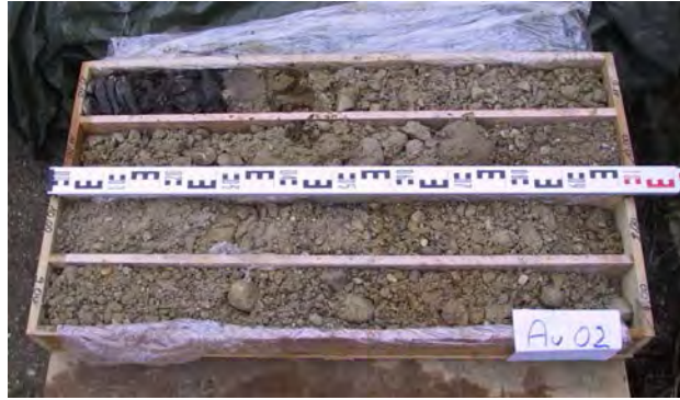
Abbildung 100: Bohrkerne Au 02: -8 bis -16 m
