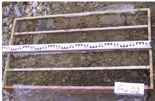
Abbildung 98: Bohrkerne Au 02: 0 bis -4 m
