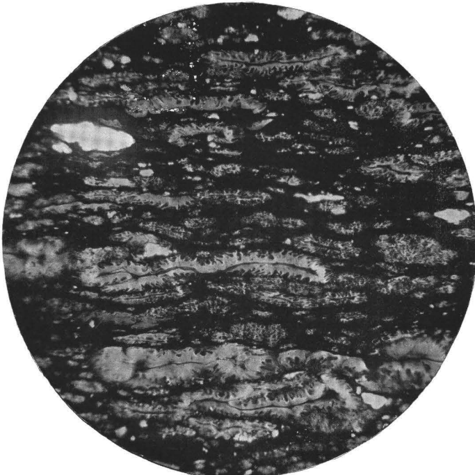
Fig. 27. Sapanthrakon-Gestein („Kerosene shale“) von Blackheath westlich von Hartley in Australien. Schliff senkrecht zur Schichtungsfläche. \frac{75}{1} der natürl. Größe. Die Algen („ Reinschia australis “) sind zusammengesunken (bandförmig). — Nach einer Photographie von C. EG. BERTRAND.
