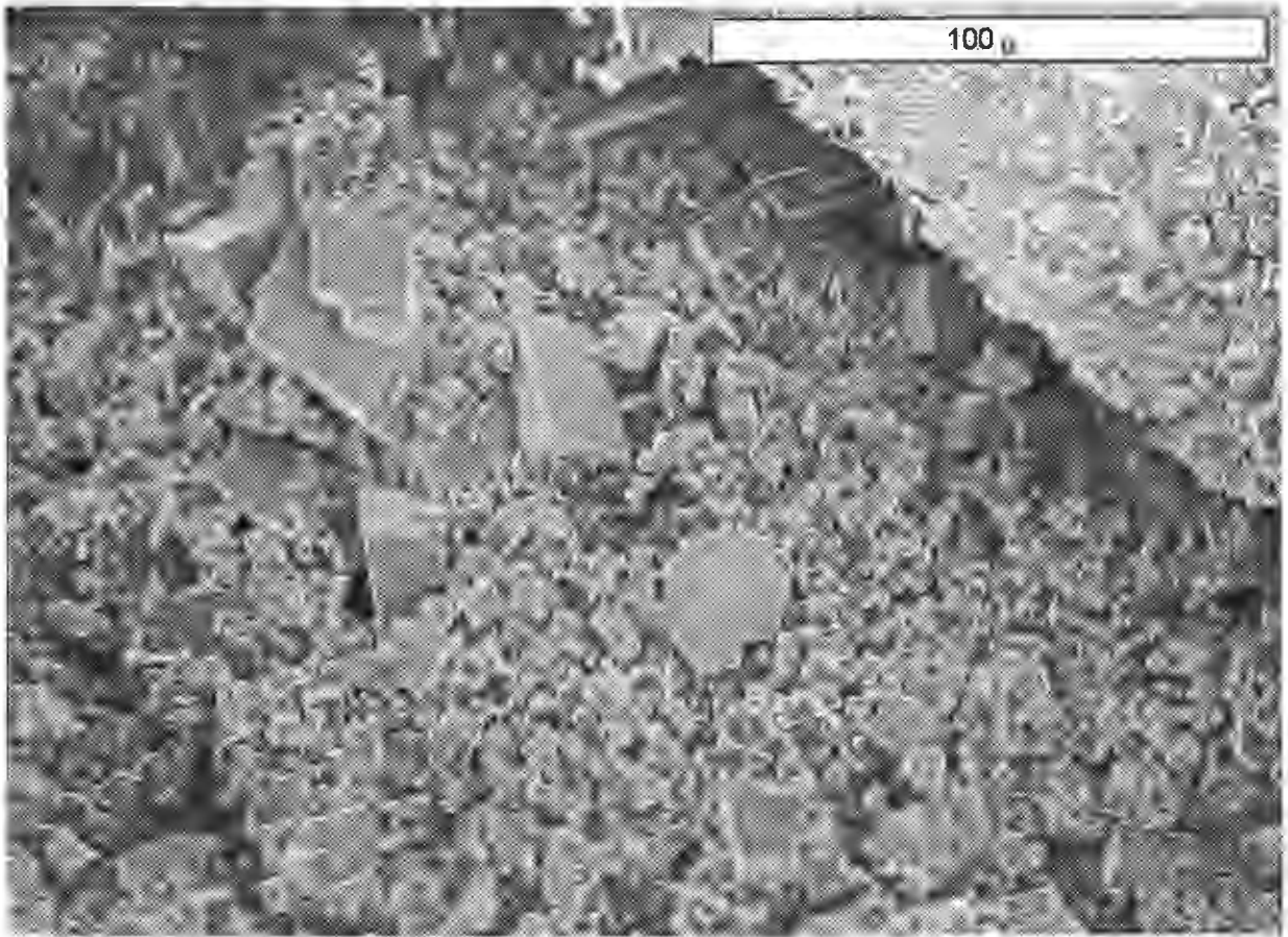
Abb. 5: Rasterelektronenmikroskopische Aufnahme einer Kluftfläche 3. Ordnung mit idiomorphen Dolomitekristallen
