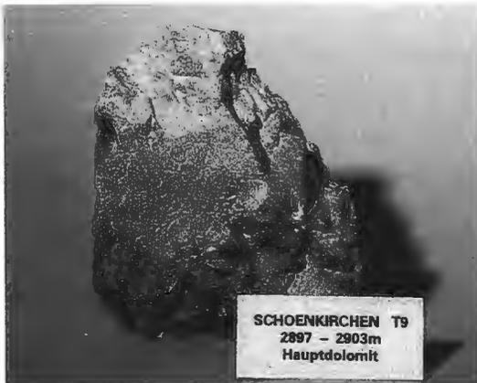
Abb. 10: Bohrkern im geklüfteten, Hauptdolomit der Göller Decke von Schönkirchen-Prottes Tief. Kerndurchmesser 10cm Photo H.Rüppel OMV
