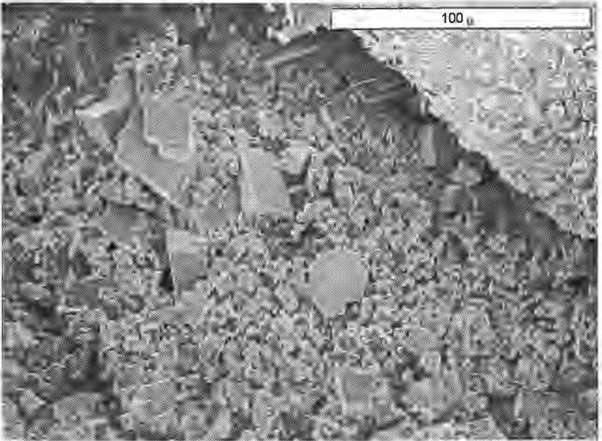
Abb. 5: Rasterelektronenmikroskopische Aufnahme einer Kluftfläche 3. Ordnung mit idiomorphen Dolomikristallen
