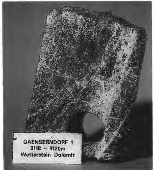
Abb. 11: Bohrkern im geklüfteten z.T. mylonitisierten Wettersteindolomit einer südlichen Kalkalpenzone des Raumes Schönfeld im Marchfeld. Kerndurchmesser 10 cm. Photo H.Rüppel OMV
