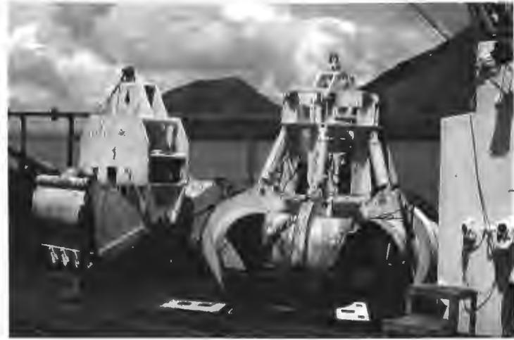
Abb. 4: Elektrohydraulische Fernseh-Greifer GTVA (links) und GTVD (Polypgreifer, rechts), vorbereitet für den Einsatz. Im Hintergrund sind zwei Vulkankegel auf Rabaul (Neubritannien, Papua-Neuguinea) zu erkennen.
