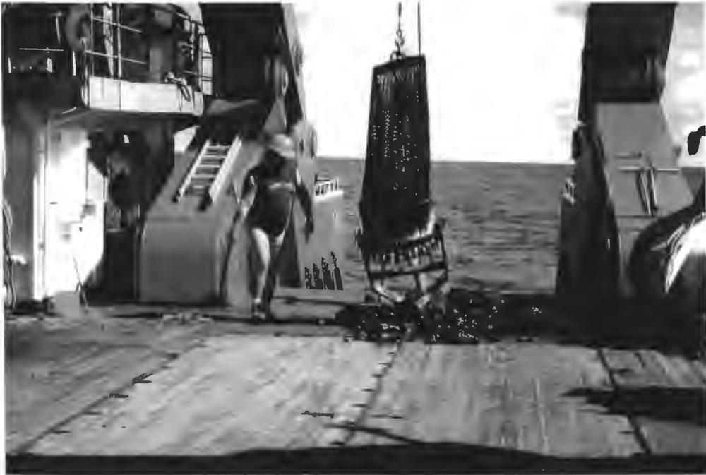
*Abb. 6: Runde Kettensack-Dredge wird nach erfolgter Probennahme am Tiefseeboden an Bord entleert.*
