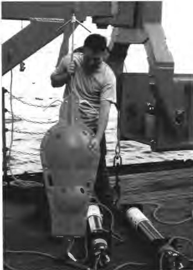
*Abb. 7: Positionierungssender (Transponder) mit Auftriebskörper, Sender, Notlicht und Peitsche sowie Signalflagge, vorbereitet für den Einsatz in der Tiefsee.*
