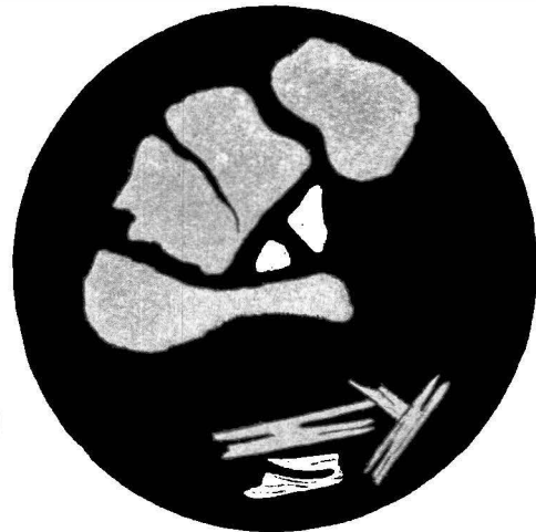
Fig. 3. Erzschliff aus Öblarn. Oben Quarz von Erz durchzogen; unten Glimmer, in dessen Risse Erz eindringt.
