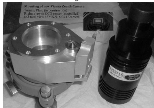
Breiten/Längenmessung erfolgt bisher meist mit Zeiß-Astrolab ( $\sim 15$  Sterne  $z=30^\circ$ ,  $< 1 \text{ h}$ ) oder Zenitkameras ( $\frac{1}{4} \text{ h}$ , aber Auswertung langwierig). In CCD-Projekten der TU Wien werden seit 1999 Möglichkeiten der Automatisierung erkundet. Sie ergaben am DKM3, Astrolab und TCA  $\pm 1''$ , allerdings nur wenig schneller als bisher.
