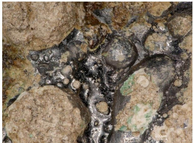
Abbildung 23: Probe Gast 6 Oberfläche: (a, b) pflanzliche Rückstände; (c–e) Korrosionsprodukte; (f) sulfidische Bereiche
