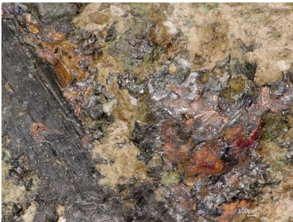
Abbildung 23: Probe Gast 6 Oberfläche: (a, b) pflanzliche Rückstände; (c–e) Korrosionsprodukte; (f) sulfidische Bereiche
