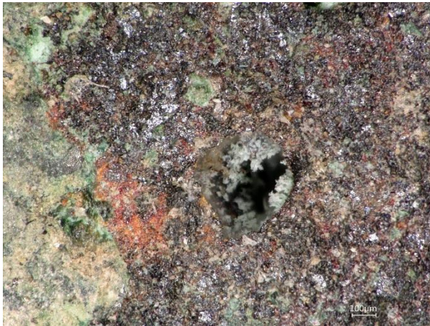
Abbildung 20: Probe Gast 5 Oberfläche: (a, b) Korrosionsprodukte an der Oberfläche
