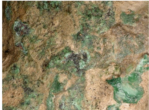
Abbildung 20: Probe Gast 5 Oberfläche: (a, b) Korrosionsprodukte an der Oberfläche
