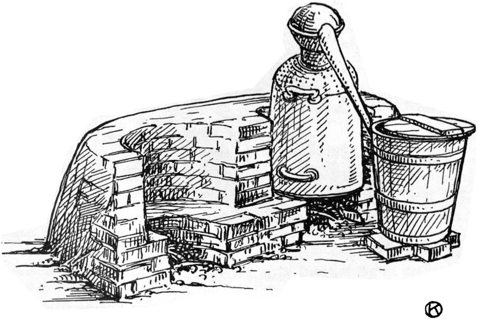
Fig. 31. Einfacher Destillationsapparat für Rosenöl und Raki.
