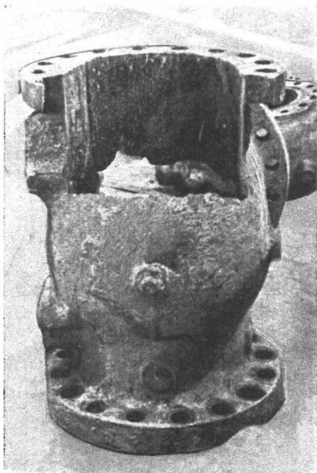
Der demolierte Hauptabsperrschieber nach dem Erdgasausbruch bei Enzersdorf a. d. Fischa
