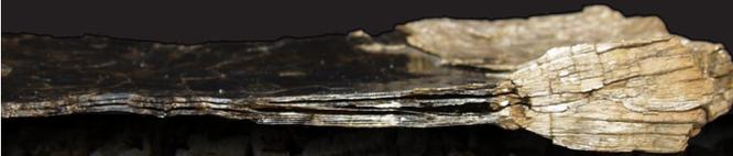
Werden Vermiculit-Kristalle stark erhitzt, expandiert das entweichende Wasser die Kristalle zieharmonikaförmig zu namensgebenden „Würmchen“.
