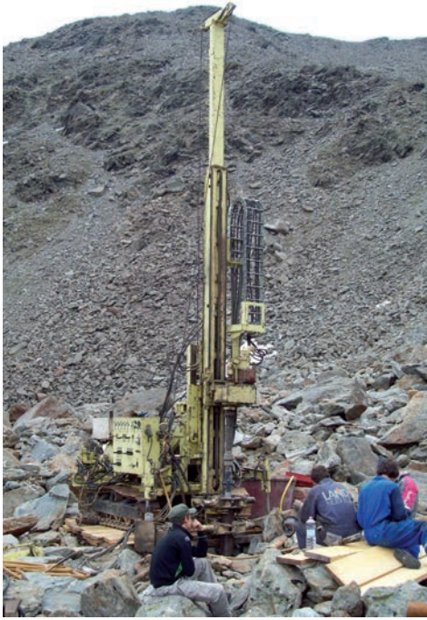
Abb. 7: Kernbohrung am aktiven Blockgletscher im Bereich der Lazaunalm im hinteren Schnalstal (südliche Ötztaler Alpen, Südtirol)
