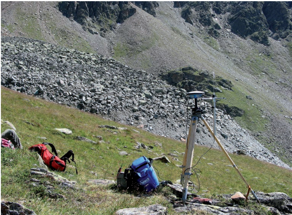
Abb. 5: GPS-Basisstation, eingerichtet auf einem Fixpunkt auf anstehendem Fels neben der Zunge des aktiven Blockgletschers in der Inneren Ölgrube (Kaunertal)
