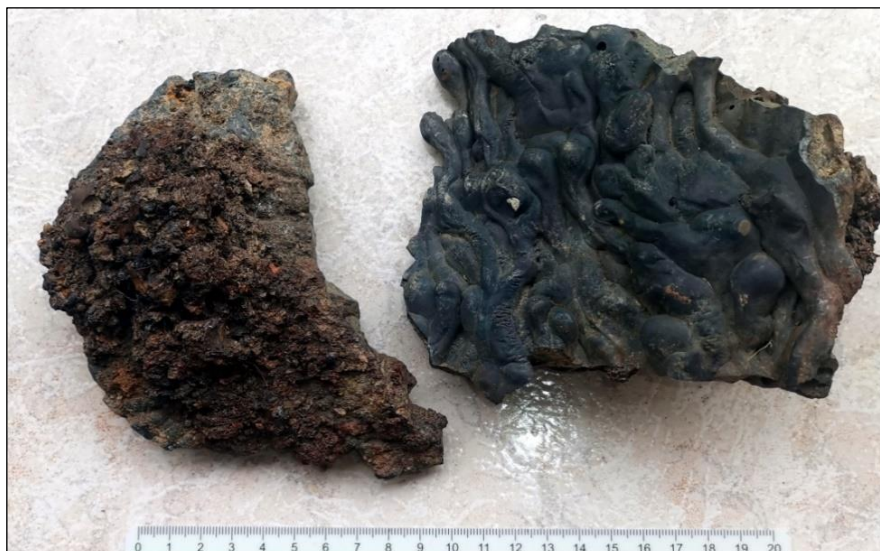
Abb. 45: Laufschlacke Stambach. Rechts die Oberseite mit Fließsträngen, links die Unterseite mit eingebackendem Splitt des Ablaufkanals. Sammlung: Verfasser
