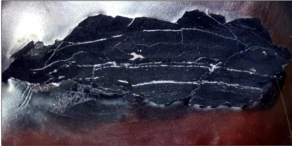
Abb. 19: Anschliff von Glanzschiefer der Stampfer Kehr. Bei den hellen Streifen parallel der Schieferung handelt es sich um Pyrit, die weißen breiteren Spots bestehen aus Galenit. Bildbreite 4,5 Zentimeter. Sammlung: Verfasser
