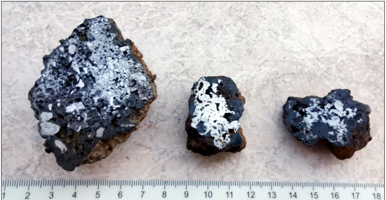
Abb. 50: Metallisches Eisen hell mit schwarzem Wüstit. Proben aus der Zone unterhalb der Luppe. Maßstab in Zentimetern. Sammlung und Schliff: Verfasser
