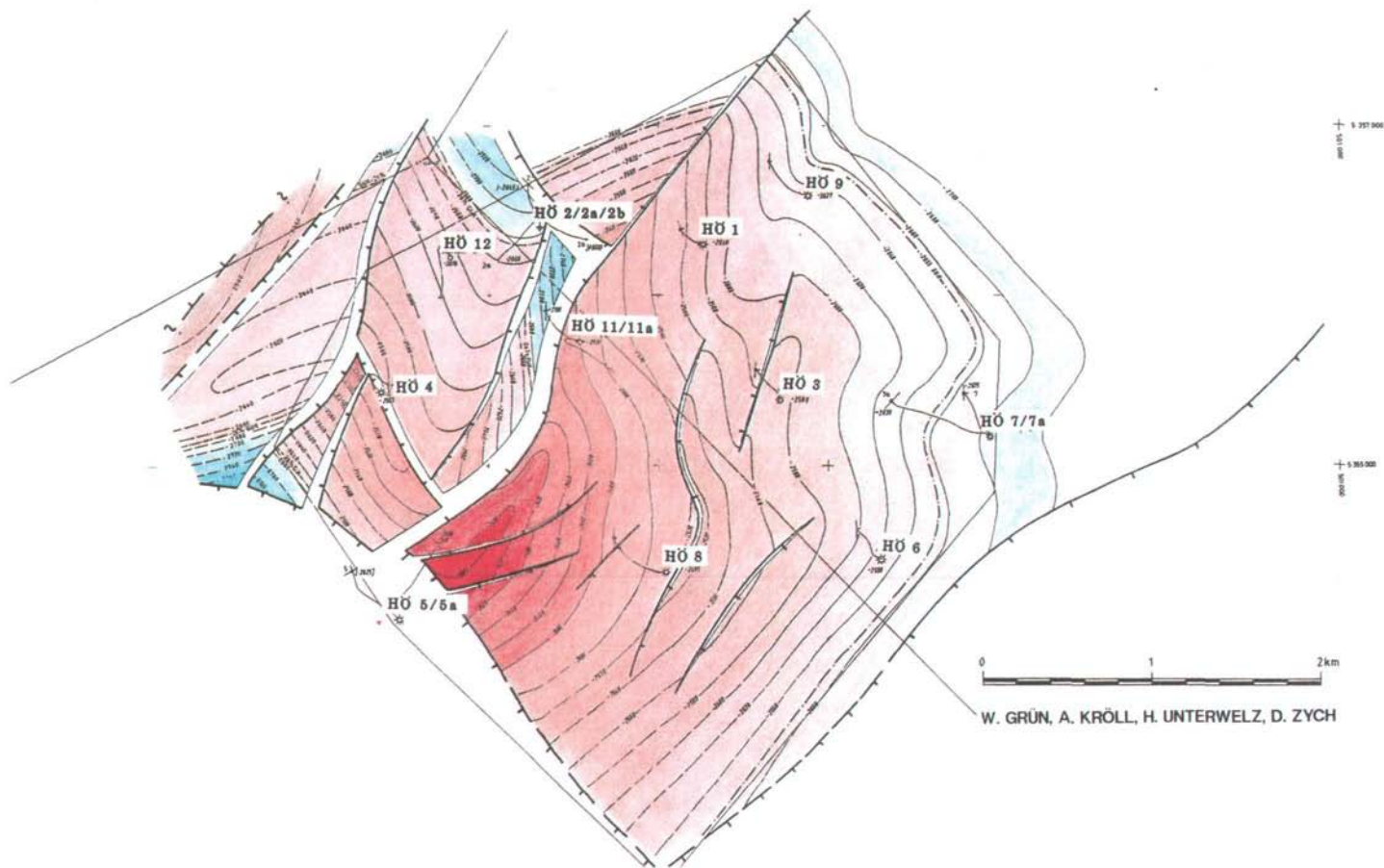
Fig. 29: Structural map of the gas condensate field Höflein, top Dogger (W. GRÜN, A. KRÖLL, H. UNTERWELZ & D. ZYCH).
