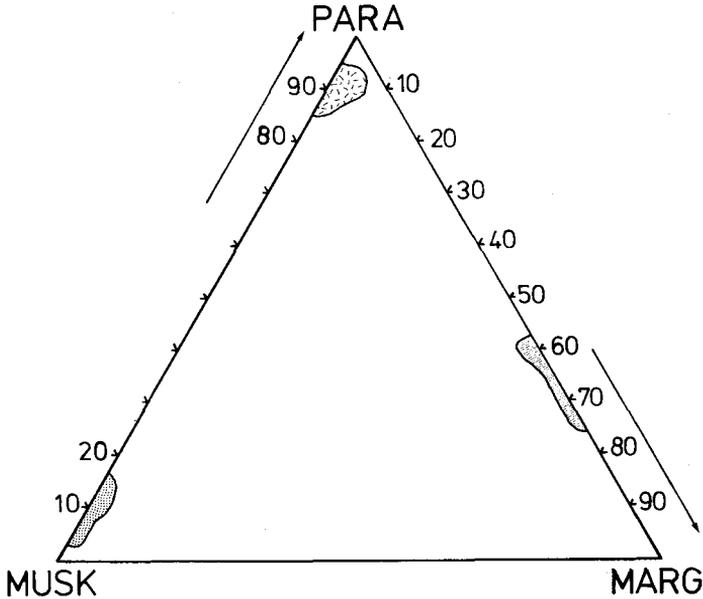
Abb. 12: Chemische Zusammensetzung der Hellglimmer aus unterschiedlichen Eklogit-varietäten aus Kluft, Nebengestein und vom Salband. PARA = Paragonit ( $\text{Na}/(\text{Na}+\text{K}+\text{Ca})$ ), MUSK = Muskovit ( $\text{K}/(\text{Na}+\text{K}+\text{Ca})$ ), MARG = Margarit ( $\text{Ca}/(\text{Na}+\text{K}+\text{Ca})$ ).
