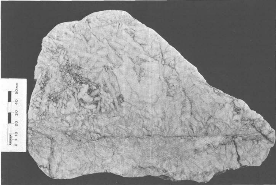
Abb. 3: Millstätter Alpe/Radenthein (Kärnten). „Spat-Magnesit“. Magnesit-Marmor mit typischem, grobkörnigem Gefüge, läßt stellenweise relativ große Magnesit-Körner (Porphyroblasten bzw. Idioblasten) beobachten.
