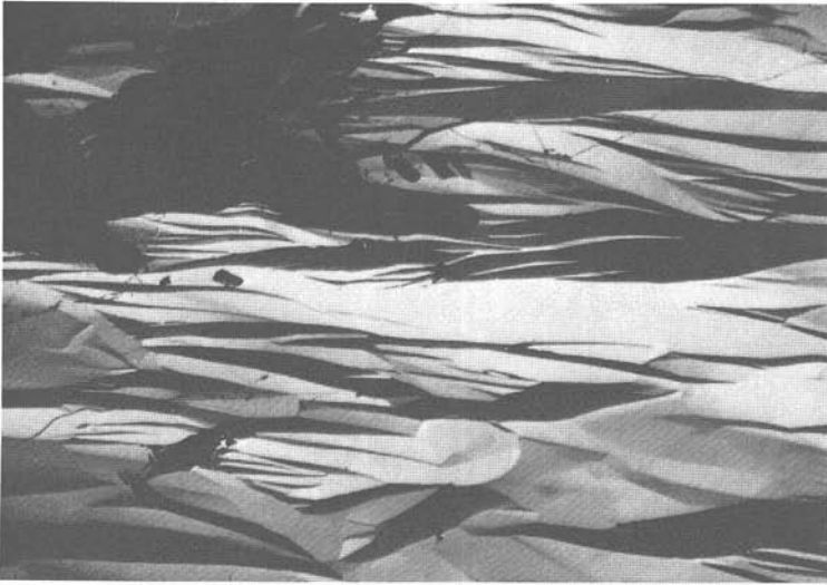
Abb. 17: Dörflerbachgraben bei Vorau (Steiermark). Durch tektonische Beanspruchung stark postkristallin deformierter Magnetkies löscht undulös aus und läßt ausgezeichnet extreme Drucklamellierung bzw. auf Translation zurückgehende Zerknitterungslamellen beobachten. Anschliff, Vergr.: 75×, Polarisatoren +
