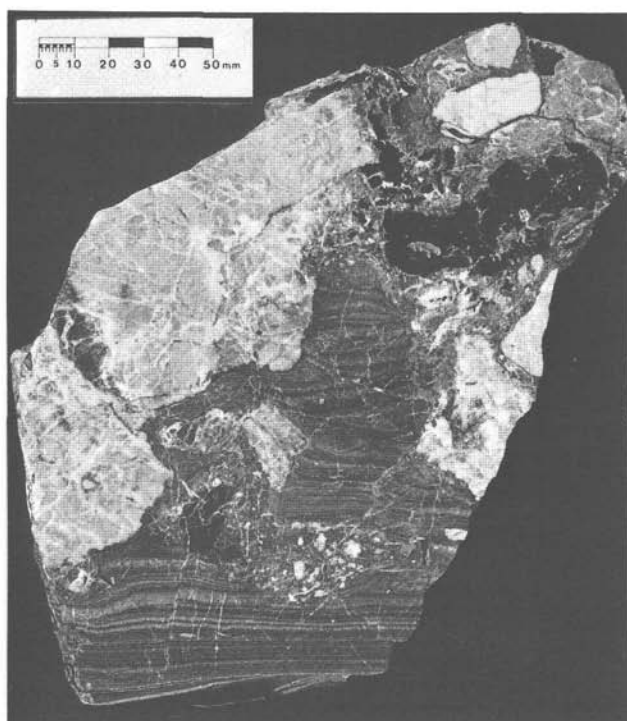
Abb. 6: Mežica, Graben-Revier, zentraler Teil, 12. Lauf. Ausschnitt aus Abb. 5. Detail mit Breccie im feinschichtigen Erz-Sediment (Zinkblende-Bleiglanz-Dolomit-Rhythmit), das Load-casts aufweist. Im Hangenden findet sich eine größere Partie von sammelkristallisiertem Bleiglanz.
