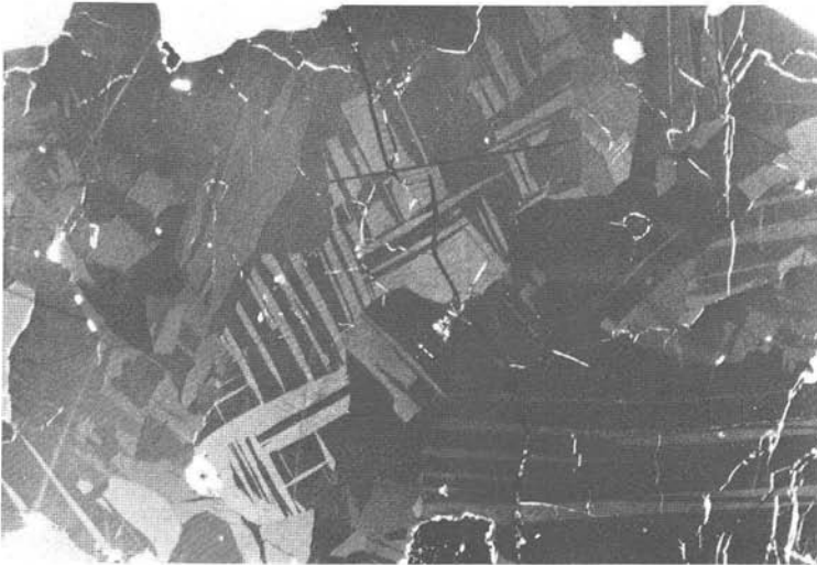
Abb. 18: Dörflerbachgraben bei Vorau (Steiermark). Ausschnitt aus Kupferkies-Partie mit ausgeprägten oleanderblatt- bis lanzettförmigen Umwandlungslamellen von Hochtemperatur-Kupferkies. Gangart erscheint durch Innenreflexe aufgehellert. Anschliff, Vergr.: 75×, Polarisatoren +
