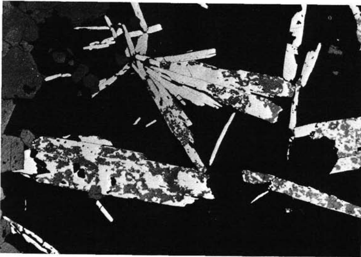
Abb. 2: Fröschnitzgraben/Semmering (Steiermark). Idioblastischer Magnetit (dunkelgrau) und idioblastischer Eisenglanz (lichtgrau) in sideritischem Karbonat (schwarz). Die tafeligen Hämatit-Kristalle werden deutlich von Magnetit verdrängt und pseudomorphisiert („Muschketoffit“). Anschliff, Ölimmersion, Vergr.: 40\times .
