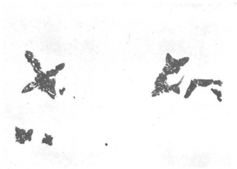
Abb. 20: Meiselding (Kärnten). Kupferkies (Hochtemperatur-Kupferkies; fast weiß) mit Entmischung von Zinkblende (dunkelgrau) in Form der typischen, deutlich verzweigten „Zinkblende-Sternchen“. Anschliff, Ölimmersion, Vergr.: 375×.
