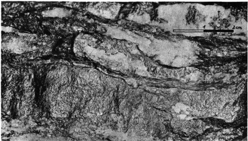
Abb. 2: Lagergangförmige Kupferkies-Pyritvererzung (hellgrau, mit Strichen abgegrenzt) in Serizitphyllit-Serizitquarzit (dunkelgrau), leicht verfalltet, mit Quarzknuern (weiß). Arthurstollen, Brandergang, Meter 4060. (Phot. L. Weber)
