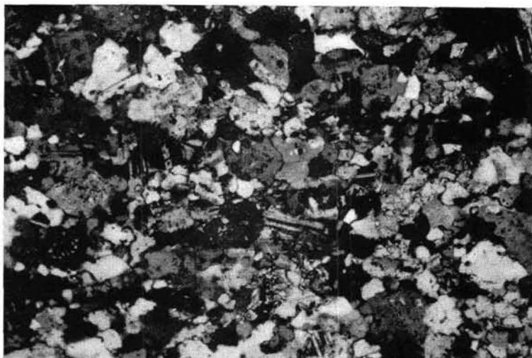
Abb. 9: Quarzitische Arkose; Feldspat-Karbonat-Quarz-Gefüge; gekreuzte
