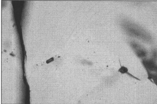
Abb. 6 Primärer Einschuß (Durchmesser ca. 10\ \mu\text{m} ) mit Bruchstruktur (rechts "Flügel"), entstanden durch das Gefrieren des Einschusses, links unversehrter primärer Einschluß.
