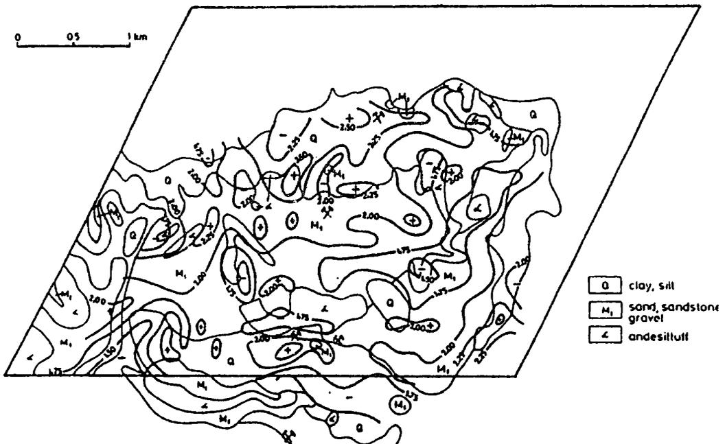
Abbildung 3: Isodichtenkarte mit Oberflächengeologie
