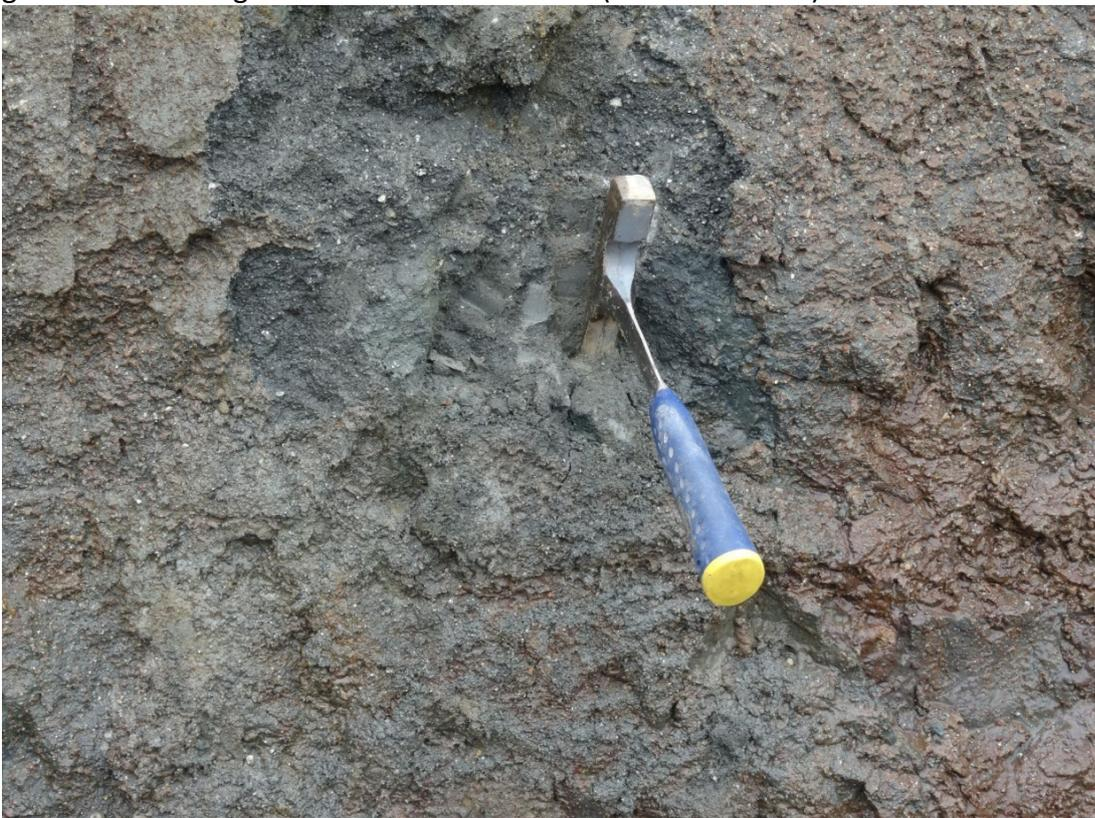
Abb. 2.1.2.18: Baugrube in Niederrottensheim: Kristallin-Grus in der Pielach-Formation (Foto: M. Linner).
