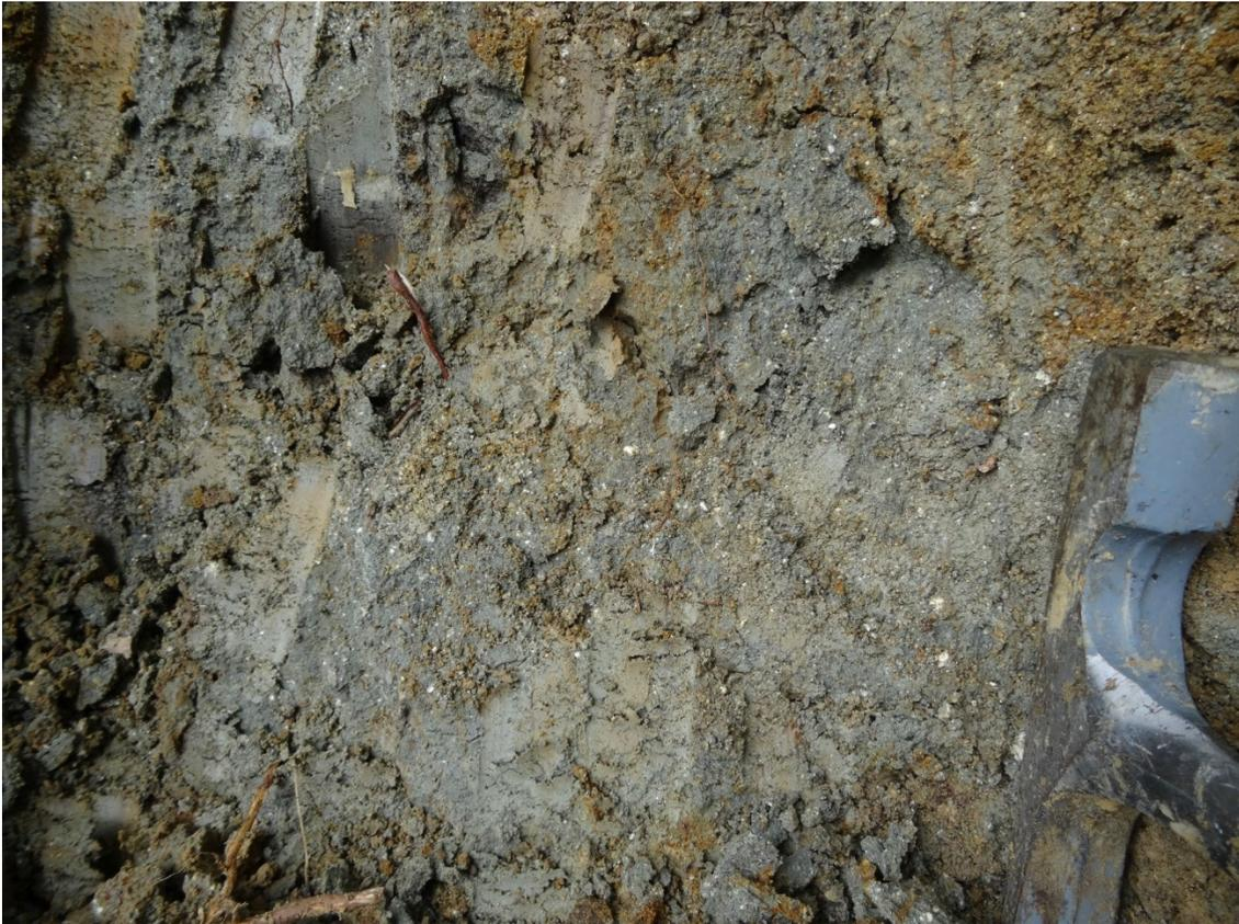
Abb. 2.1.2.26: Aufschlussverhältnisse im Kartierungsgebiet im Bereich Kürnberger Wald: Grobkörnige, graue bis rostrote Sande der Pielach-Formation; Reste von Kristallingrus erkennbar (Foto: Ch. Rupp).
