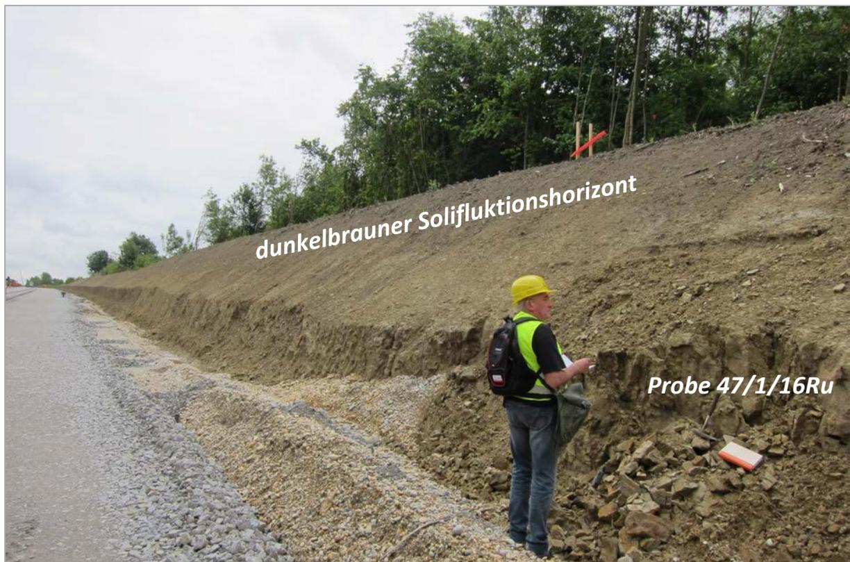
Abb. 2.1.1.8: Hanganschnitt an der A8 östlich der Anschlussstelle Ried im Innkreis; gebankte braune bis olivgrüne Ried-Formation; Probenpunkt an der Basis (Foto: M. Peresson).
