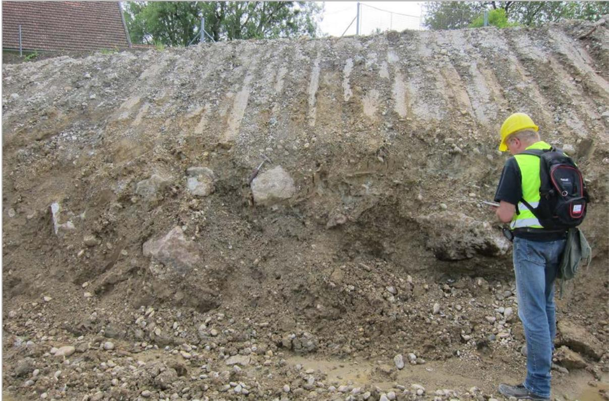
Abb. 2.1.1.25: Hanganschnitt an der A8 südlich von Wallner (Ried im Innkreis): Quarz- bzw. Quarzitkonglomerate (umgelagerte Pramquellen-Bank) in Form großer Blöcke; im Hangenden quartäre Kiese in schluffig sandiger Matrix (Foto: M. Peresson).
