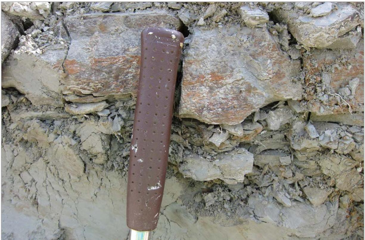
Abb. 2.1.1.50: Hanganschnitt an der A8 im Bereich der Gemeinde Rabenberg; stark tektonisierte Ried-Formation (Foto: M. Peresson).
