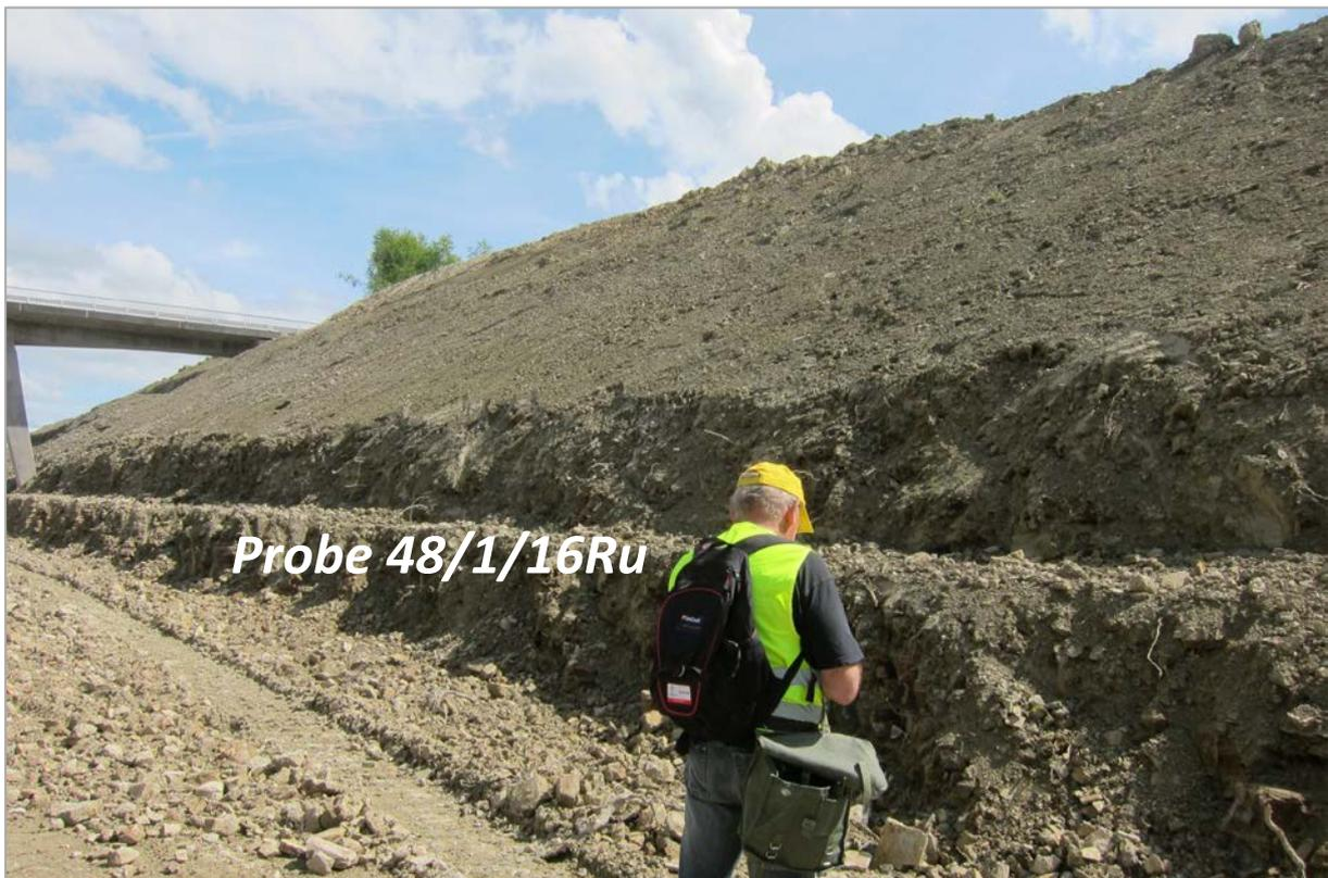
Abb. 2.1.1.46: Hanganschnitt an der A8 im Bereich der Gemeinde Rabenberg; tektonisierte Ried-Formation; Probenahmepunkt: 48/1/16Ru (Foto: M. Peresson).
