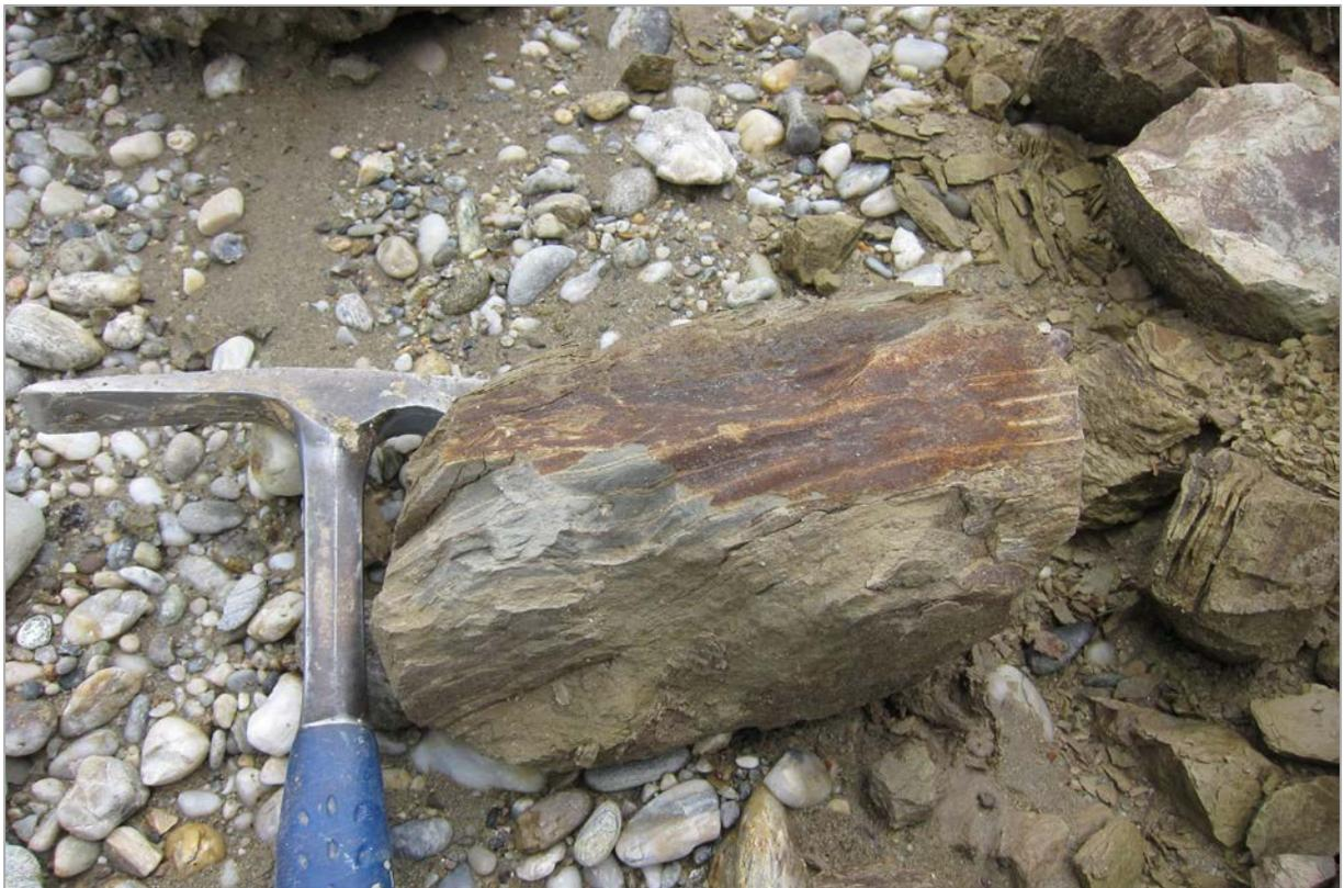
Abb. 2.1.1.12: Hanganschnitt an der A8 östlich der Anschlussstelle Ried im Innkreis; Siltstein (beige)/Tonstein (dunkelgrau) Lamination innerhalb der Ried-Formation (Foto: M. Peresson).
