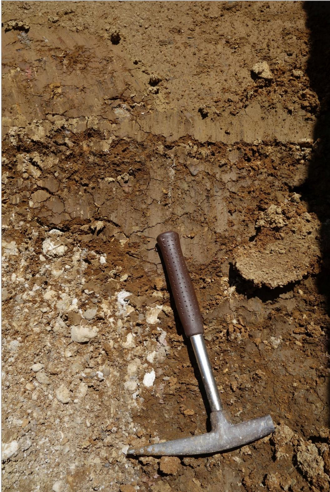
Abb. 2.3.1.17: Baugrube in Dietach: Detailaufnahme im Grenzbereich des rötlichen Paläobodens zu den unterlagernden teilweise karbonatisch verkitteten „Älteren Deckenschottern“ (H. Peresson).
