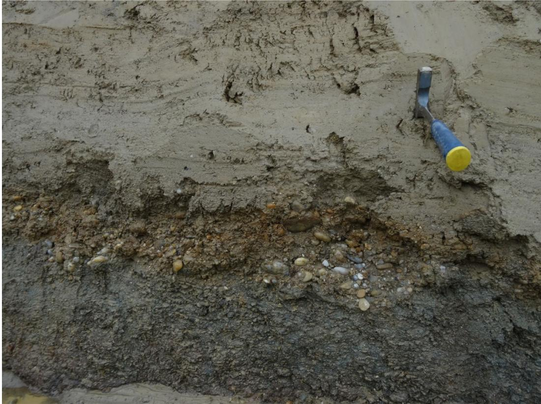
Abb. 2.1.2.11: Baugrube in Niederrottensheim: Detailfoto der schlecht sortierten rötlichen Quarzsotter (Deckenschotter?) (Foto: M. Linner).
