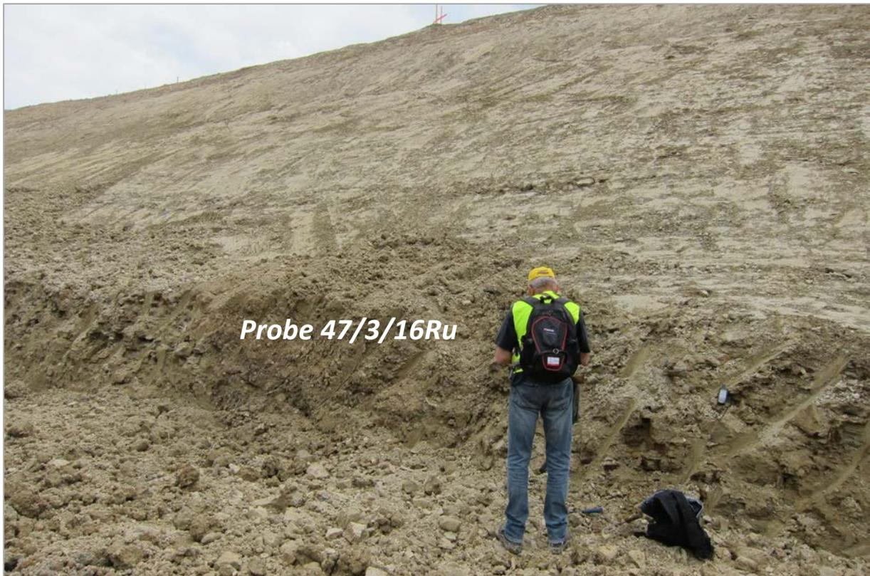
Abb. 2.1.1.37: Hanganschnitt an der A8 südöstlich der Ortschaft Wallner; undeutlich gebankte Ried-Formation, stark tektonisiert; Probenahmepunkt (47/3/16Ru) (Foto: M. Peresson).
