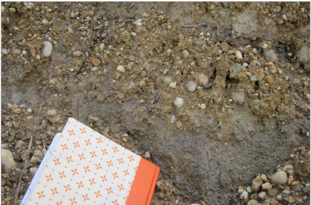
Abb. 2.1.1.56: Hanganschnitt an der A8 im Bereich der Gemeinde Rabenberg; Terrassenkiese lagig aufgebaut (Foto: M. Peresson).
