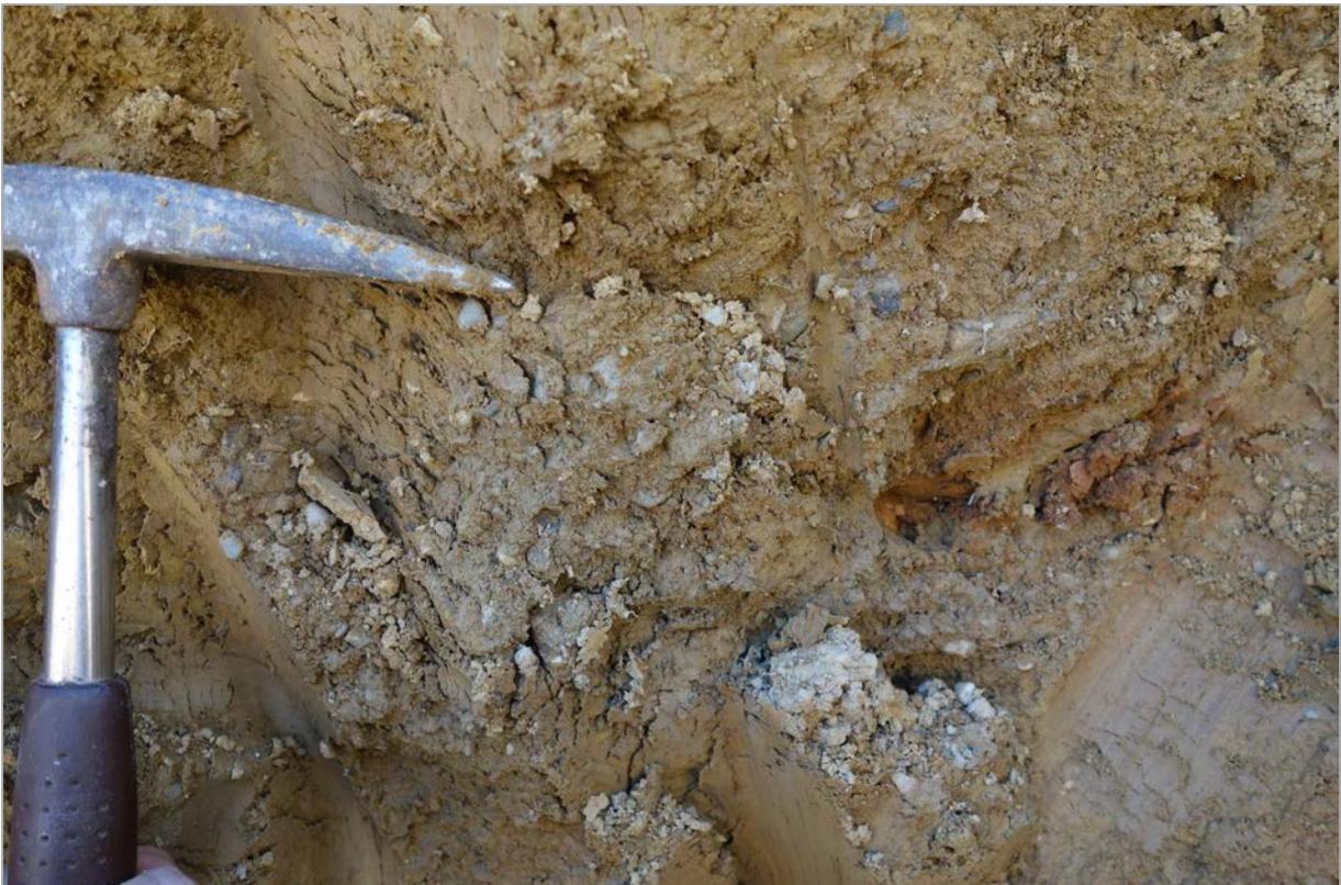
Abb. 2.3.1.13 Baugrube in Dietach: Kieslage im Übergang Löss-Lehm zu Paläoboden (H. Peresson).
