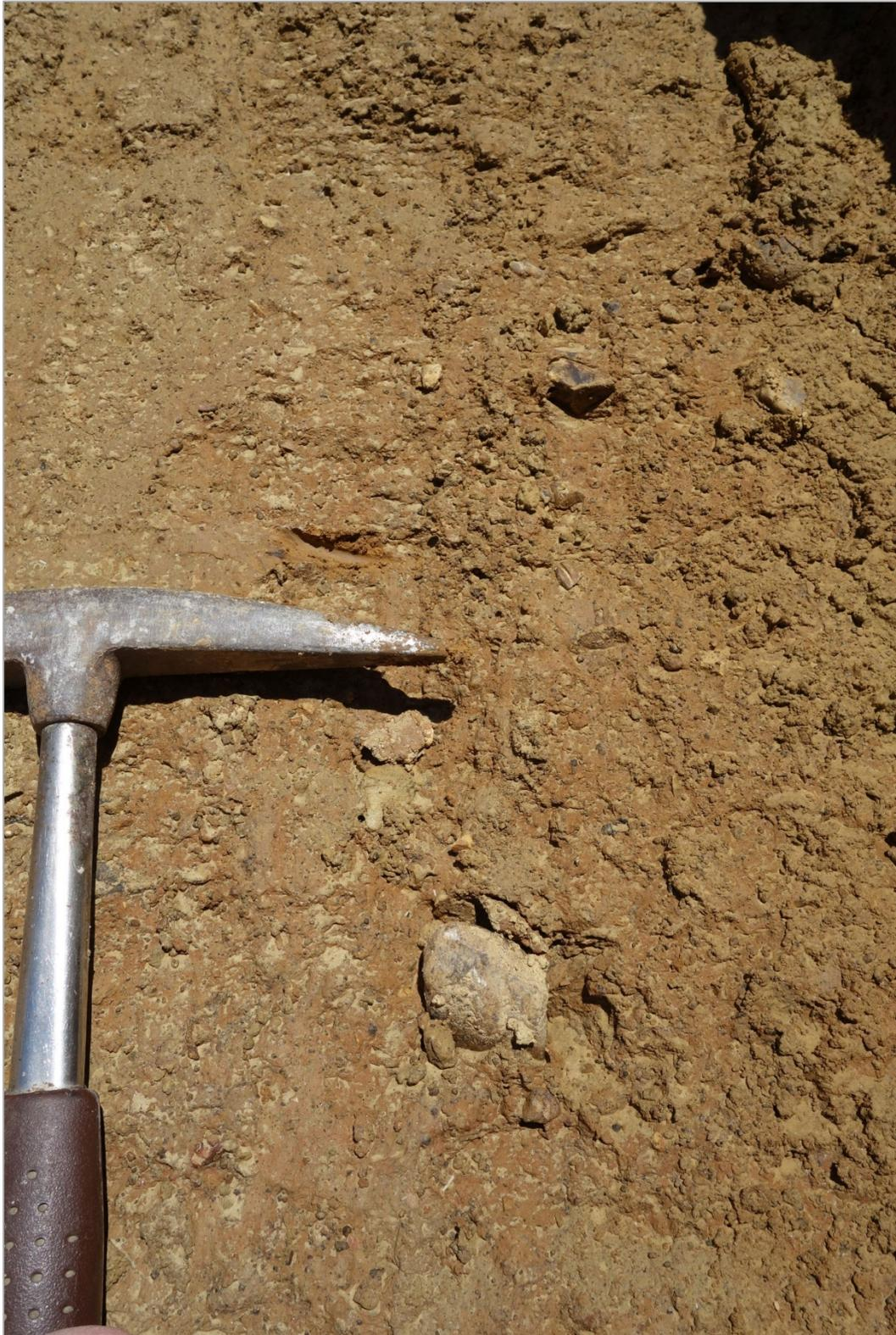
Abb. 2.3.1.15: Baugrube in Dietach: Detailaufnahme des rötlichen Paläobodens mit schlecht sortiertem Komponentenspektrum (H. Peresson).
