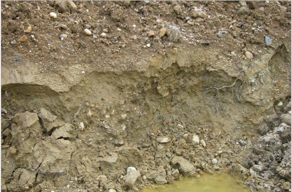
Abb. 2.1.1.34: Hanganschnitt an der A8 südlich von Wallner (Ried im Innkreis): im Liegenden braune bis graue Schluffe und Kiese (Foto: M. Peresson).
