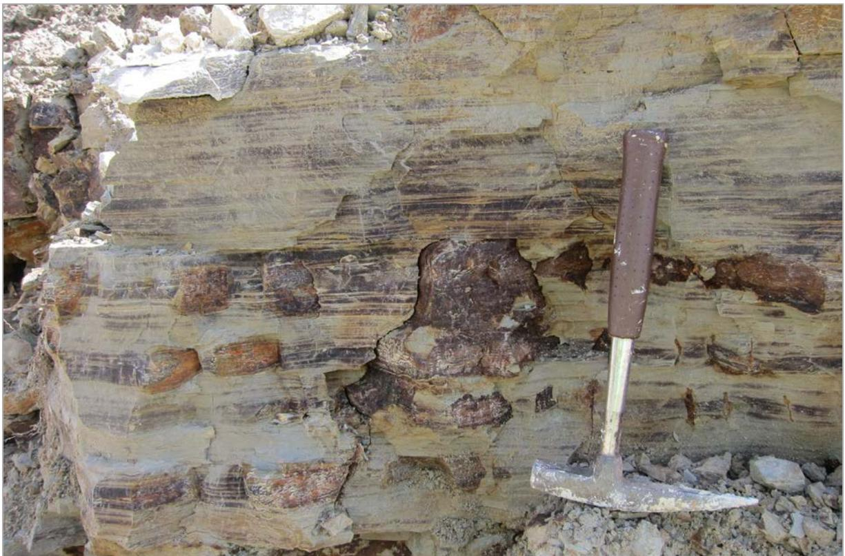
Abb. 2.1.1.48: Hanganschnitt an der A8 im Bereich der Gemeinde Rabenberg; deutliche Lamination von Siltstein/Tonsteinlagen in Ried-Formation erkennbar; rötliche verfärbte, kalzitische Konkretionen („Rundlinge“) (Foto: M. Peresson).
