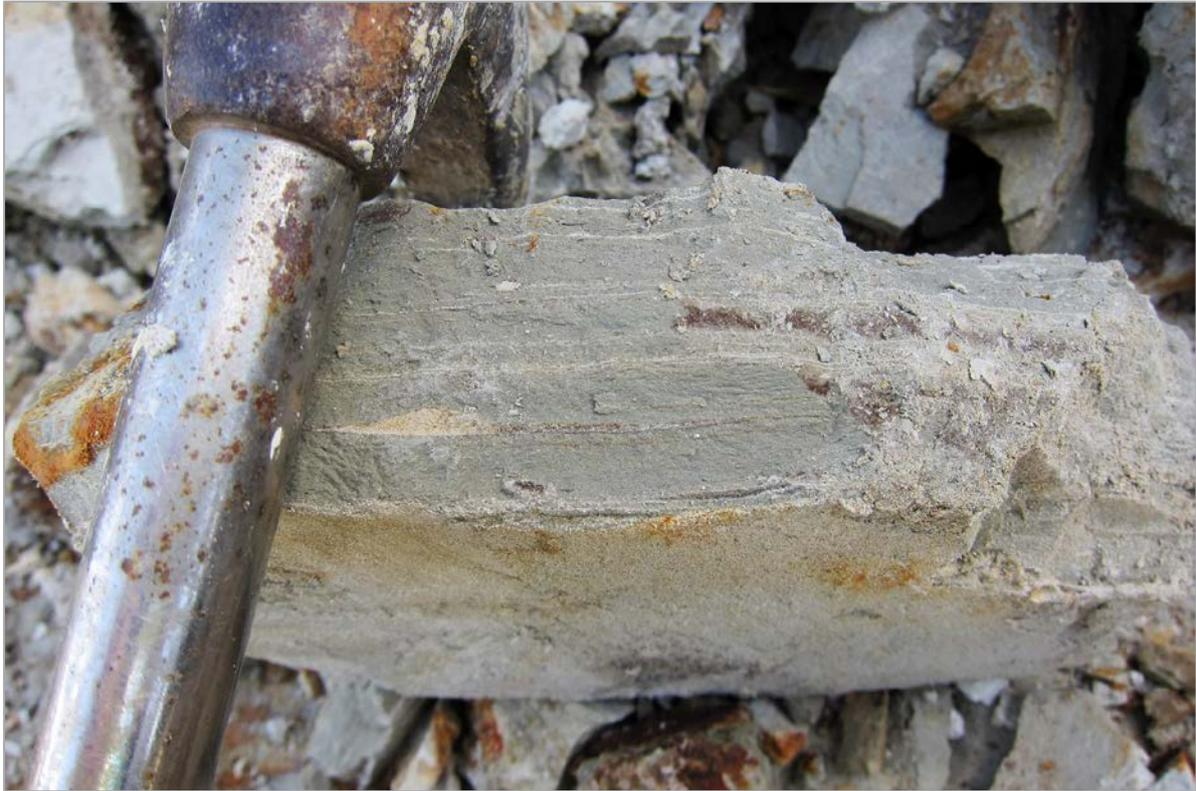
Abb. 2.1.1.51: Hanganschnitt an der A8 im Bereich der Gemeinde Rabenberg; Linsenschichtung innerhalb der Ried-Formation; Feinsandbestege an der Schichtunterseite (Foto: M. Peresson).
