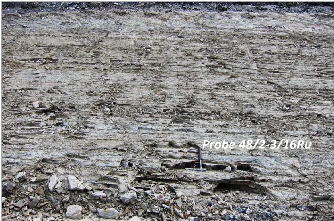
Abb. 2.1.1.60: Hanganschnitt an der A8 im Bereich der Ortschaft Unterprenning; Muster an Setzungsstrukturen (Störungen?) schräg zur Schichtung über den gesamten Aufschluss zu erkennen; Probenahmepunkt: 48/2-3/16Ru (Foto: M. Peresson).
