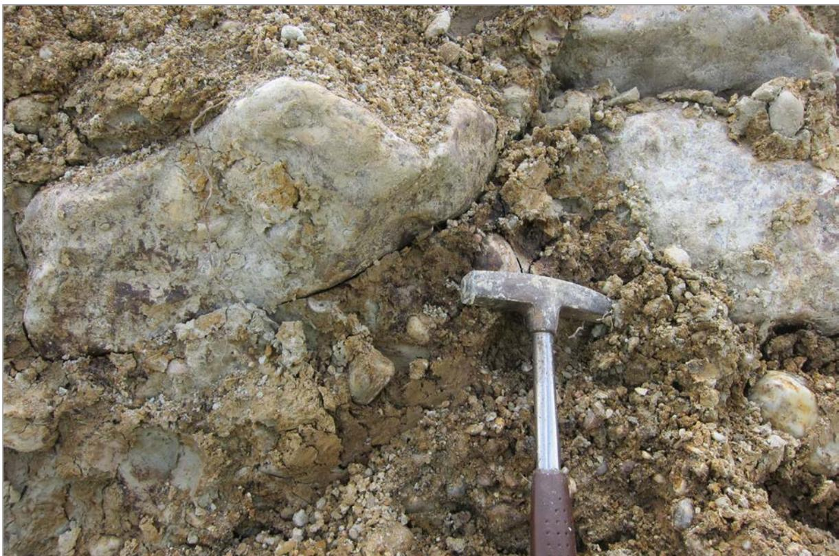
Abb. 2.1.1.26: Hanganschnitt an der A8 südlich von Wallner (Ried im Innkreis): Quarz- bzw. Quarzitkonglomerat-Blöcke (umgelagerte Pramquellen-Bank) (Foto: M. Peresson).
