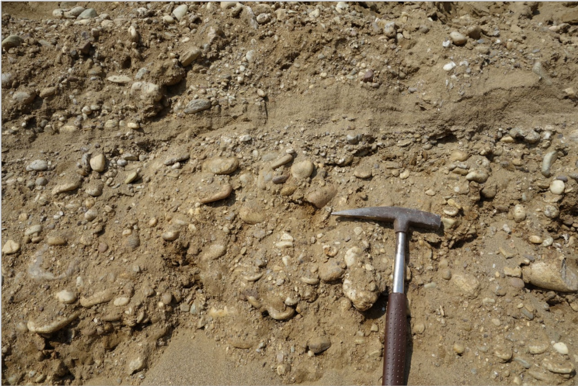
Abb. 2.1.2.40: Umfahrung Lambach-Nord- Aufschlusspunkt 3, Tunnelportal Ost: Einschaltung von Sandlagen innerhalb der „Älteren Deckenschotter“ (Foto: H. Peresson).
