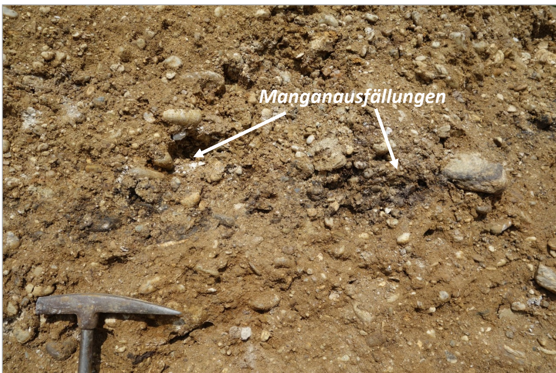
Abb. 2.1.2.39: Umfahrung Lambach-Nord- Aufschlusspunkt 3, Tunnelportal Ost: Manganausfällungen in den „Älteren Deckenschottern“ (Foto: H. Peresson).
