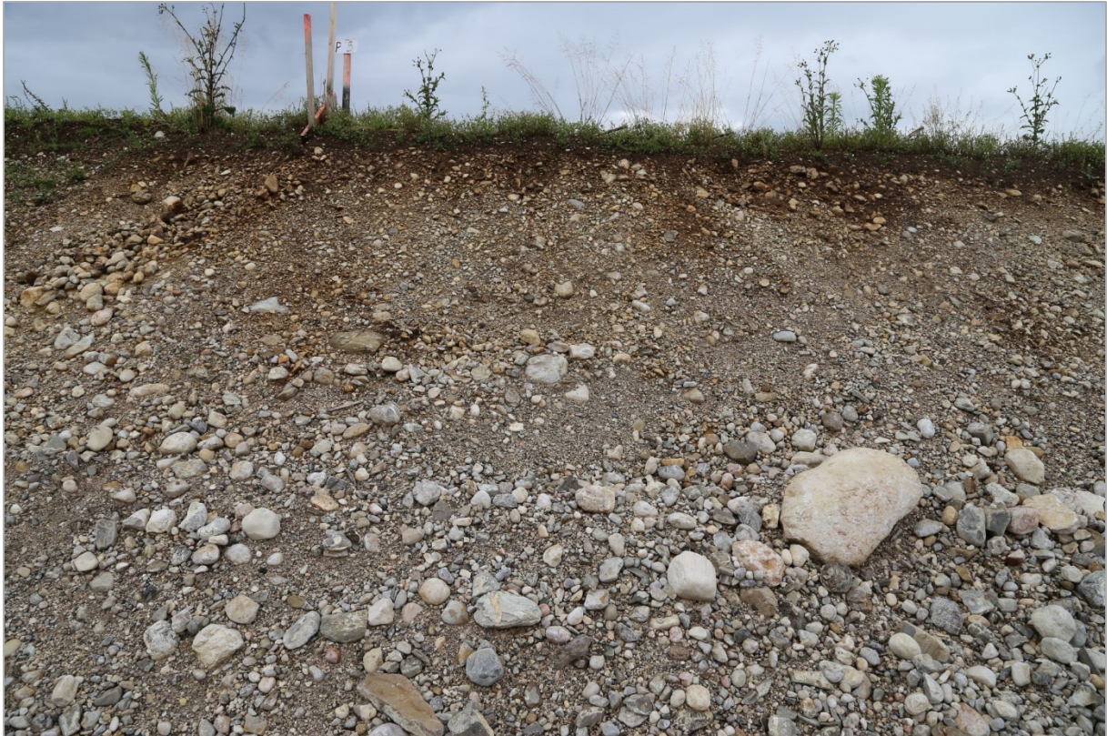
Abb. 2.2.1.13: Umfahrung Gmunden-Ost, Aufschlusspunkt 1: Kiese der Terrasse des zentralen Abflusses; im Hangenden Hinweis auf Kryoturbation; aufgenommen Juni 2014 (Foto: I. Wimmer-Frey).
