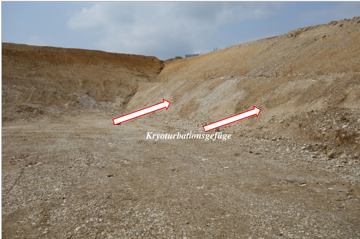
Abb. 2.1.2.14: Umfahrung Lambach-Nord- Aufschlusspunkt 1 im Bereich Breitenberg (Überführung Schlinkerleitenstraße): „Ältere Deckenschotter“ mit Kryoturbationsgefüge (Foto: H. Peresson).
