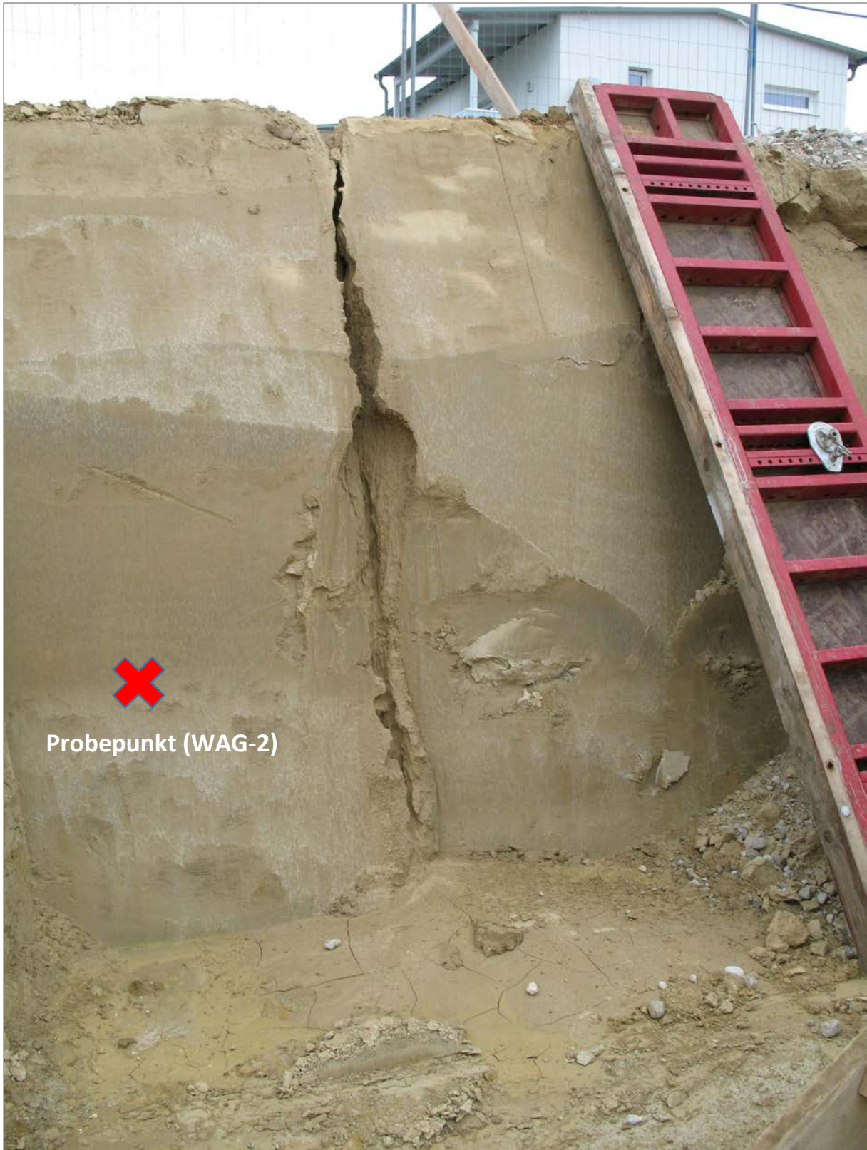
Abb. 2.1.4.17: Detailansicht der Aufschlusswand in Leonding an der Nordseite der Baustelle mit Probenahmepunkt (WAG-2) in gelblichbraunem, ungeschichtetem Löss (Foto: Ch. Rupp).
