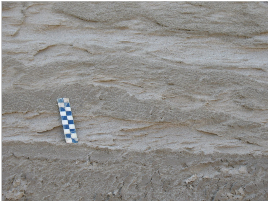
Abb. 2.1.3.9: Südwand des Bauplatzes in Schönering: Intern schräggeschichtete Rippel (Foto: Ch. Rupp).
