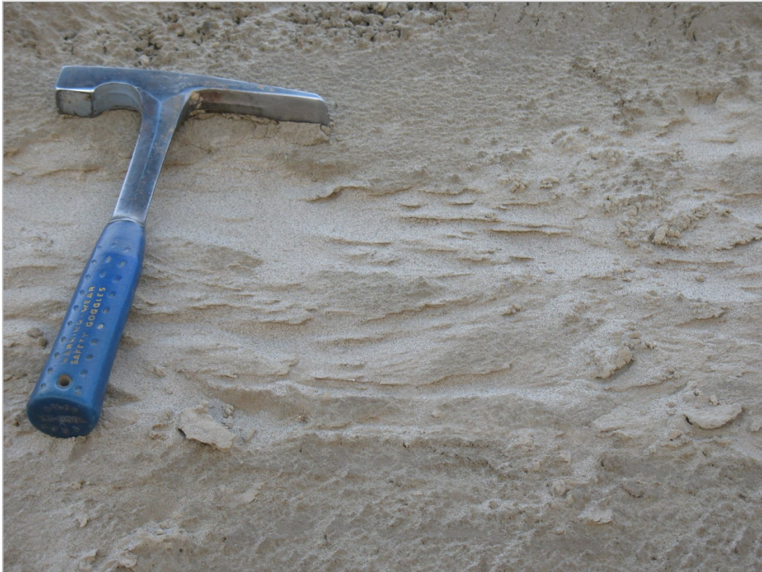
Abb. 2.1.3.8: Südwand des Bauplatzes in Schönering: Rippel- und Flaserschichtung in den Feinsandlagen (Foto: Ch. Rupp).
