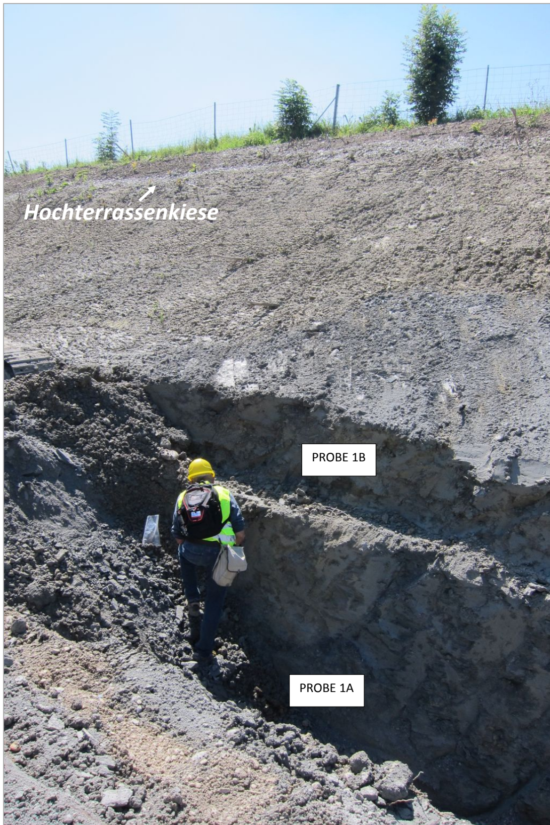
Abb. 2.1.1.10: Hanganschnitt an der A8 nördlich von Haag am Hausruck: Dunkelgraue, rhythmisch gebankte Ottnang-Formation; Probenahmepunkt (Foto: M. Peresson).
