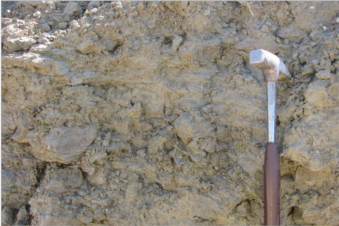
Abb. 2.1.1.31: Hanganschnitt an der A8 bei Buch: Detailfoto der gebankte Ottnang-Formation (Foto: M. Peresson).
