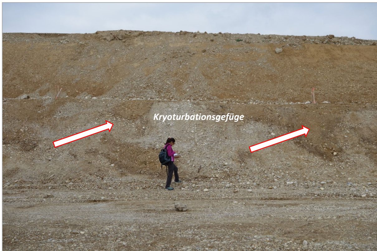
Abb. 2.1.2.12: Umfahrung Lambach-Nord- Aufschlusspunkt 1 im Bereich Breitenberg (Überführung Schlinkerleitenstraße): Knapp 7 m mächtige „Ältere Deckenschotter“ mit Paläobodenhorizont am Top (Foto: H. Peresson).
