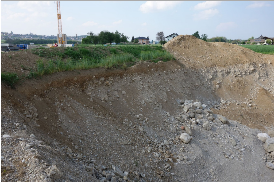
Abb. 2.2.1.21: Umfahrung Gmunden-Ost, Aufschlusspunkt 2b, E der Bahn: Kalk- und Sandsteinblöcke der verschwemmten Grundmoräne (Riss); aufgenommen Mai 2014 (Foto: M. Peresson).
