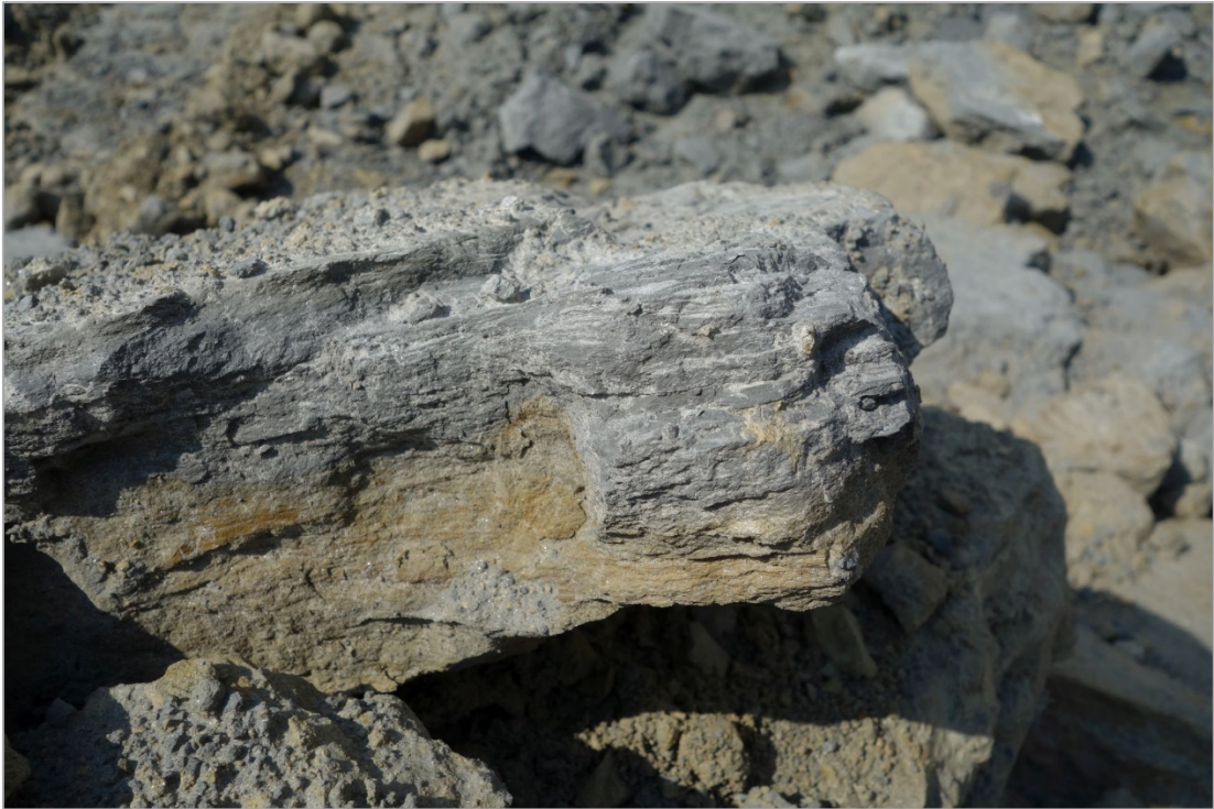
Abb. 2.1.2.44: Umfahrung Lambach-Nord- Aufschlusspunkt 3, Tunnelportal Ost: Wellig bis eben laminierte Pelite der „Vöckla-Formation“ (Foto: H. Peresson).
