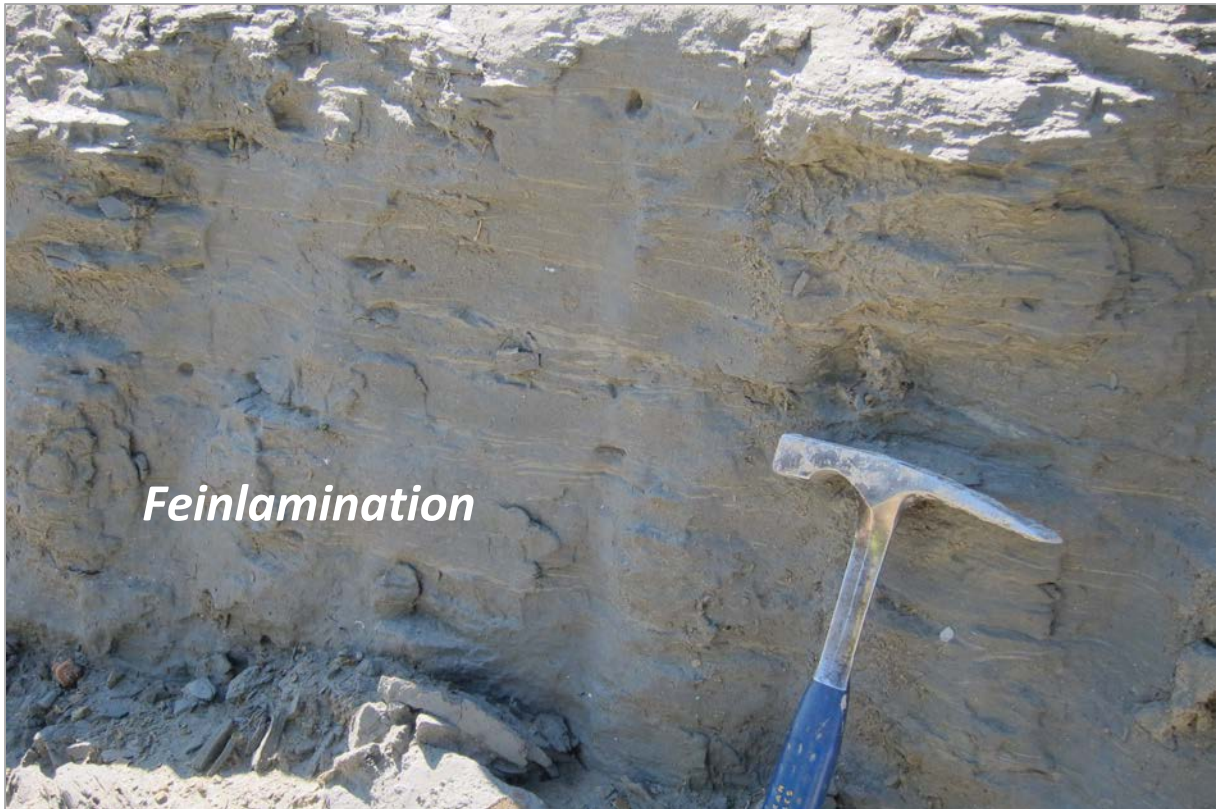
Abb. 2.1.1.13: Hanganschnitt an der A8 nördlich von Haag am Hausruck: Feinlamination und Linsenschichtung der Ottnang-Formation innerhalb der tonreichen Fazies (Foto: M. Peresson).
