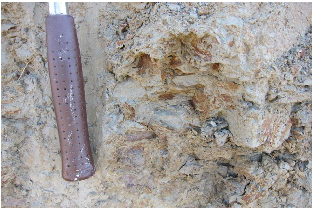
Abb. 2.1.1.16: Hanganschnitt an der A8 bei Niedernhaag - Detailfoto: Rötlich-braun verwitterte Ottngang-Formation; Bankung aufgrund tektonischer Beanspruchung nur mehr undeutlich erkennbar (Foto: M. Peresson).
