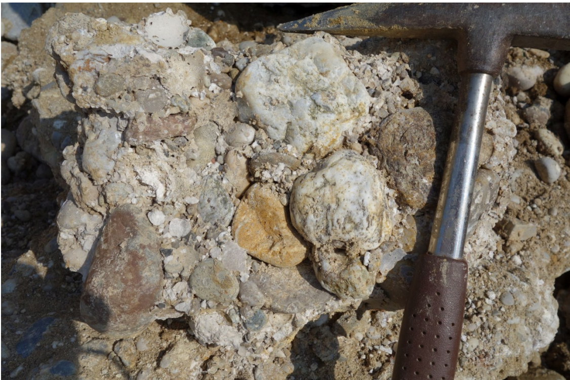
Abb. 2.1.2.41: Umfahrung Lambach-Nord- Aufschlusspunkt 3, Tunnelportal Ost: Karbonatisch zementierte bunte Kalkgerölle innerhalb der „Älteren Deckenschotter“ (Foto: H. Peresson).
