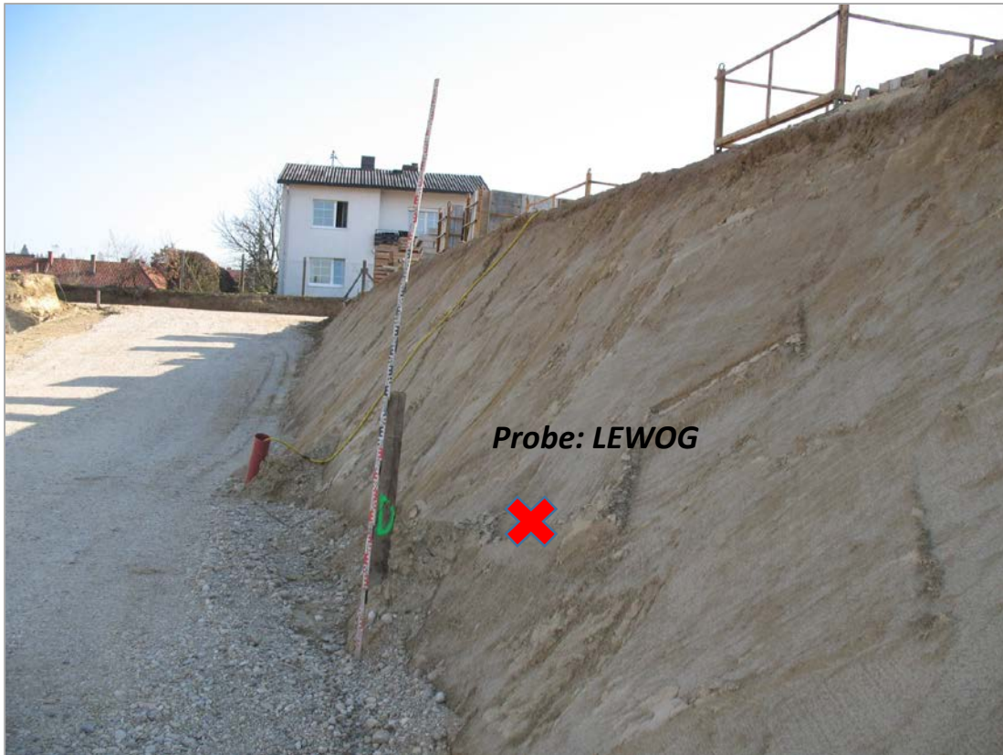
Abb. 2.1.4.9: Aufschlusswand im SE Bereich des Baustellengeländes in Leonding: 2,5 m Aufschlusswand aus strukturlosem, gelblichbraunem Löss mit markiertem Probenahmepunkt (Foto Ch. Rupp).
