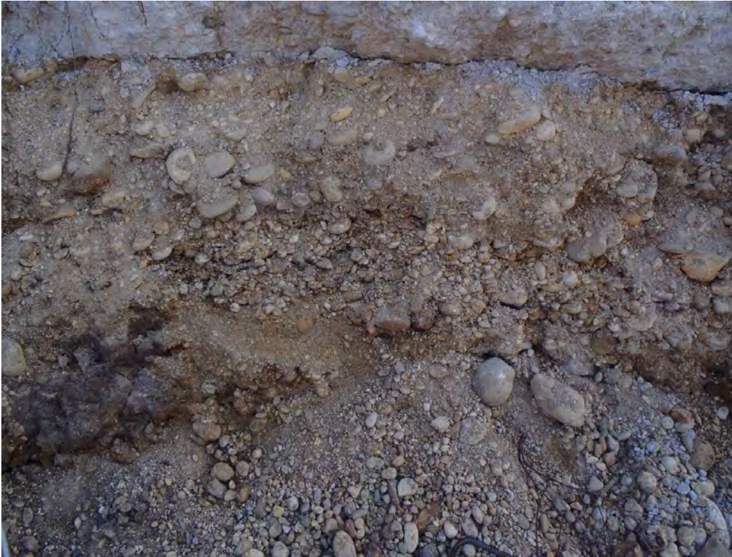
Abb. 2.3.4.11.: „Baustelle in Traun, Graumannviertel“: Profil 1 – Überwiegend karbonatische Grob- bis Mittelkiese der Austufe; Rollkieslagen; schwarz verfarbte Komponenten (Foto: Ch. Benold).
