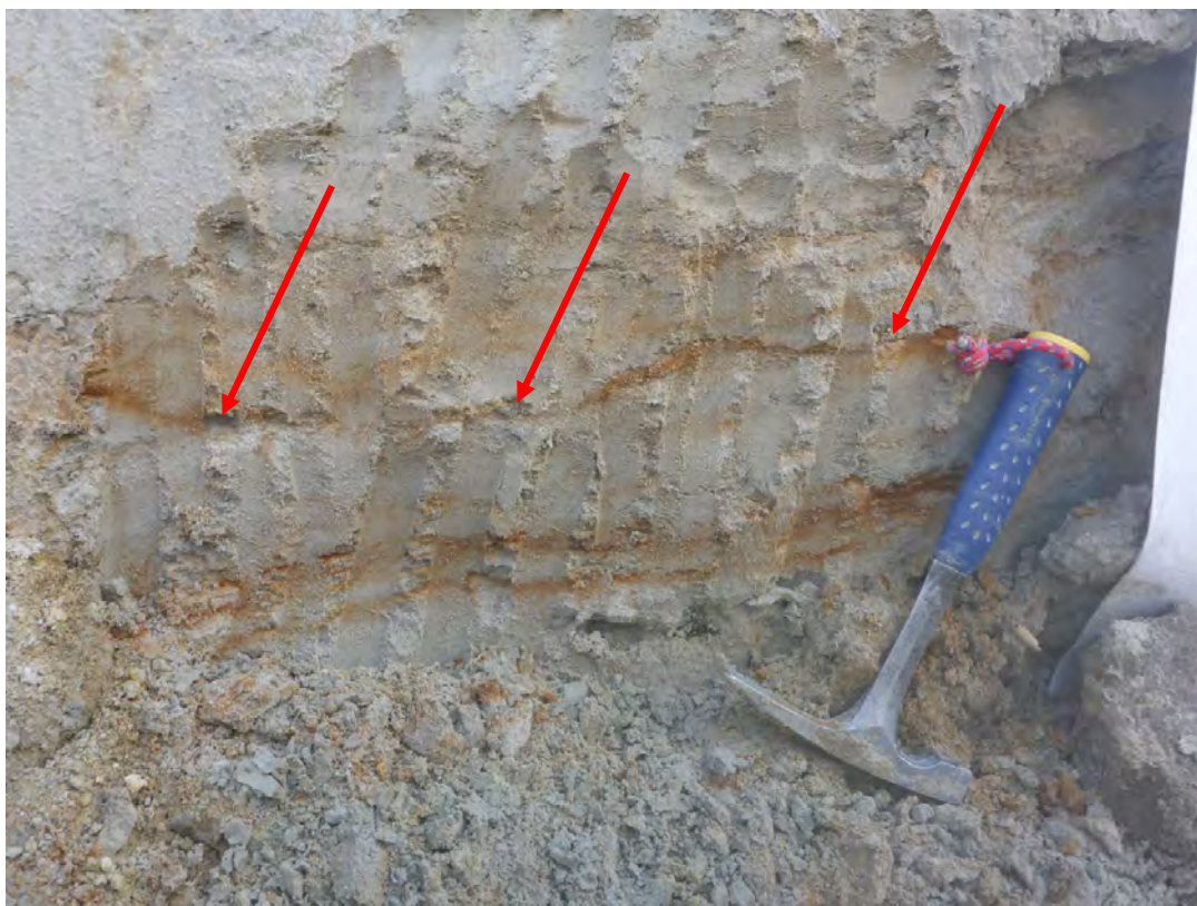
Abb. 2.3.3.9.: Südwand des Bauplatzes in Straßham: Graue Überflutungssedimente mit Pelitklasten, siehe Pfeile (Foto: F. Hofmayer)
