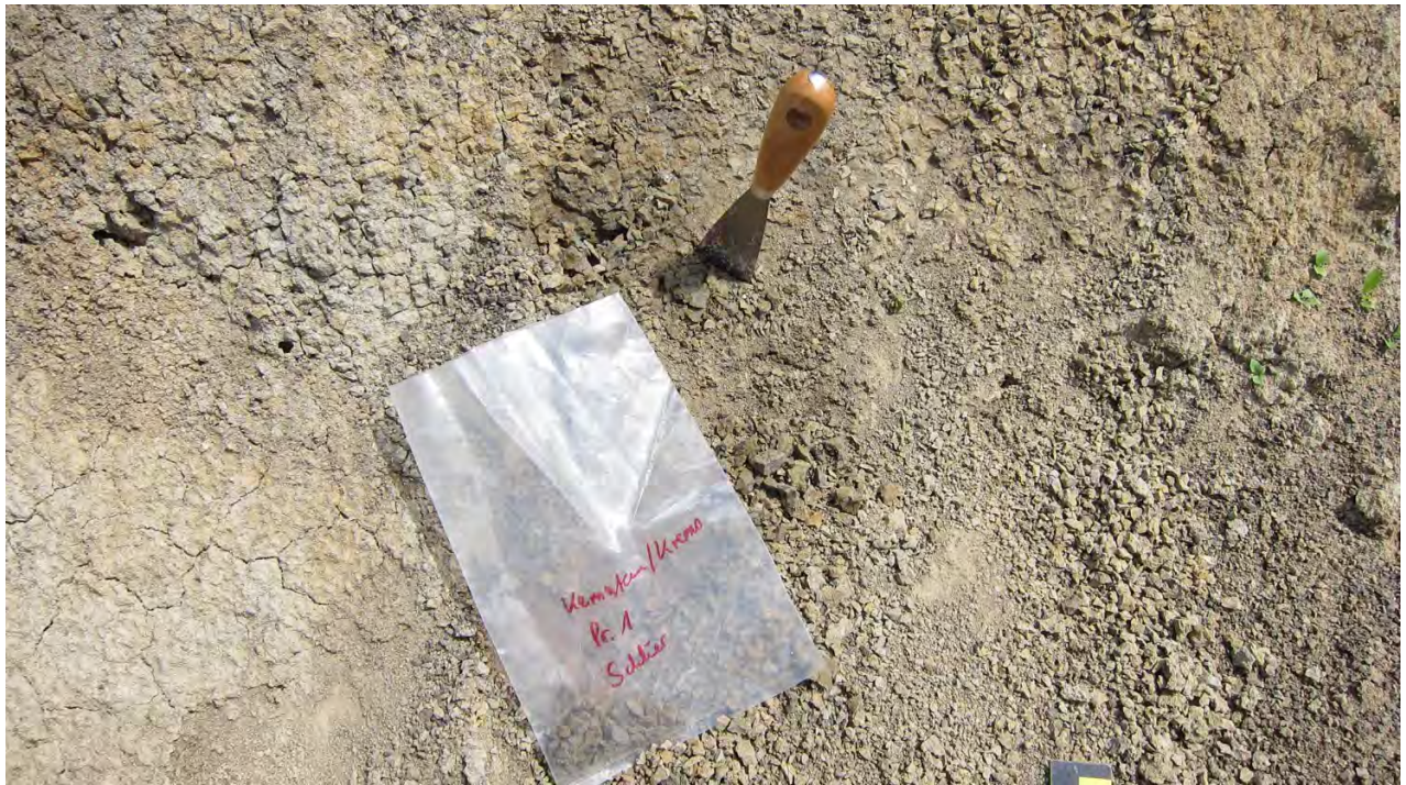
Abb. 2.2.2.13.: „Baulos Wohnhausanlage in Kematen an der Krems“: Probenahmepunkt innerhalb der Schliersedimente ca. 80cm im Hangenden der Basis (Foto: M. Peresson).
