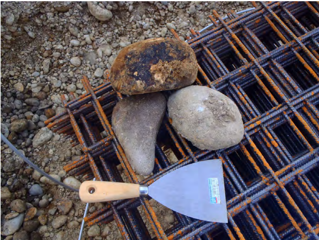
Abb. 2.3.4.12.: „Baustelle in Traun, Graumannviertel“: Profil 1 – Vereinzelt Auftreten von Steinen innerhalb der Kiese der Austufe (Foto: Ch. Benold).
