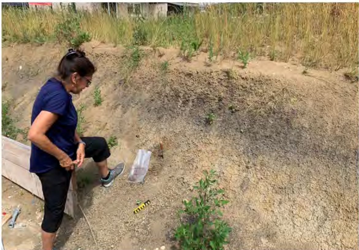
Abb. 2.2.2.11.: „Baulos Wohnhausanlage in Kematen an der Krems“: hellgrauer Schluffsteine mit rötlichen Oxidationsverfärbungen an der Oberfläche (Robulus-Schlier?) (Foto: M. Peresson).
