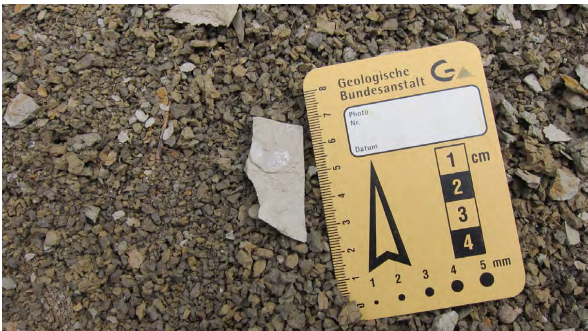
Abb. 2.2.1.20.: „Baulos Wohnhausanlage in Ansfelden am Hochfeld“: Innerhalb der gebankten Sedimente des „Älteren Schlier“ konnten an den Schichtflächen auch Muschelreste (weiß) beobachtet werden (Foto: M. Peresson).
