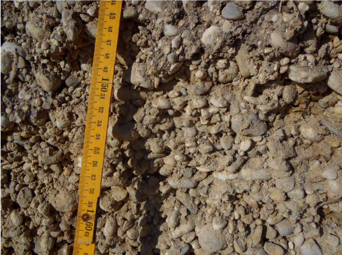
Abb. 2.3.4.15.: „Baustelle in Traun, Graumannviertel“: Profil 2 – schlecht sortierte Grob- bis Mittelkiese in sandiger Matrix (Austufe) (Foto: Ch. Benold).
