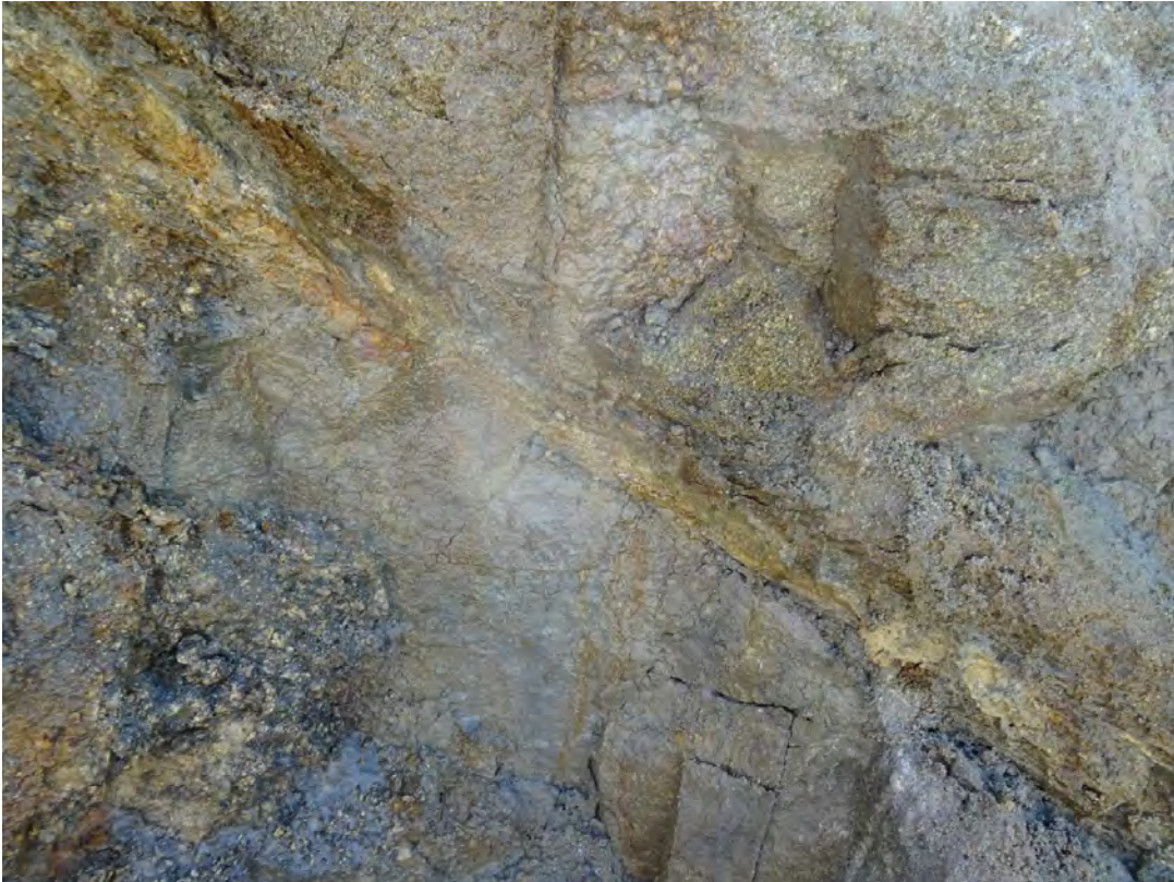
Abb. 2.1.1.9.: „Baugrube in Pröselsdorf, Hauswies“: Störungszone im Weinsberger Granit mit Quarzanreicherung (Foto: G. Griesmeier).
