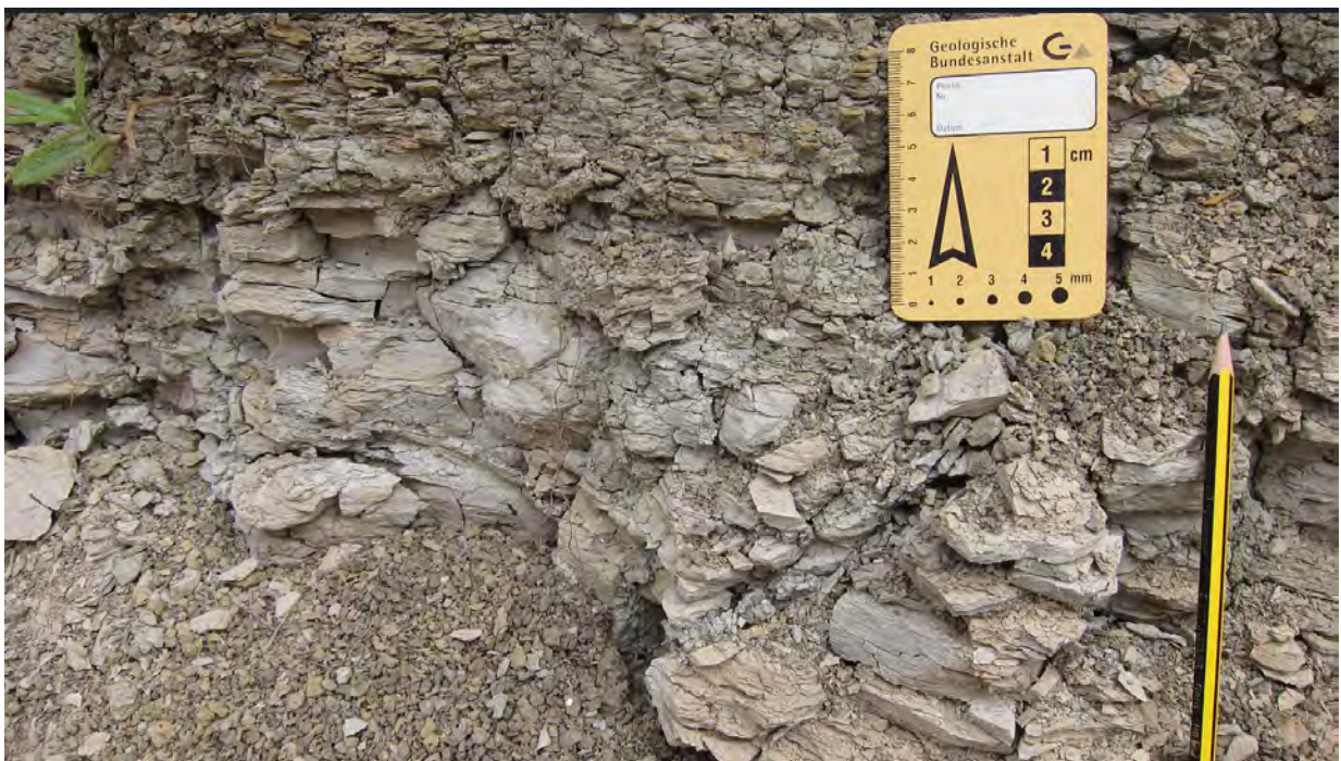
Abb. 2.2.1.14.: „Baulos Wohnhausanlage in Ansfelden am Hochfeld“: Detailaufnahme der hellgraue im dm-Bereich gebankten Sedimente („Älteren Schlier“) (Foto: M. Peresson).
