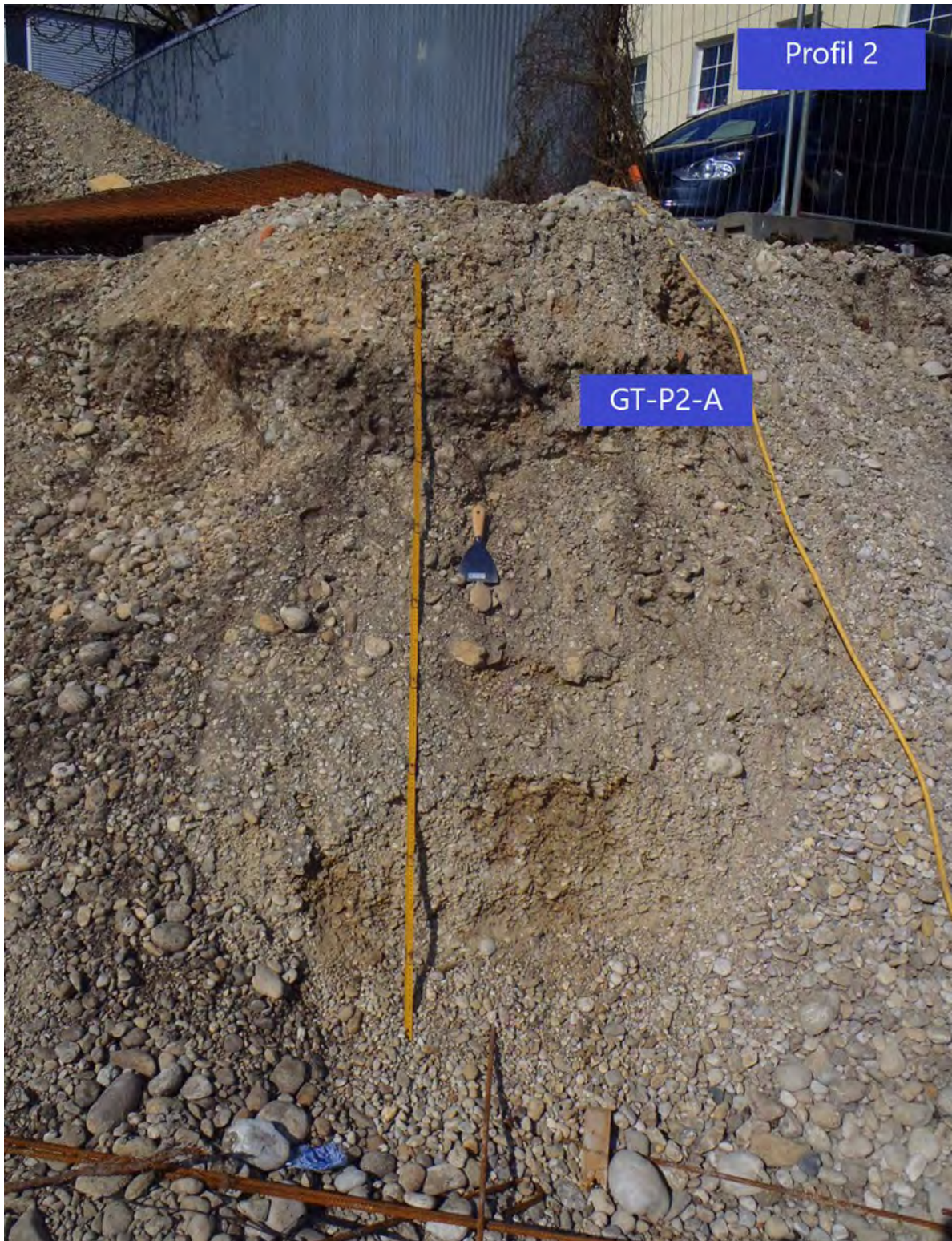
Abb. 2.3.4.13.: „Baustelle in Traun, Graumannviertel“: Profil 2 – Schlecht sortierte Grob- bis Mittelkiese der Austufe; vereinzelt Einschaltungen von Steinen; (Foto: Ch. Benold).
