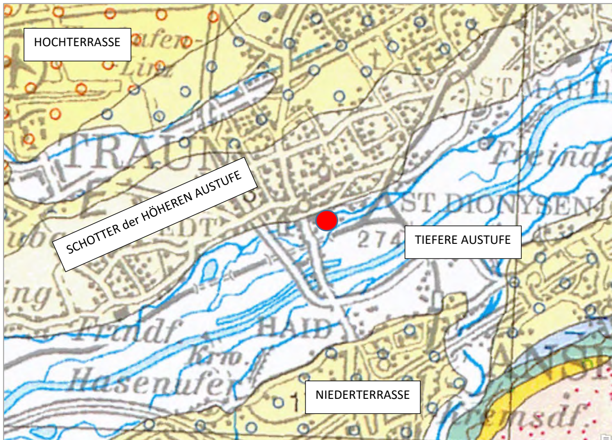
Abb. 2.3.4.5.: Ausschnitt aus der geologischen Karte 1:200.000, Oberösterreich (Krenmayr & Schnabel, 2006) mit Lage der Baustelle (roter Kreis).
