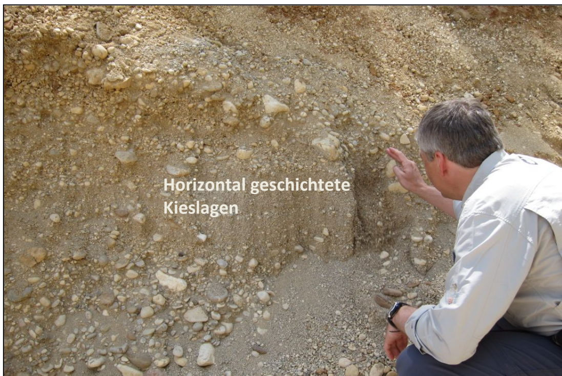
Abb. 2.3.1.9: Detailfoto der Hochterrassekiese; schlecht sortierte, angerundete, vorwiegend kalkalpine Komponenten (Foto: M. Peresson)
