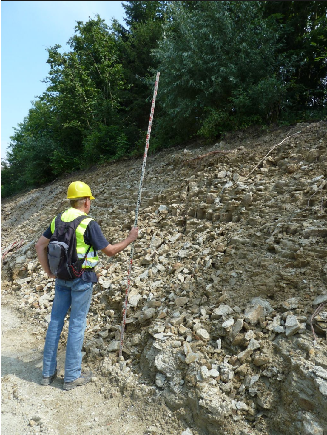
Abb. 2.2.1.26: Rhythmisch gebankte Ottnang-Formation südlich Thalheim: östlicher Abschnitt des knapp 150 m langen Aufschlusses ist stärker tektonisch beansprucht (Foto: M. Peresson)
