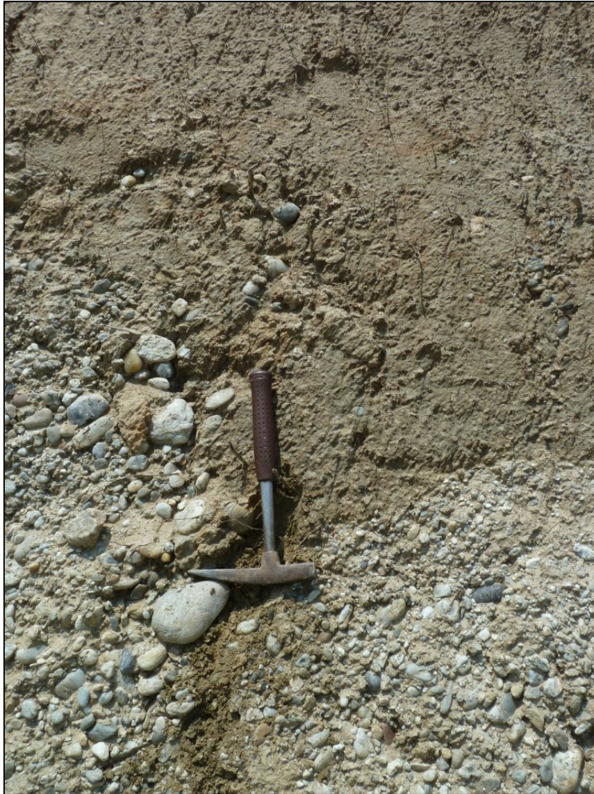
Abb.2.2.1.7: Detailaufnahme von Terrassenkiesen an der A8 südlich von Weibern; stark verwurzelter Löss-Lehm im Hangenden, schlecht sortierte Hochterrassenschotter im Liegenden (Foto: M. Peresson).
