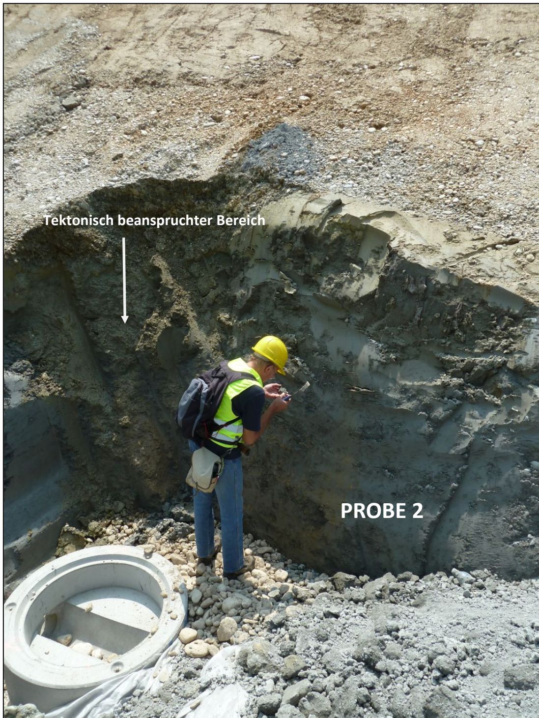
Abb. 2.2.1.10: Markante Grenze zwischen Terrassenschottern und Ottnang-Formation an der A8 südlich von Weibern (Foto: M. Peresson).
