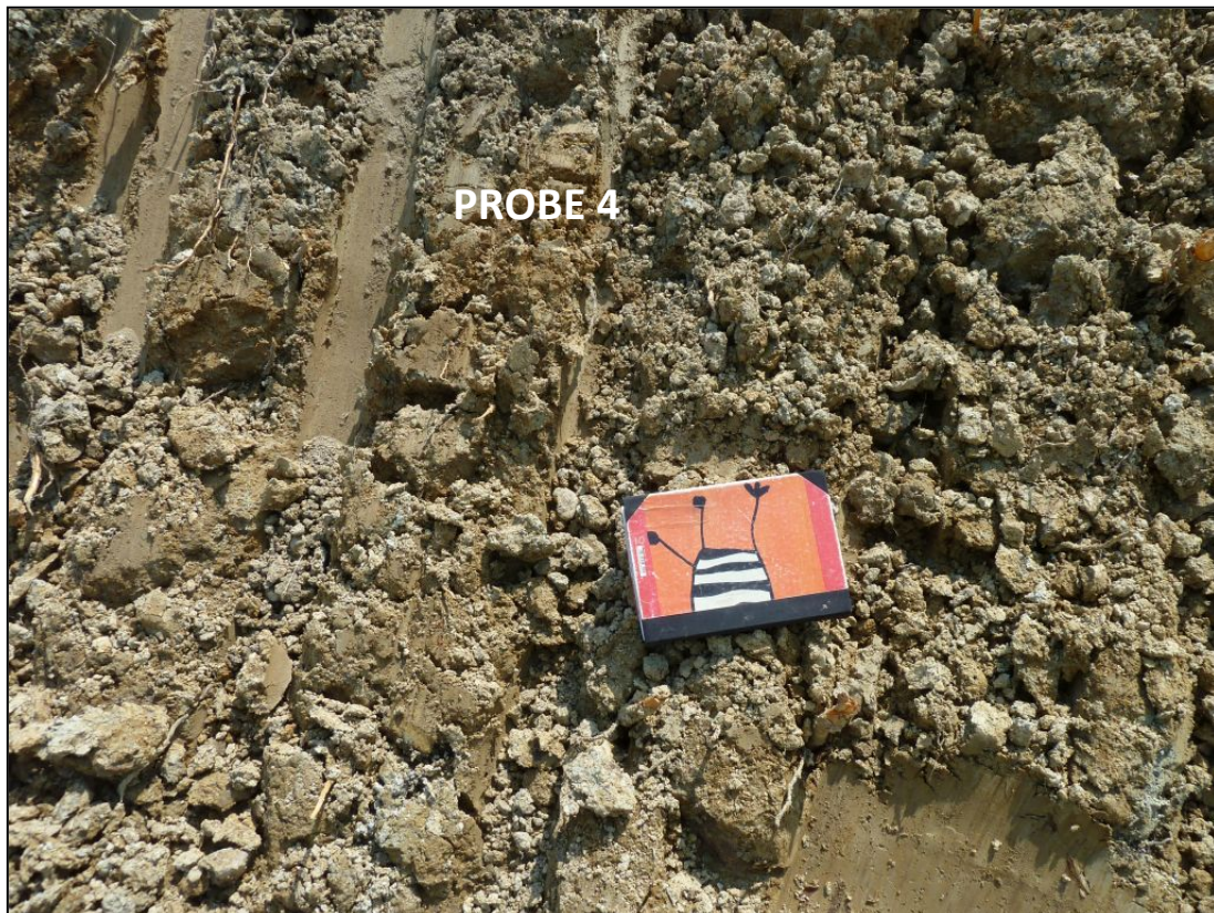
Abb. 2.2.1.14: Detailfoto von stark verwitterter Ottnang-Formation östlich der Ortschaft Auhäuseln an der A8 (Foto: M. Peresson).
