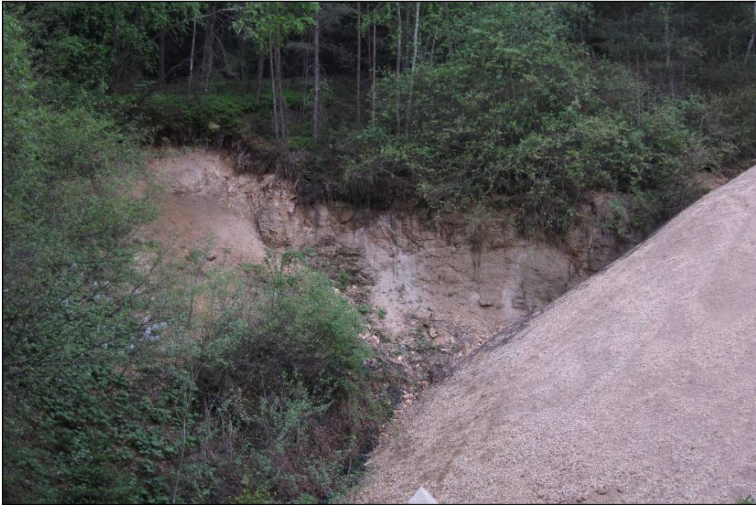
Abb. 2.1.2.16: Abbau 034/150-M im Weinsberger Granit: Stark verwitterte Granitabbauwand, bereits verwachsen; Entnahmestelle für den lokalen Gebrauch (Foto. M. Peresson)
