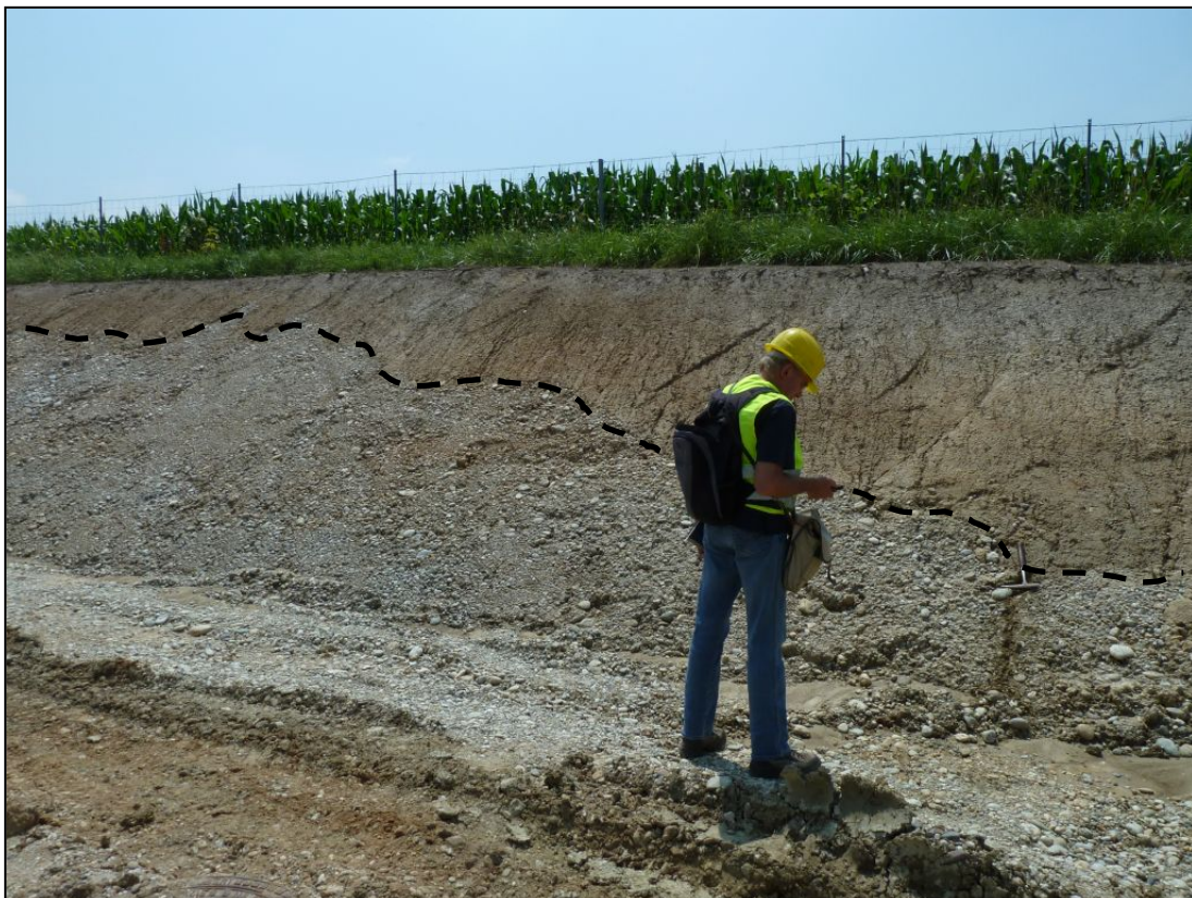
Abb. 2.2.1.6: Hanganschnitt an der A8 südlich von Weibern: Löss-Lehm auf schlecht sortierten Hochterrassenkiesen (Kryoturbationsgefüge? Foto: M. Peresson).
