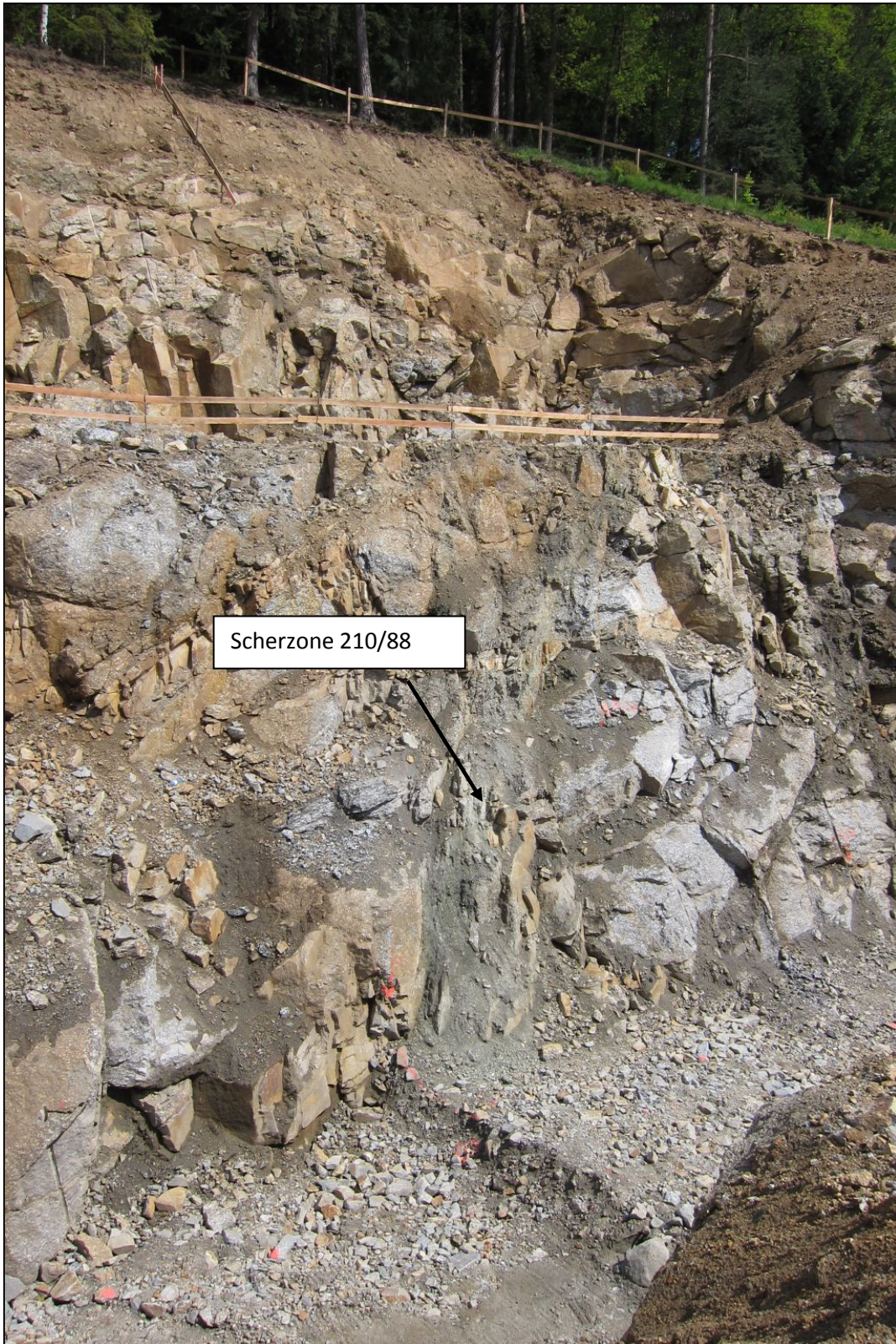
Abb. 2.1.1.18: 1-2 m breite Scherzone, grünlich mylonitisiert (210/88); NW-SE streichend parallel zur Pfahlstörungsrichtung (Foto: M. Peresson).
