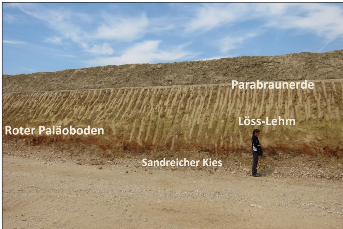
Abb. 2.3.1.20: Kryoturbater roter Paläobodenhorizont im gesamten Grubenbereich erkennbar (Foto: H. Peresson)
