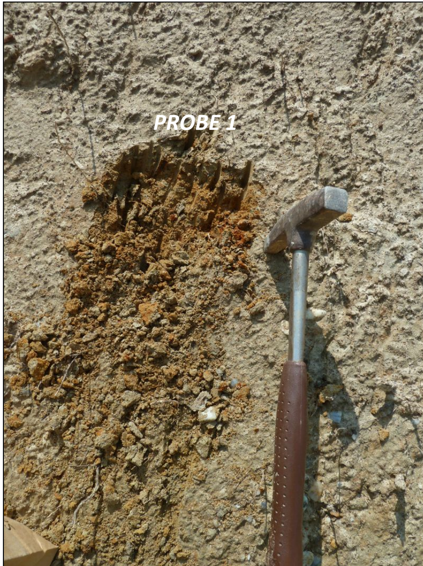
Abb. 2.2.1.8: Detailaufnahme der schluffig-sandigen Deckschicht im Hangenden an der A8 südlich von Weibern: stark verwurzelter Löss-Lehm mit Kieseinstreu (Foto: M. Peresson).
