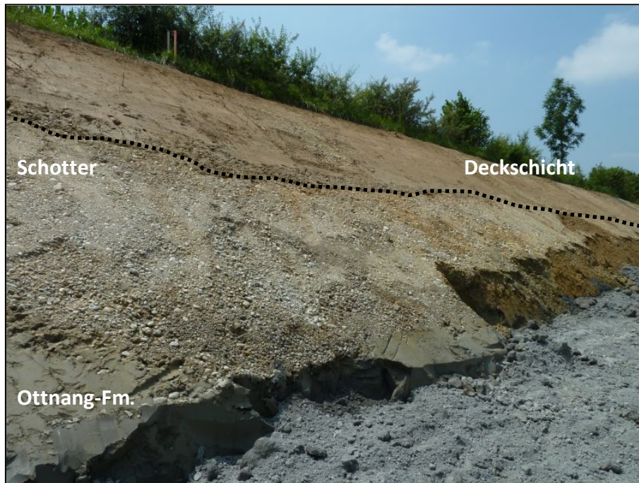
Abb. 2.2.1.9: Deckschicht mit unterlagernden Terrassenschottern im Übergang zur Ottnang-Formation (Foto: M. Peresson).
