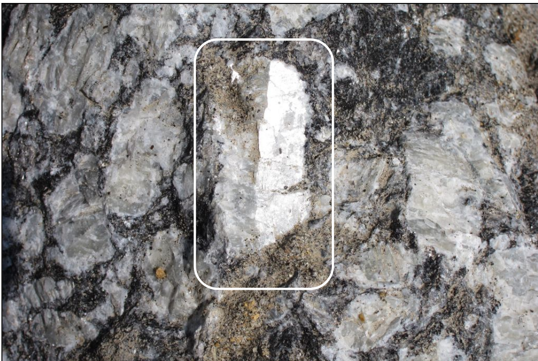
Abb. 2.1.1.14: Im Handstück erkennbar: Karlsbader Zwillingsbildung im Kalifeldspat aus Weinsberger Granit im Bereich Nordportal Tunnel Neumarkt (Foto: M. Peresson).
