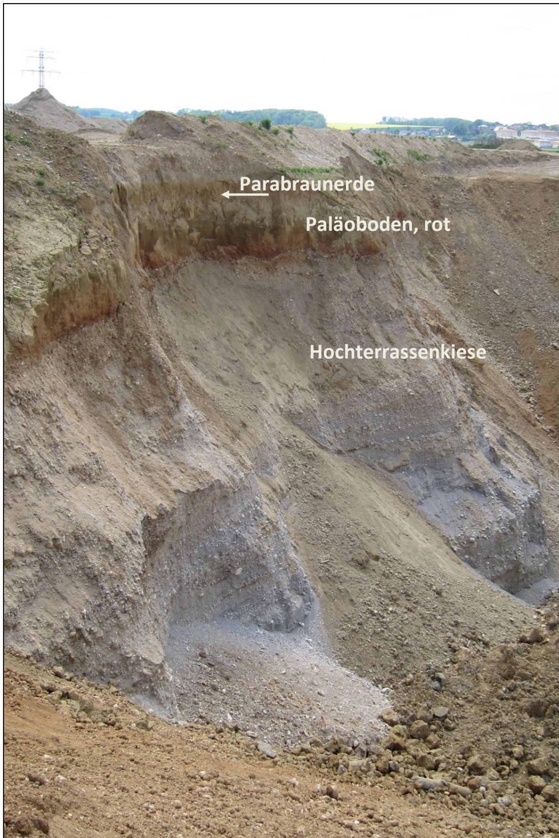
Abb. 2.3.1.32: 20-25 m mächtige Hochterrassenkiese, überlagert von kryoturbatem Paläoboden (rotbraun) und Deckschichten (mit Parabraunerdehorizont) im Hangenden (Foto: M. Peresson)
