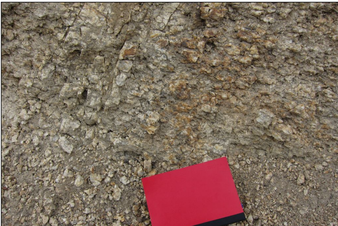
Abb. 2.1.2.10: Detailfoto am Güterweg Pehersdorf: Stark verwitterte Kalifeldspäte im Weinsberger Granit (Foto: M. Peresson).
