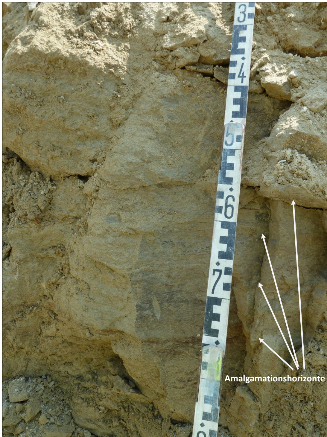
Abb. 2.2.1.19: Detailfoto der im Liegenden amalgamierten Sandsteinbänke aus der Ottnang-Formation südlich der Raststätte Aistersheim (Foto: M. Peresson).
