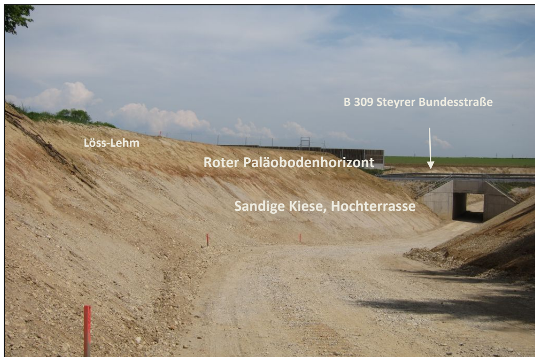
Abb. 2.3.1.7: Überblicksfoto des Aufschlussbereiches an der B 309, Steyrer Bundesstraße im Hintergrund (Foto: M. Peresson)
