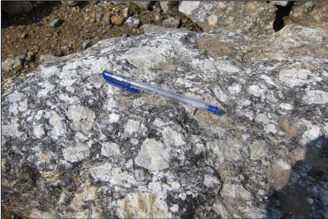
Abb. 2.1.1.13: Handstück aus deformiertem Weinsberger Granit mit großen eingeregeltten, idiomorphen Kalifeldspäten (weiß) im Nordportal des Tunnels Neumarkt (Foto: M. Peresson).
