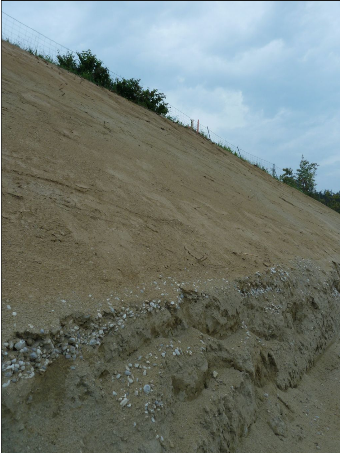
Abb. 2.2.1.29: Sandreiche Atzbach-Formation mit Einschaltung von Kieshorizonten im Liegenden an der A8 Innkreis-Autobahn östlich von Thalheim (Foto: M. Peresson)
