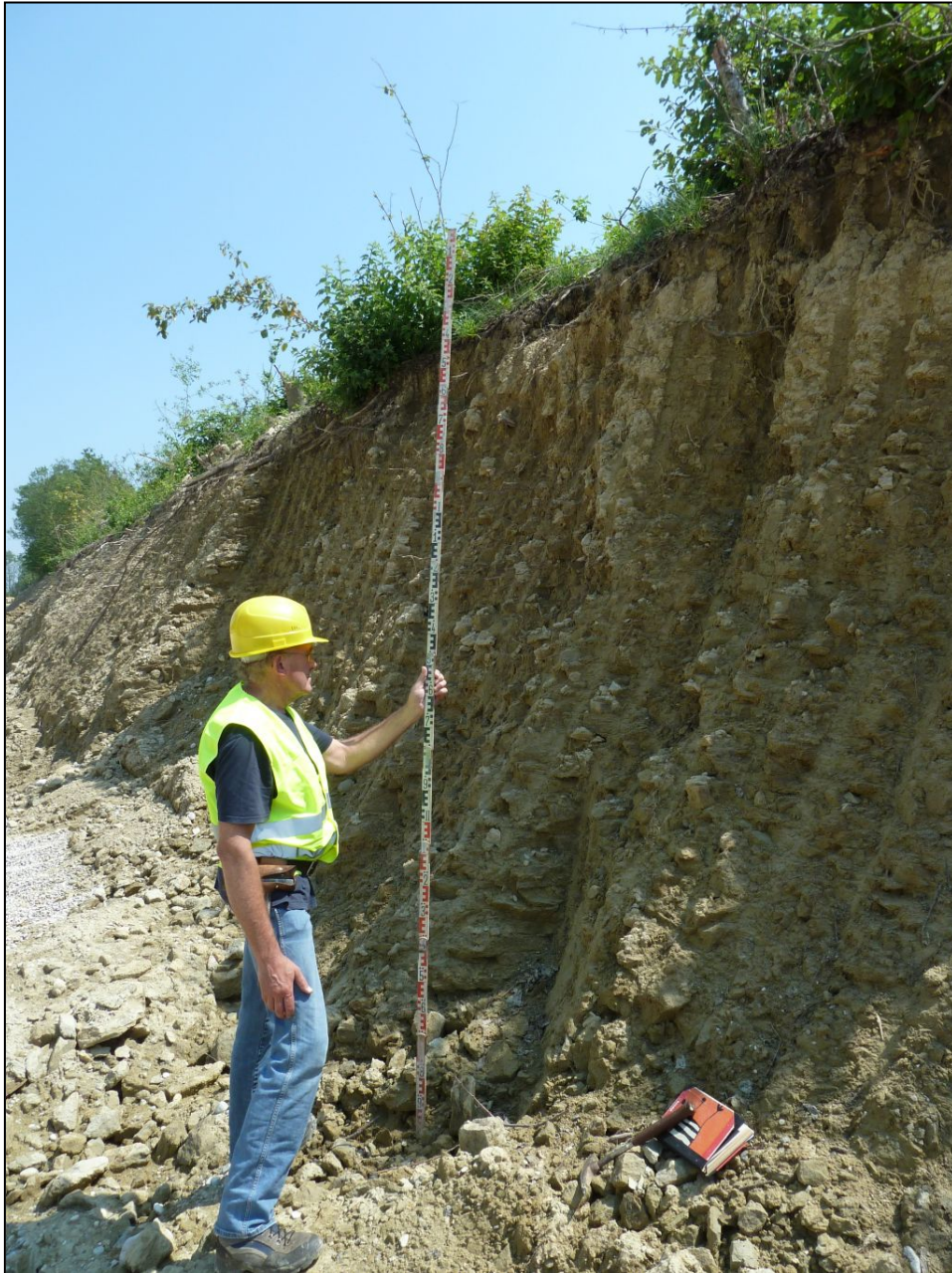
Abb. 2.2.1.15: Einheitlich gebankte, verwitterte Ottnang-Formation südlich der Raststätte Aistersheim an der A8 (Foto: M. Peresson).
