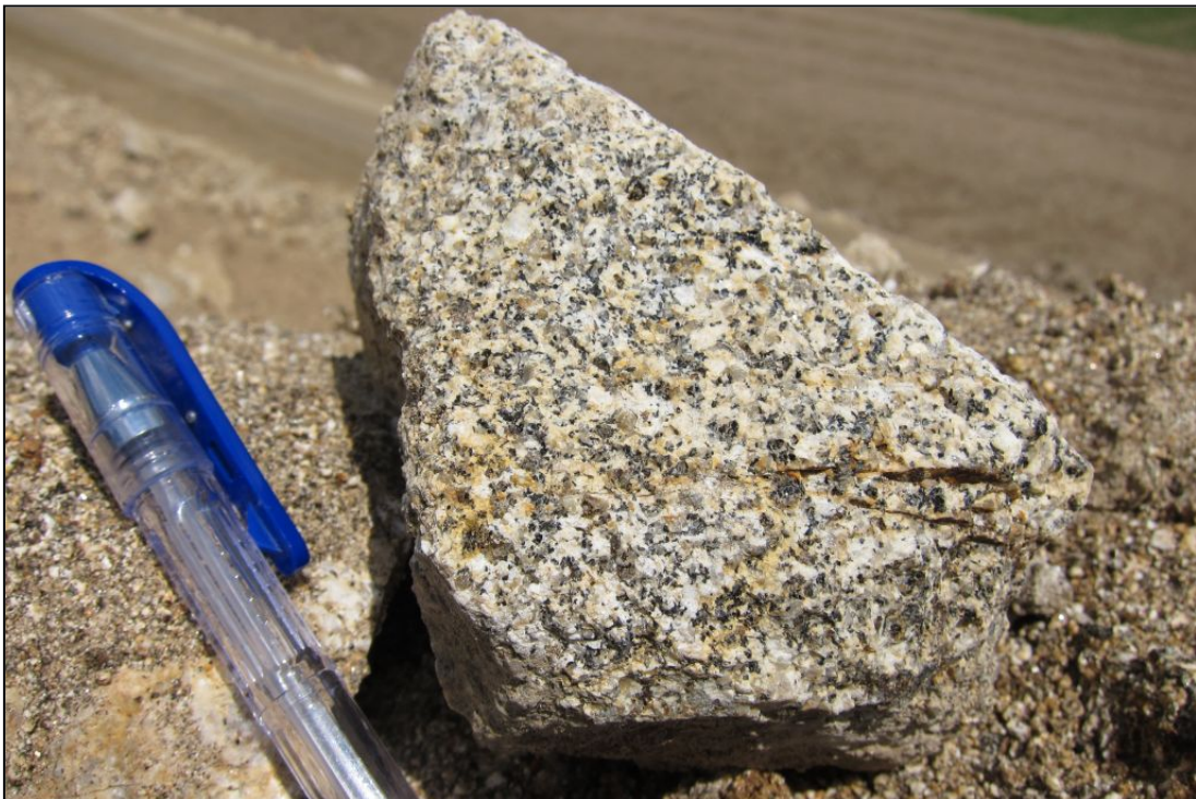
Abb. 2.1.1.5: Zweiglimmergranit mit Biotit (schwarz) und Hellglimmer (grau) vom Typ „Altenberger Granit“ im Bereich des Nordportals des Tunnels Göttschka (Foto: M. Peresson).
