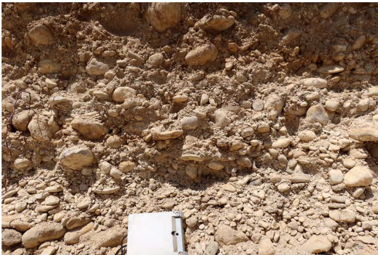
Abb. 2.2.2.9.: Baustellengelände in Wels, Oberhaid: Detailaufnahme der Niederterrassenkiesen mit chaotischen Gefüge (Foto: M. Peresson).
