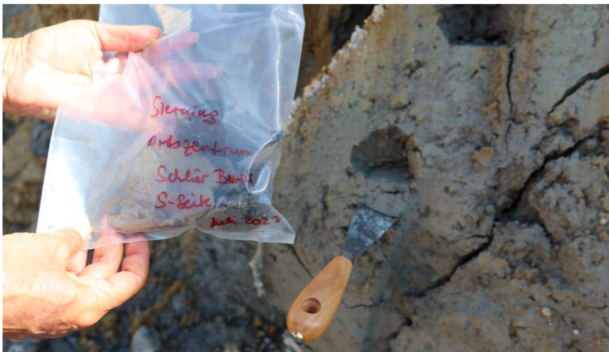
Abb. 2.1.1.17: Baustelle für eine Wohnhausanlage in Sierning: Probenahme im Älteren Schlier (Foto: M. Peresson).
