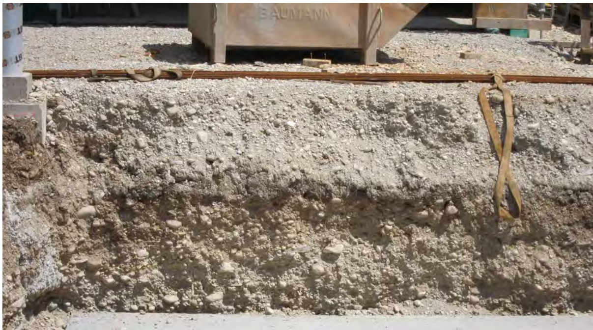
Abb. 2.2.2.8.: Baustellengelände in Wels, Oberhaid: Niederterrassenkiesen mit chaotischen Gefüge (Foto: M. Peresson).
