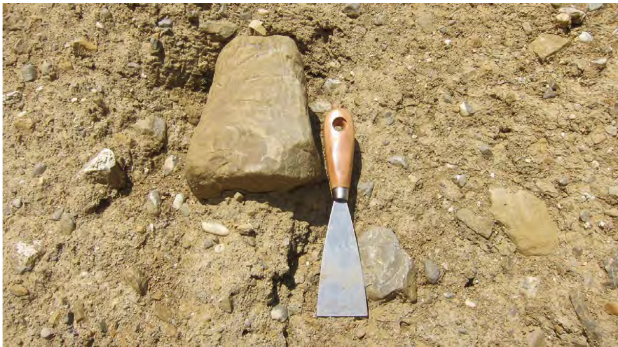
Abb. 2.2.3.16.: Baustelle „Reihenhaussiedlung in Kremsmünster: untere Etage; Moränenmaterial Detailaufnahme Komponentenspektrum „Graue Nagelfluh“ (Foto: M. Peresson).
