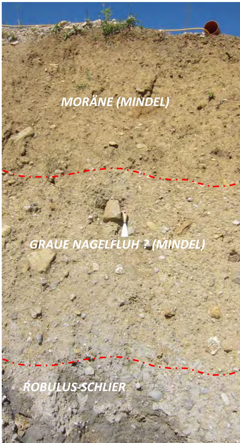
Abb. 2.2.3.15.: Baustelle „Reihenhaussiedlung in Kremsmünster: untere Etage; Moränenmaterial zeigt eine Zweigliederung aufgrund des Farb- und Materialunterschiedes; an der Basis ist Robulus-Schlier aufgeschlossen (Foto: M. Peresson).
