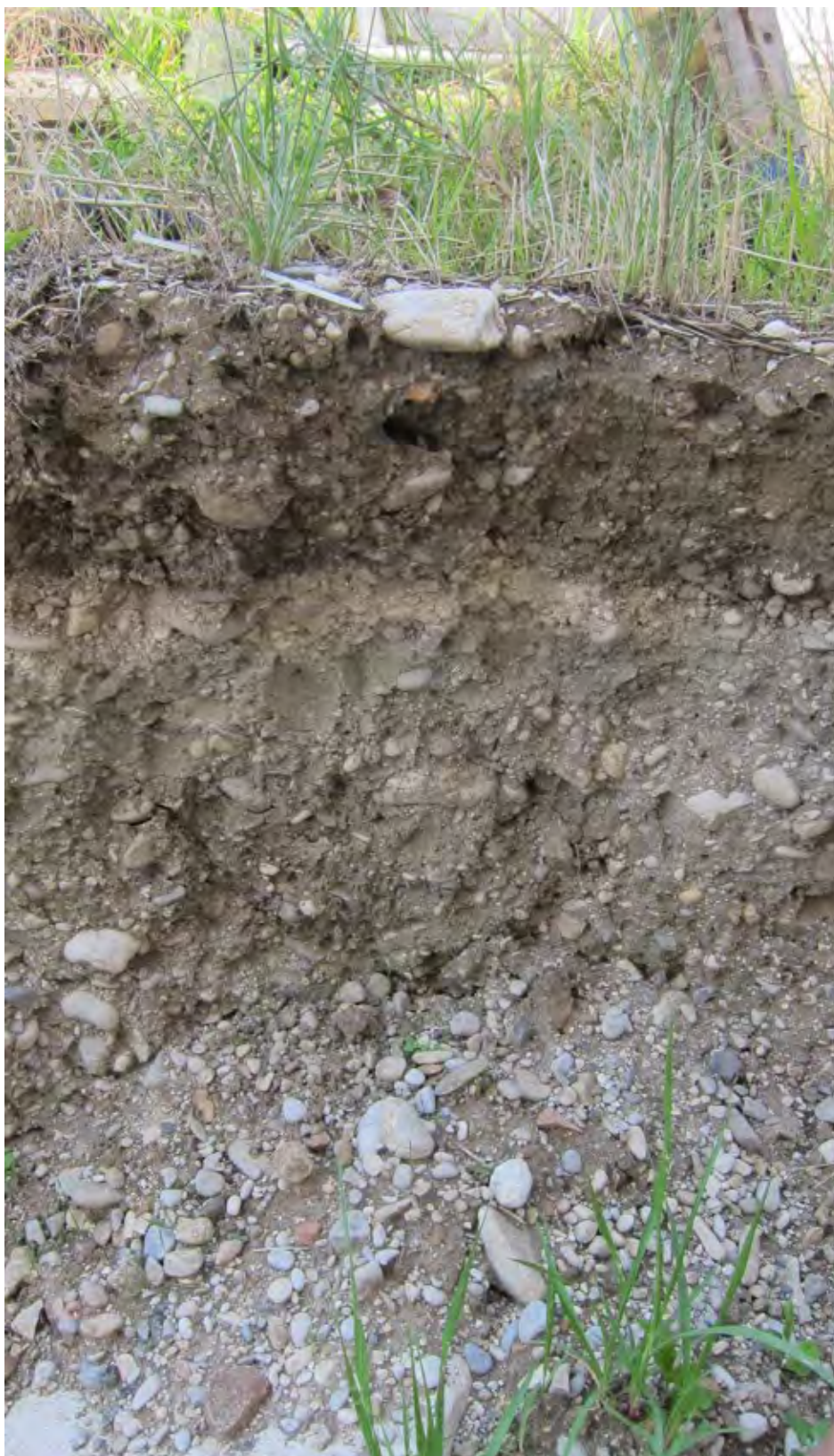
Abb. 2.2.4.23.: Baustelle „Welser Heimatstätte“: am Top ein verlehmtter, dunkelgaruerbrauner Horizont; im Liegenden stark sandige, schlecht sortierte Kiese der Niederterrasse (Foto: M. Peresson).
