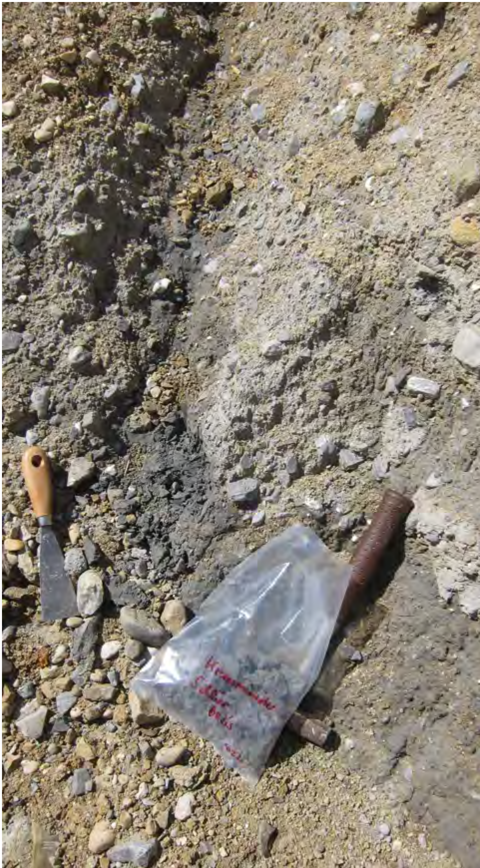
Abb. 2.2.3.18.: Baustelle „Reihenhaussiedlung in Kremsmünster: untere Etage; Detailaufnahme der Schlierbasis, erkennbar sind aufgearbeitete Flyschkomponenten im hangenden Abschnitt; Probenahmepunkt (Foto: M. Peresson).
