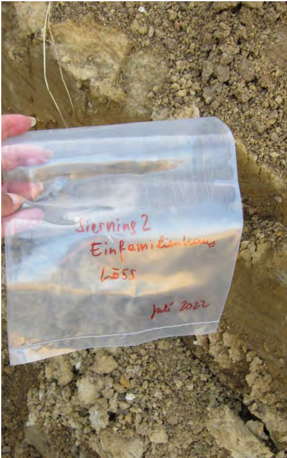
Abb. 2.1.1.26: Baustelle für ein Einfamilienhaus in Sierning: 2,5m hoher Hanganschnitt aus quartären karbonatfreien Deckschichten (Löss-Lehm); Probenahme (Foto: M. Peresson).
