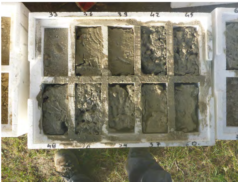
Abb. 2.1.3.5.: Baugrube in Sommerfeld, Schlatten: Imloch-Bohrung; ab 6m Tiefe grauer bis bräunlicher Robulus Schlier (Foto: F. Hofmayer).
