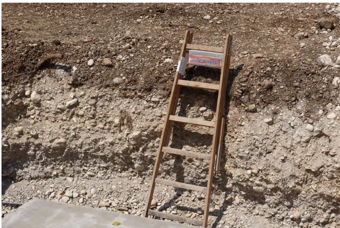
Abb. 2.2.2.13: Baustellengelände in Wels, Oberhaid: Dreigliederung des Hanganschnittes: Parabraunerdehorizont am Top; die Niederterrassenkiesen zeigen eine Zweigliederung mit chaotische Ablagerungen im Hangenden und Einregelungen an der Basis (Foto: H. Peresson).
