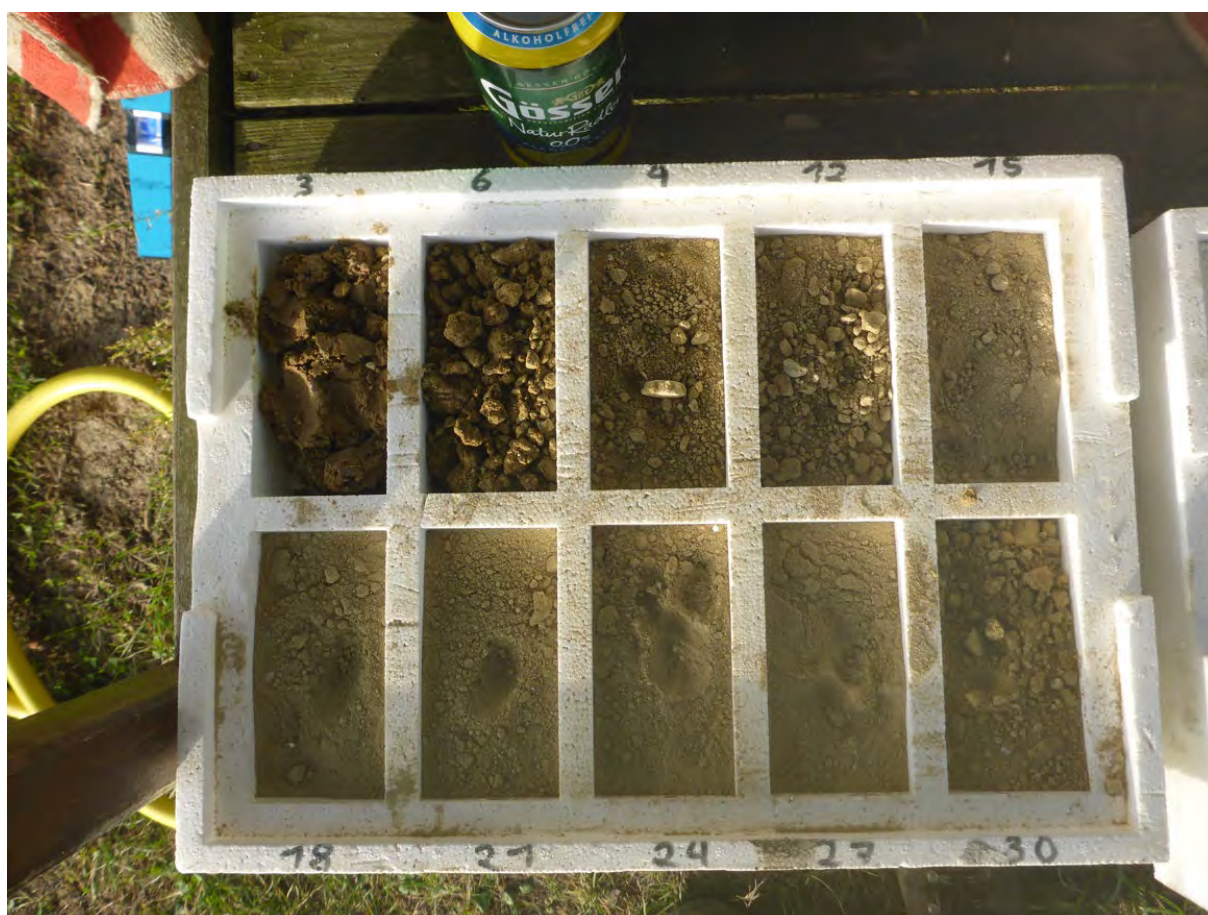
Abb. 2.1.3.4.: Baugrube in Sommerfeld, Schlatten: Imloch-Bohrung; bis 6m Tiefe: Kletzenmarkt-Glaukonitsand-Formation; im Anschluss daran Robulus Schlier (Foto: F. Hofmayer).
