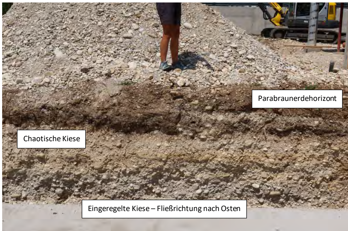
Abb. 2.2.2.12: Baustellengelände in Wels, Oberhaid: Dreigliederung des Hanganschnittes: Parabraunerdehorizont am Top; die Niederterrassenkiesen zeigen eine Zweigliederung mit chaotische Ablagerungen im Hangenden und Einregelungen an der Basis (Foto: H. Peresson).
