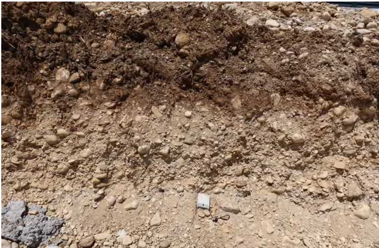
Abb. 2.2.2.15: Baustellengelände in Wels, Oberhaid: Niederterrassenkiesen mit Rollkieslagen (sehr feinkörnige Kiese ohne Matrix) (Foto: H. Peresson).
