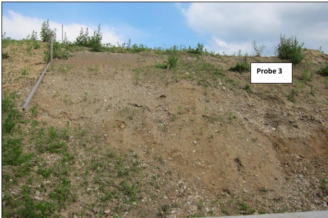
Abb. 2.2.3.16: Undeutlicher Grenzbereich zwischen Deckschichten (Lösslehm) und Kiesen der Hochterrasse im Aufschlussbereich 2 (Foto: M. Peresson).
