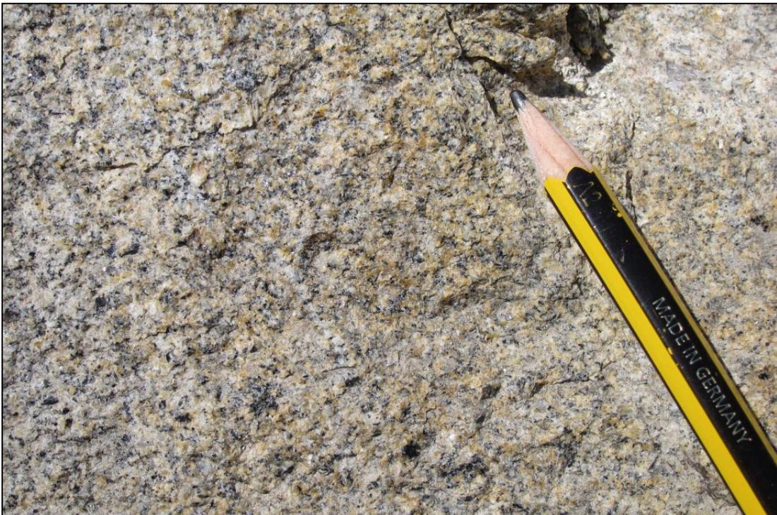
Abb. 2.1.1.7: Detailfoto „Altenberger Granit“ im Bereich des Südportals beim Tunnel Neumarkt: Deutlich erkennbar feinkörniger schwarzer Biotit, glänzender Hellglimmer, Kalifeldspäte und Quarz (Foto: M. Peresson).
