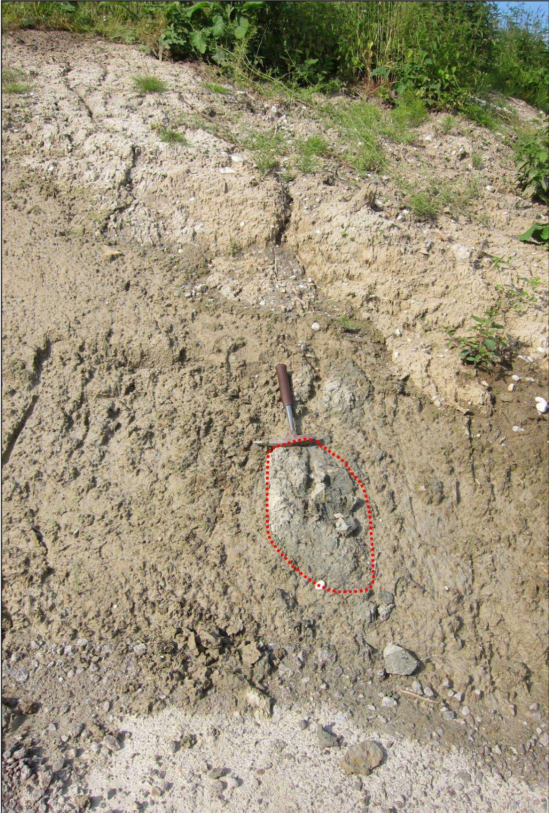
Abb. 2.2.3.11: Schluffig, sandige bräunliche (Lösslehm?) bis graue Sedimente (mit Komponente aus Vöckla-Formation?) im Hanganschnitt (Solifluktionsbereich) (Foto: M. Peresson).
