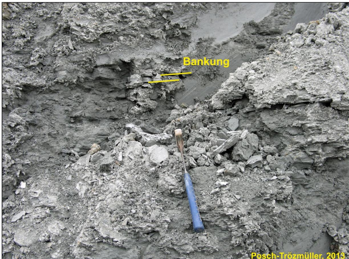
Abb. 2.2.4.12: Detailaufnahme im Bereich A: Eine Bankung im cm-Bereich ist zu sehen, eine mm-feine Schichtung mit Sandbestegen war auch vorhanden, übersteigt aber die Auflösung des Fotos.
