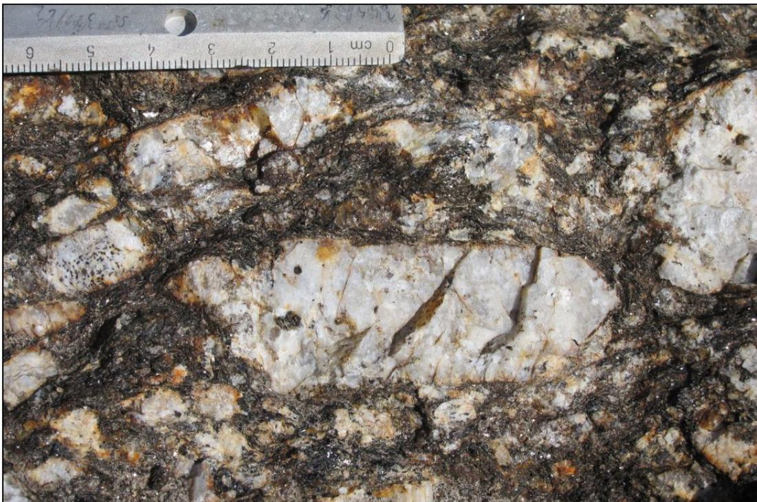
Abb. 2.1.1.22: Aufschlusspunkt 2 nördlich des Tunnels Neumarkt: Bis zu 7cm große, idiomorph ausgebildete Kalifeldspäte im Weinsberger Granit (Foto: M. Peresson).
