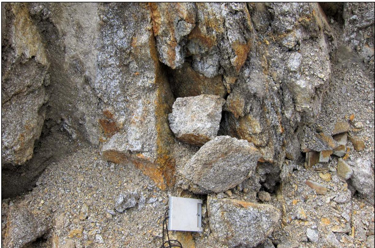
Abb. 2.2.2.23: Subvertikale, (W)NW-(E)SE streichende Klüfte im Paragneis parallel zum Pfehlstörungssystem (Foto: M. Peresson).
