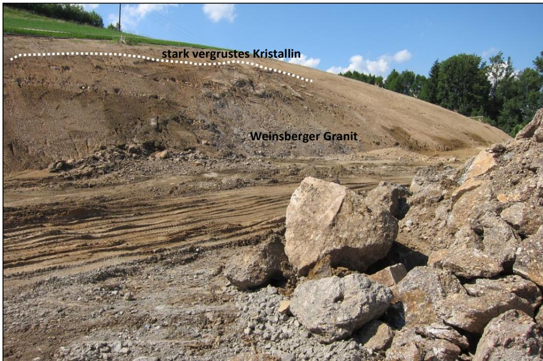
Abb. 2.1.1.21: Aufschlusspunkt 2 nördlich des Tunnels Neumarkt: Anstehender stark verwitterter Weinsberger Granit im Liegenden; im Hangenden stark vergrustes Kristallin (Foto: M. Peresson).
