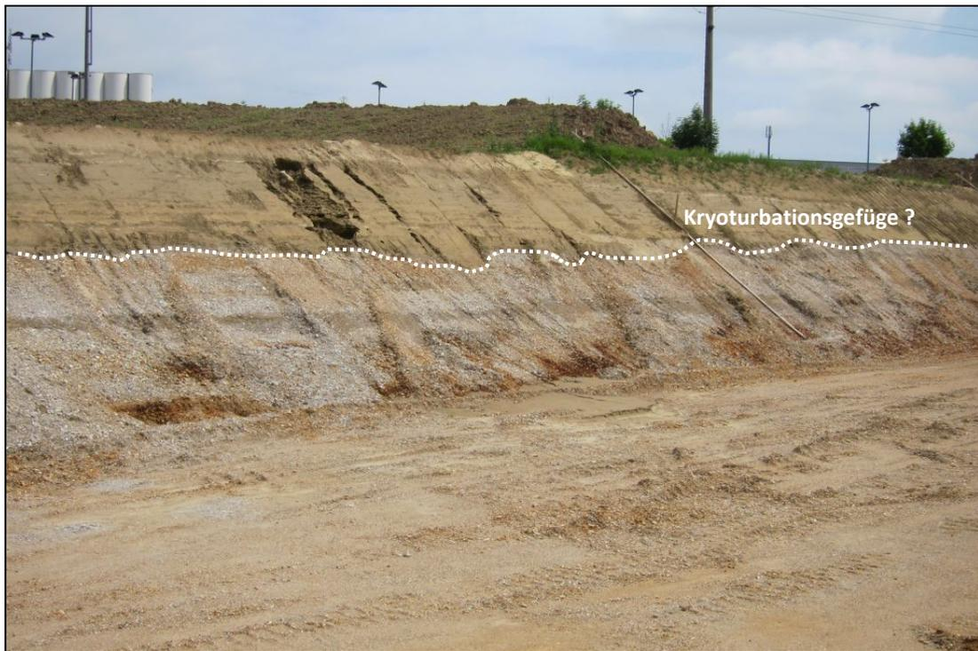
Abb. 2.2.1.17.: Deckschicht (Lehm) auf Niederterrassenkiesen mit ? Kryoturbationsgefüge im Aufschlussbereich 1 (Foto: M. Peresson).
