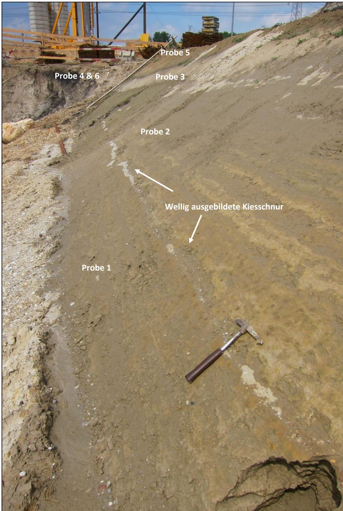
Abb. 2.2.1.13.: Überblicksfoto (mit Probenahmepunkten) der karbonatfreien sandig-schluffigen Deck-schichten im Liegenden der „Eferding-Formation“; in der Bildmitte (Hammer) eine helle wellig ausgebildete „Kiesschnur“ im Aufschlussbereich 1 (Foto: M. Peresson).
