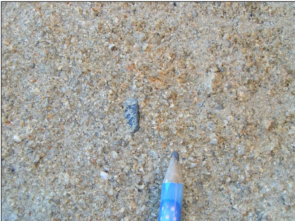
Abb. 2.1.1.51: Aufschlusspunkt 4 im Bereich der Unterflurtrasse Ganglsiedlung bei Lest: Fluviale Sedimente des Freistädter Tertiärs – Detailaufnahme der quarzreichen Sandfazies (Foto: M. Rockenschaub).
