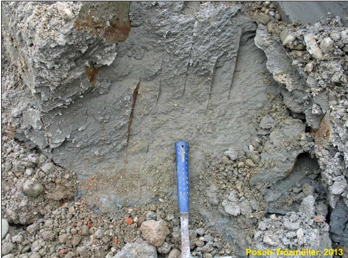
Abb. 2.2.4.17: Mehrere parallele Klüfte (165/95) im Abstand von jeweils 5 cm etwa 2 m unter GOK.
