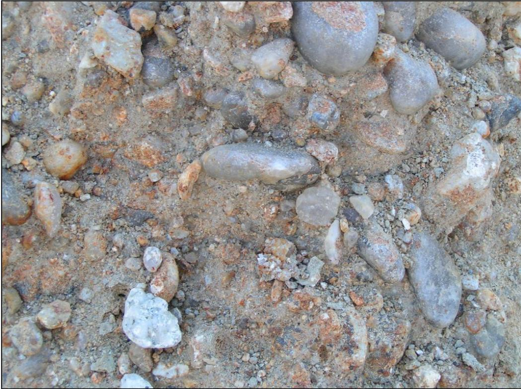
Abb. 2.1.1.50: Aufschlusspunkt 4 im Bereich der Unterflurtrasse Ganglsiedlung bei Lest: Fluviale Sedimente des Freistädter Tertiärs – Detailaufnahme der quarzreichen Kiese (Foto: M. Rockenschaub).
