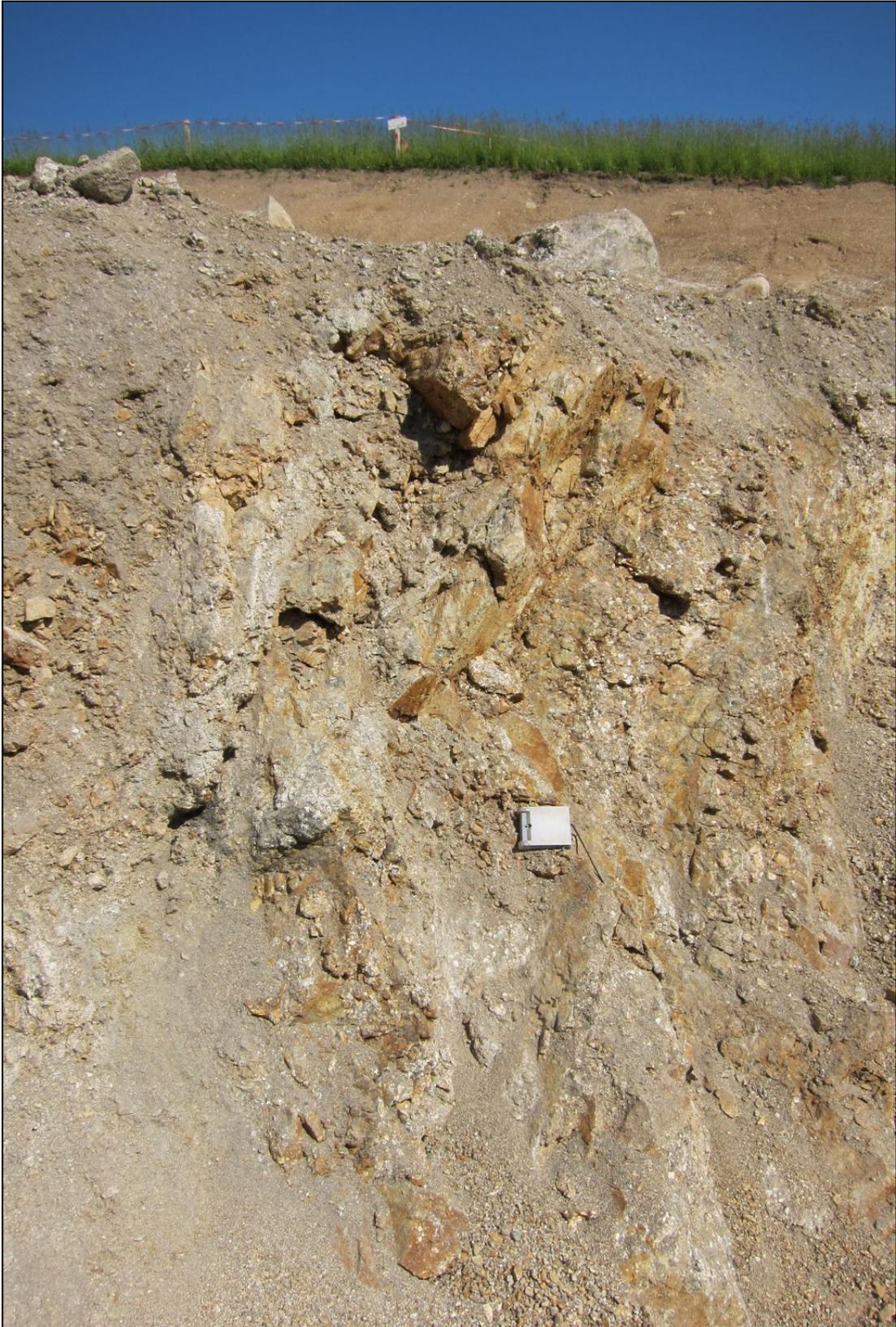
Abb. 2.1.1.33: Aufschlusspunkt 3 westlich von Perna: Stark tektonisierter Altenberger Granit mit steilstehenden Klüften (Foto: M. Peresson).
