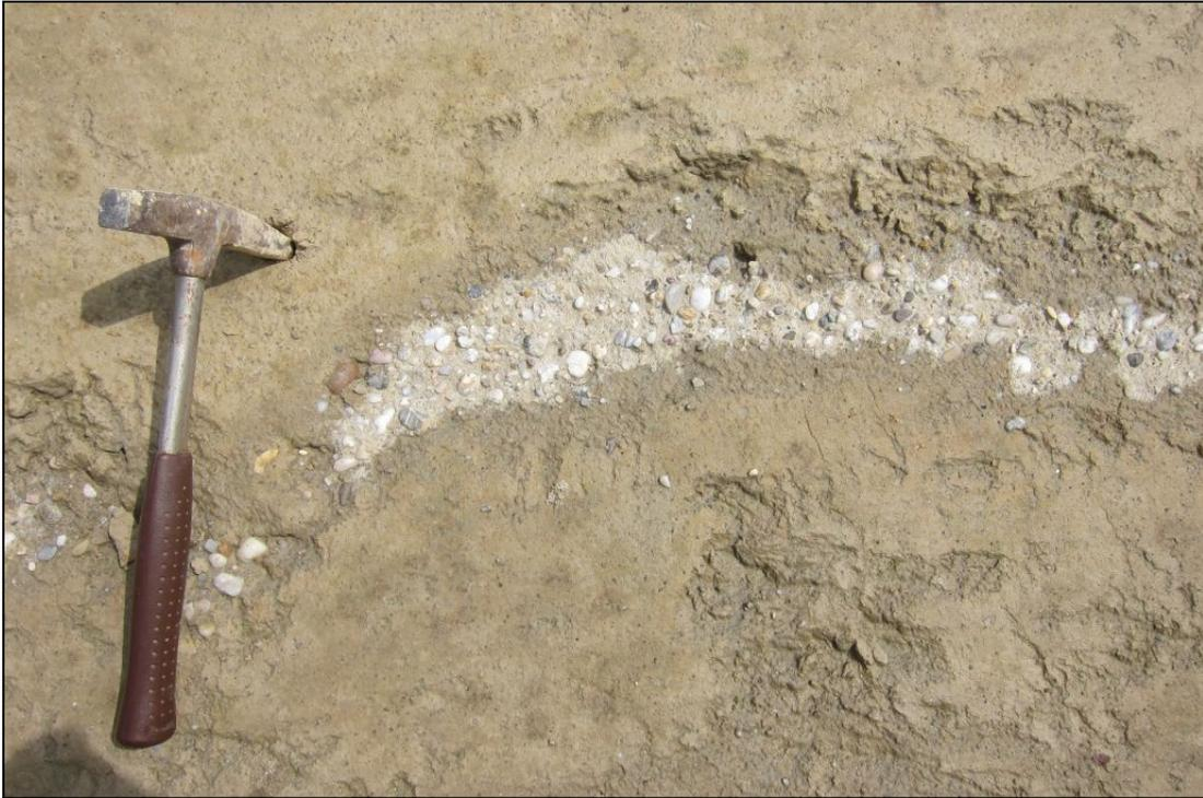
Abb. 2.2.1.14.: Detailaufnahme der wellig ausgebildeten „Kiesschnur“ innerhalb der karbonatfreien sandig-schluffigen Deckschichten im Aufschlussbereich 1 (Foto: M. Peresson).
