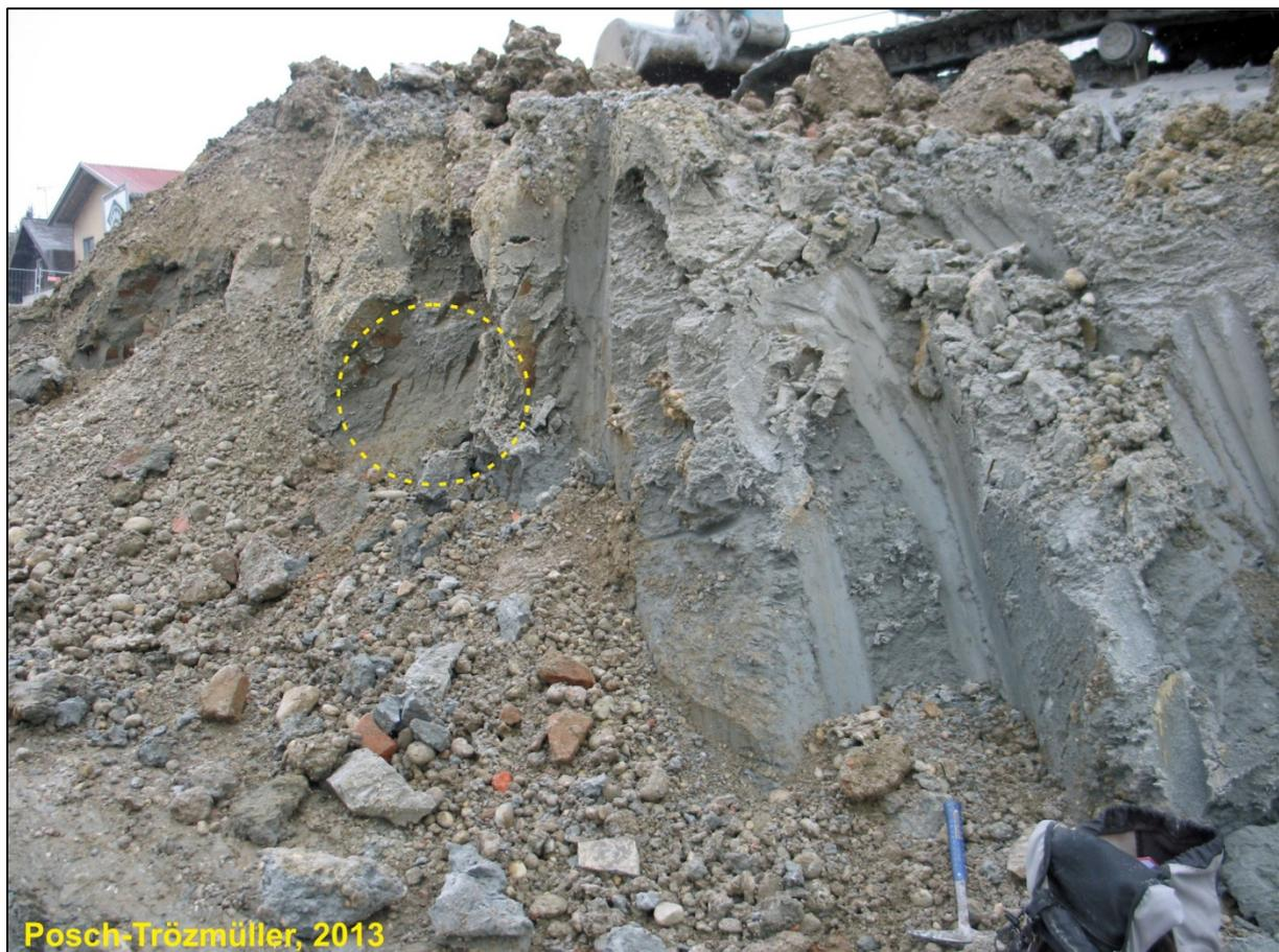
Abb. 2.2.4.16: Detailbereich D nahe dem neu gebauten Kreisverkehr. Die gelbe Markierung weist auf mehrere parallele Klüfte hin, die in Abb.2.2.4.17 im Detail dargestellt sind.
