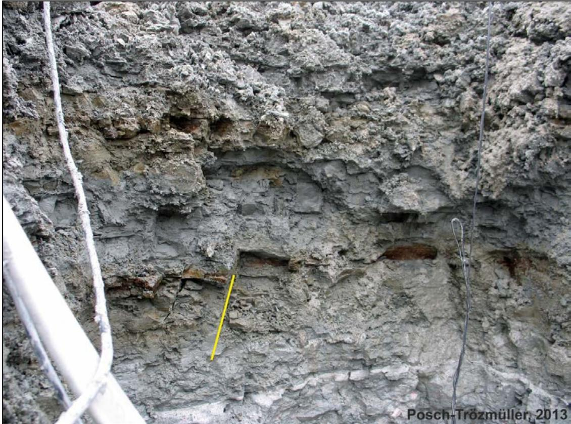
Abb. 2.2.4.14: Rostbraune Schichten und auffällige Klüftung (gelbe Markierung) in Detailbereich C.
