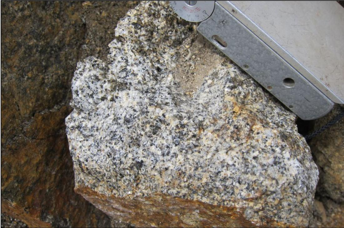
Abb. 2.2.2.19: Detailfoto von relativ unverwittertem, diatektischem Paragneis im Aufschlusspunkt 2 (Foto: M. Peresson).
