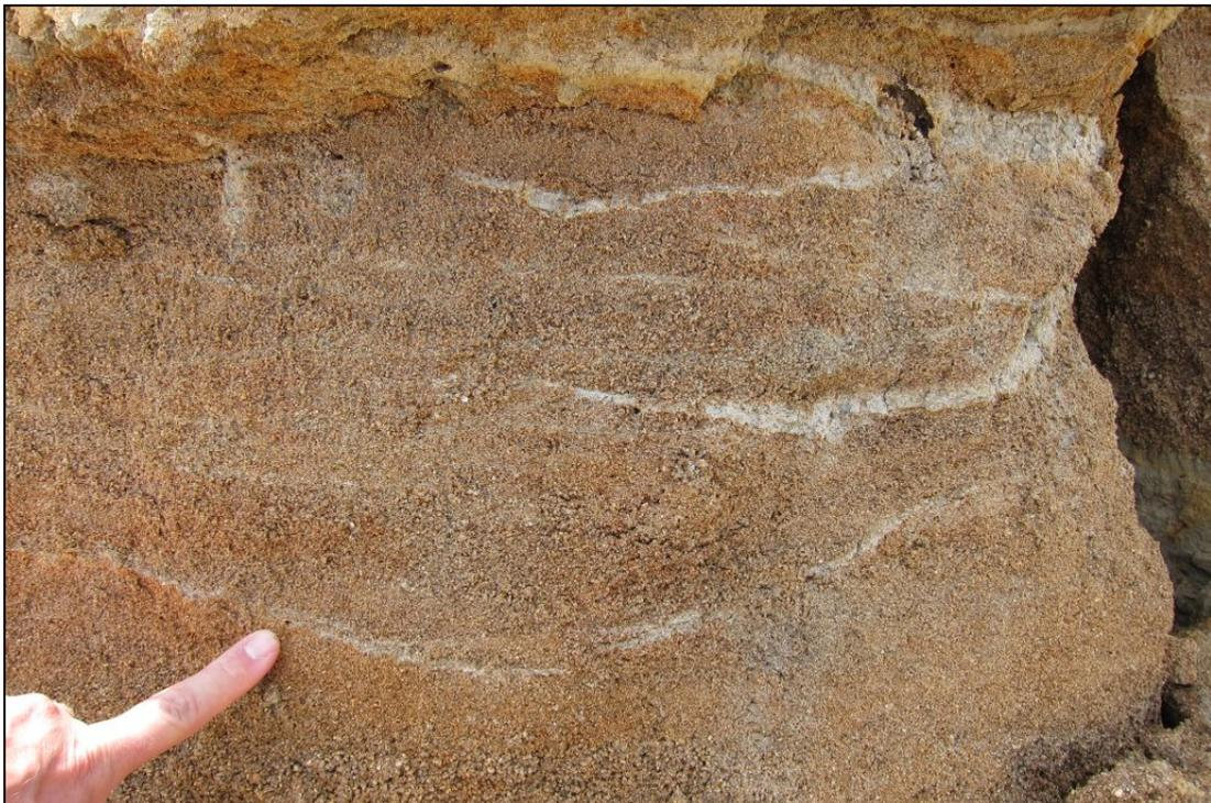
Abb. 2.2.2.12: Detailfoto der fluviatil abgelagerten Deckschichten: Gemisch aus vergrustem Kristallin, Linzer Sanden und Schwemmlöss (Foto: M. Peresson).
