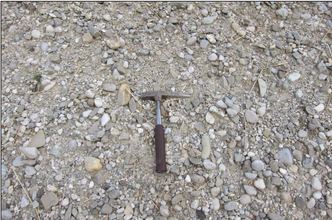
Abb. 2.2.3.14: Detailfoto: Kiese der Hochterrasse im Aufschlussbereich 2; Flysch, Karbonat und Quarzkomponenten (Foto: M. Peresson).
