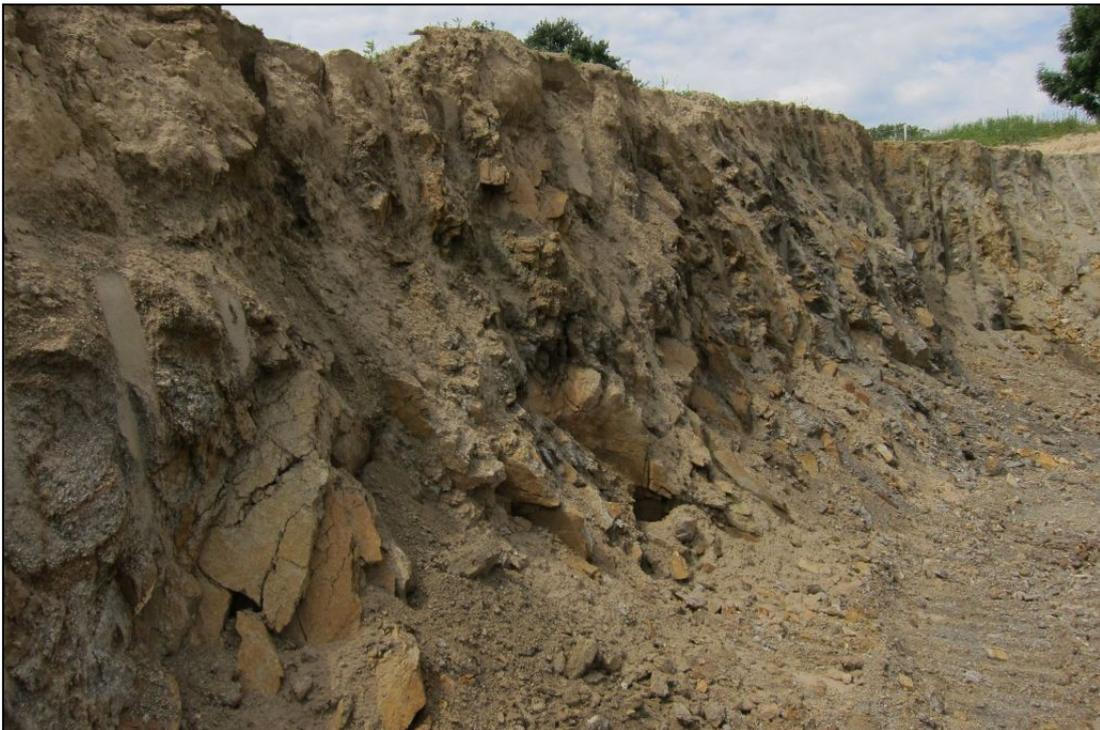
Abb. 2.2.2.20: Überblicksfoto von stark geklüftetem Paragneis im Aufschlusspunkt 2 (Foto: M. Peresson).
