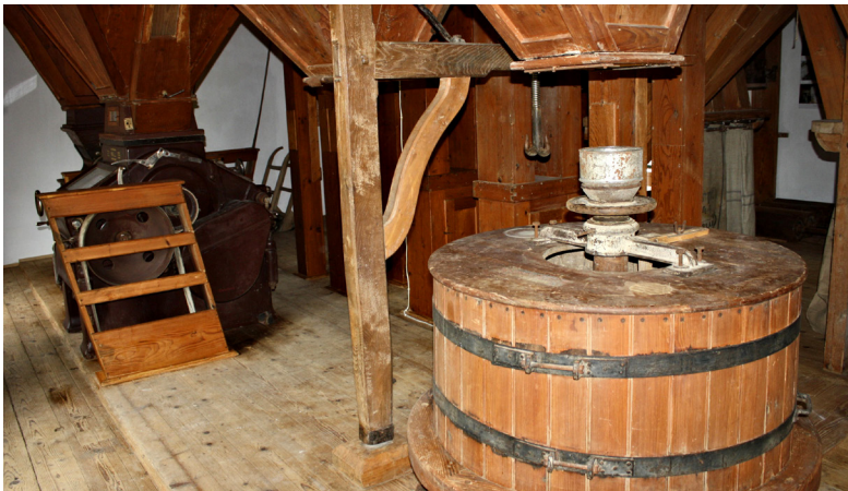
Steingang mit Walzenstuhl, Restaurierung noch nicht abgeschlossen (unten)
