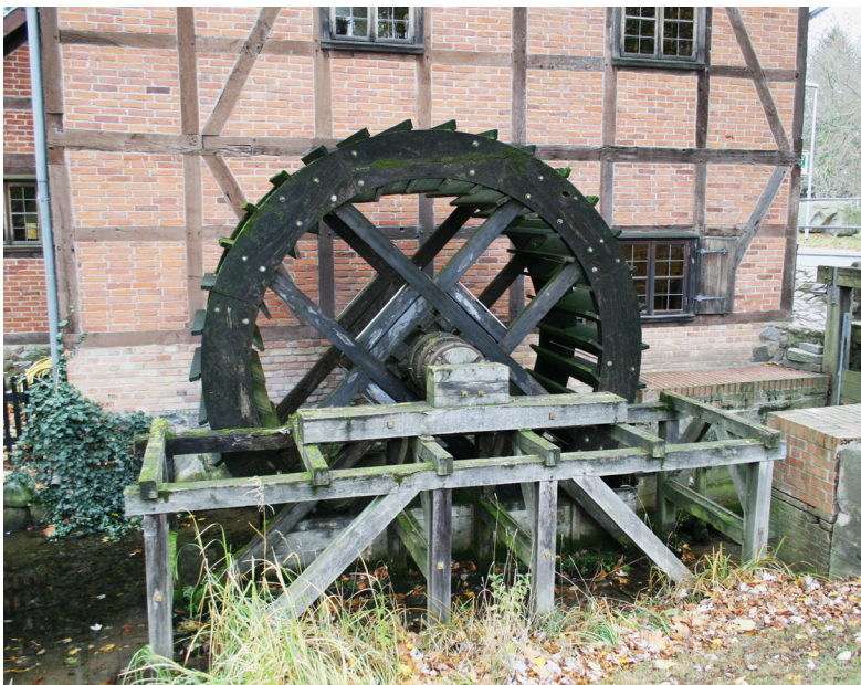
Unterschlächtiges Wasserrad an der Schleifmühle Schwerin (Mecklenburg-Vorpommern)
