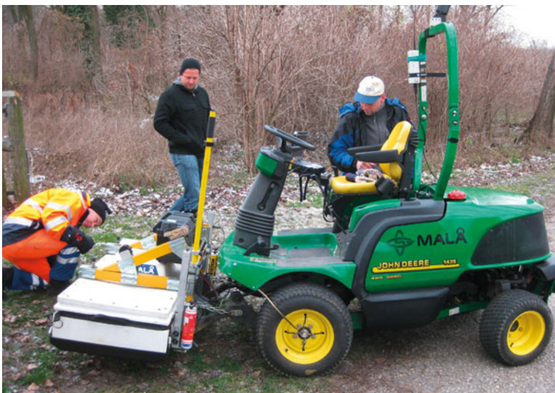
Motorisiertes MIRA-Bodenradarsystem (MALÅ) mit einer Multiantennen-Anordnung bestehend aus 16 Radarantennen mit einer Zentrumsfrequenz von 400 MHz im Testeinsatz in Carnuntum 2010
