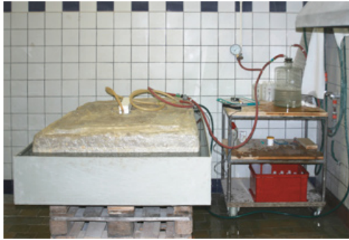
Technisch aufwendige Entsalzung im Unterdruckverfahren zur Minimierung der Schadsalze
