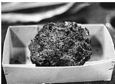
Luppe fast fertig geschweißt, Schlacke in kleinen Resten enthalten (Bild rechts)
