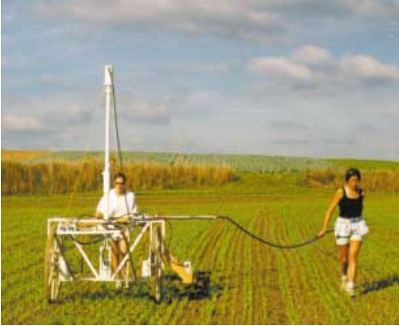
Abb. 2: Cäsiummagnetometer bei der Messung 2000 in Roseldorf, NÖ. In der Radachse sind in einem Abstand von 0.5 m vier Messsensoren in 0.35 m Höhe über dem Boden angebracht. Ein fünfter Sensor zur Korrektur der natürlichen zeitlichen Schwankungen des Erdmagnetfeldes befindet sich auf einer Teleskopstange in 2.85 m Höhe über der Bodenoberfläche. Der Sensorwagen ist über ein 50 m langes Kabel mit dem zweiten Wagen verbunden, der die Stromversorgung und die Datenaufzeichnung enthält (NEUBAUER, 2001; NEUBAUER ET AL., 2001).
