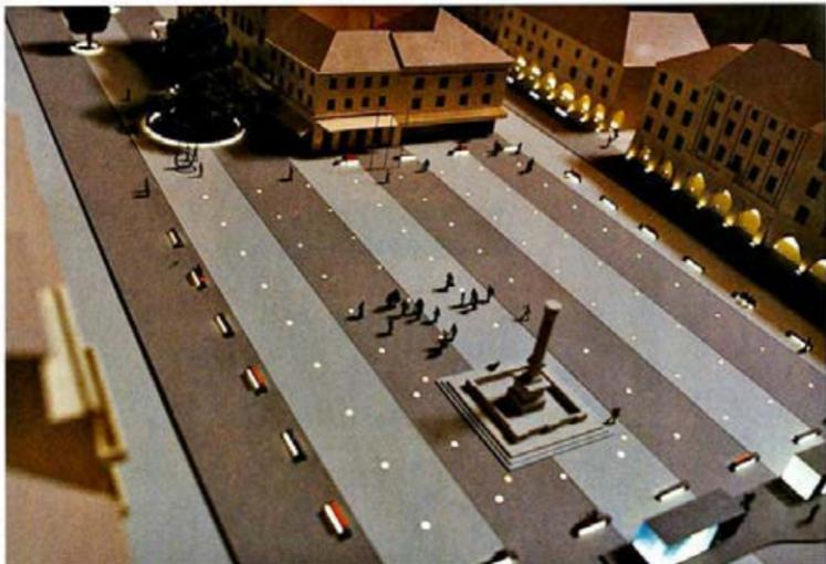
Die Geometrie des Platzbelages entspricht jener Zahlengeometrie, die der Platzneugründung 1194 zu Grunde lag. In diesen, parallel zum Äquator verlaufenden Granitstreifen von 8,20m befinden sich an die 60 unterirdische Infrastrukturschächte, die Anschlüsse für Strom, Wasser und Abwasser bereithalten.
