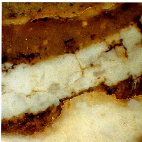
Laborbefund: Farbschichten auf Stein, drei nachfolgende Vergoldungen auf Bleiweißgrundierung
