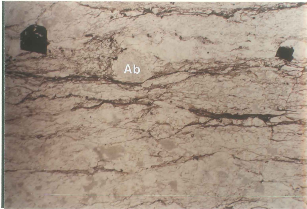
Abb. 7: P 19, erzführender, Feldspatschiefer, Vergr. ca. 12x, Nichols //. Representativer Ausschnitt bezüglich der Erzführung, Bildmitte oben: Albitblast. Glimmerlagen limonitisch verwittert.
