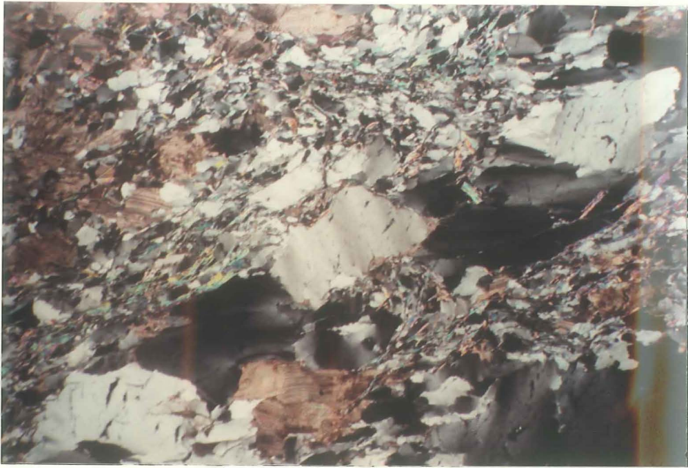
Abb. 19: P 27, Ep-Karb-Chl-Phyllit, Vergr. ca. 12x, Nichols +. Stark defomierte Quarze, ausgeprägte Felderung, an den Korngrenzen beginnende Rekristallisation. Im Bild unten deformiertes Karbonat aus Abb. 18.
