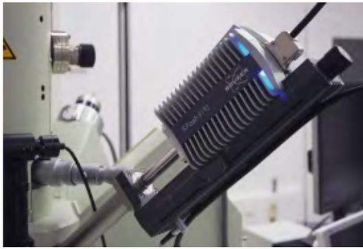
Energiedispersiver Detektor der Elektronenstrahlmikrosonde.
