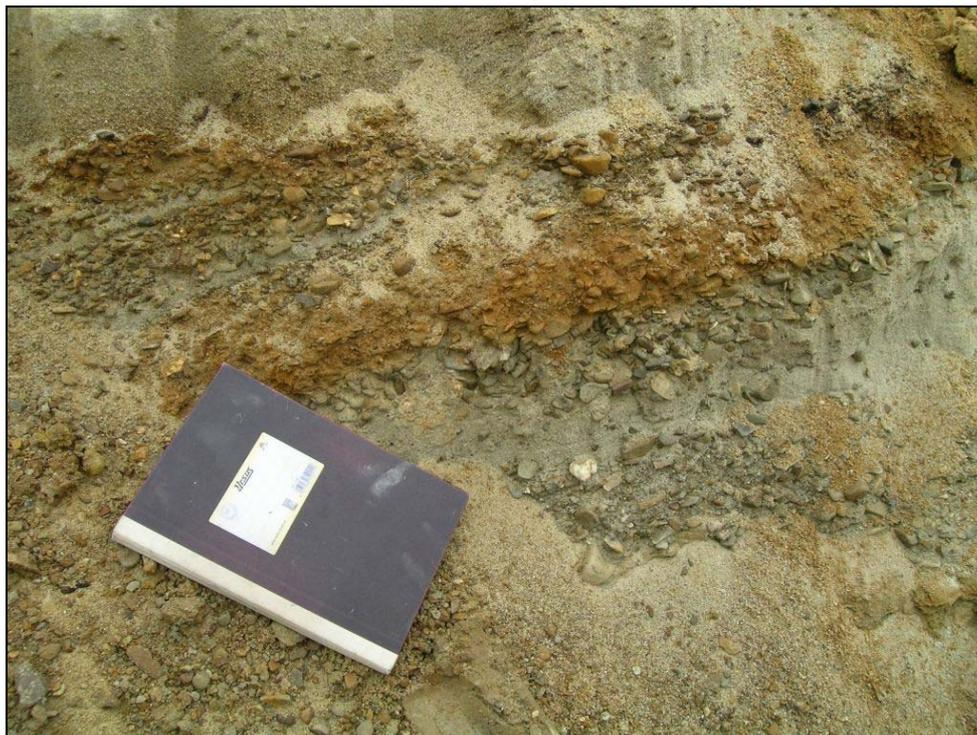
Abb. 3.1.8: Baugrube südl. Maria Jeutendorf: Rostrote bis schwarze Fein- bis Mittel- bis Grobkiese (Jüngere Deckenschotter, Mindel) (Foto: 04/05/2005)
