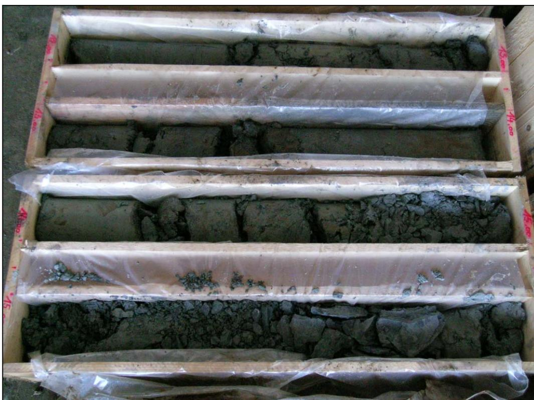
Abb. 3.2.6: City-Tunnel Waidhofen/Ybbs – KBB20/05: Wechselfolge aus Schluffsteinen, Tonsteinen, Kalkmergeln, tektonisch beansprucht (Foto: 15/11/2005)
