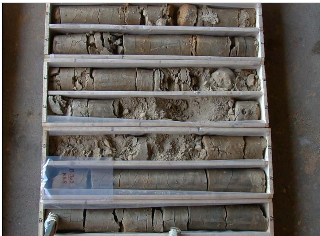
Abb. 3.1.43: KB8/04: schluffig, tonige Deckschichten im Übergang zur Grund-Formation bei 8,8m (Umfahrung B303 Weinviertler Straße) (Foto: 01/09/2004)
