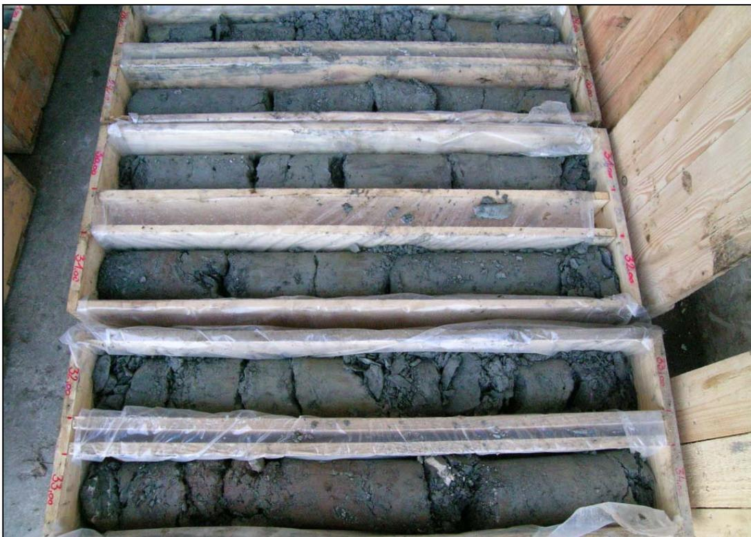
Abb. 3.2.10: City-Tunnel Waidhofen/Ybbs – KBB20/05: Wechselfolge aus Schluffsteinen, Tonsteinen, Kalkmergeln; Einschaltung von roten Buntmergeln (Foto: 15/11/2005)
