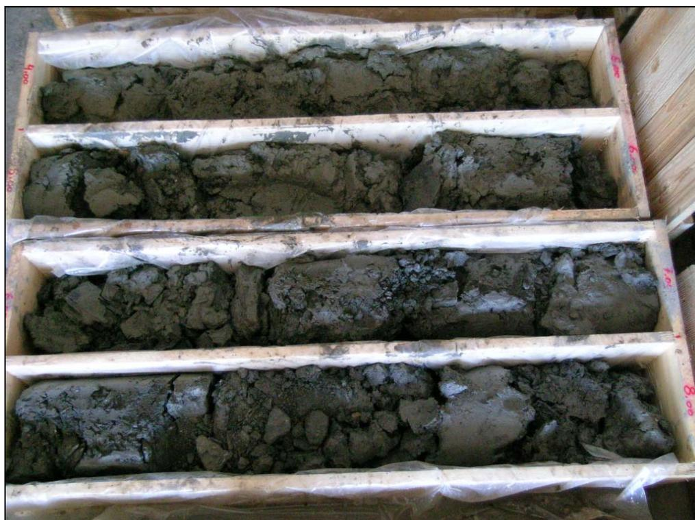
Abb. 3.2.4: City-Tunnel Waidhofen/Ybbs – KBB20/05: Wechselfolge aus Schluffsteinen und Tonsteinen, tektonisch beansprucht (Foto: 15/11/2005)
