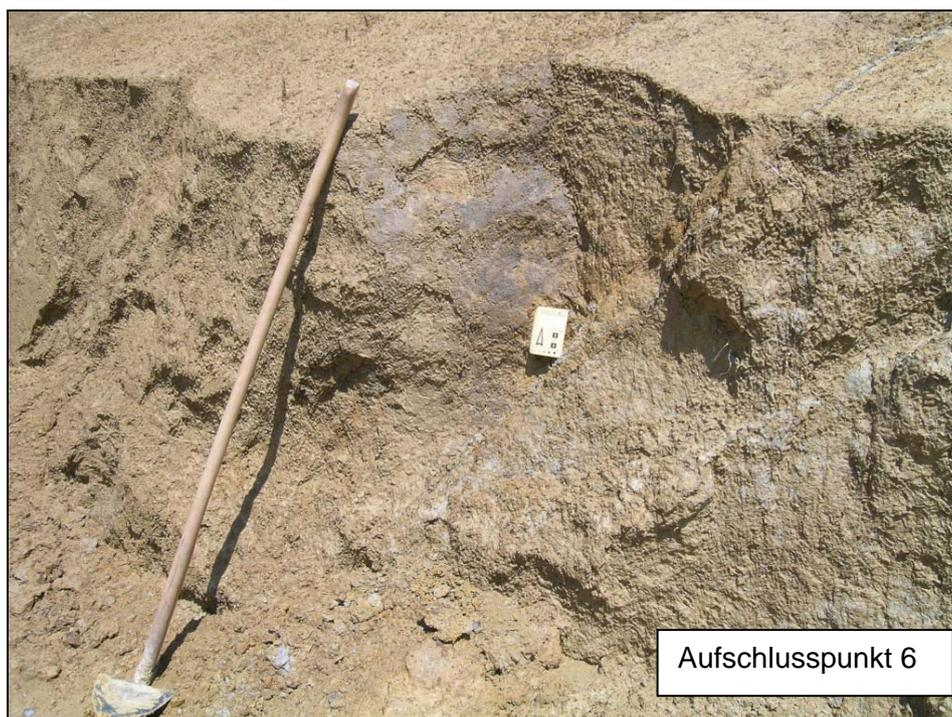
Abb. 3.1.84: Aufschlusspunkt 6: schluffig, tonige Deckschicht mit Harnischflächen (ÖK 53)
