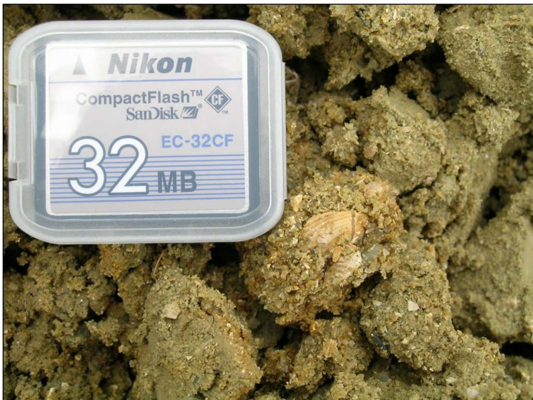
Abb. 3.1.50: KB28/04: Grund-Formation mit Molluskenbruchstücken bei 6,5m (Detail)
