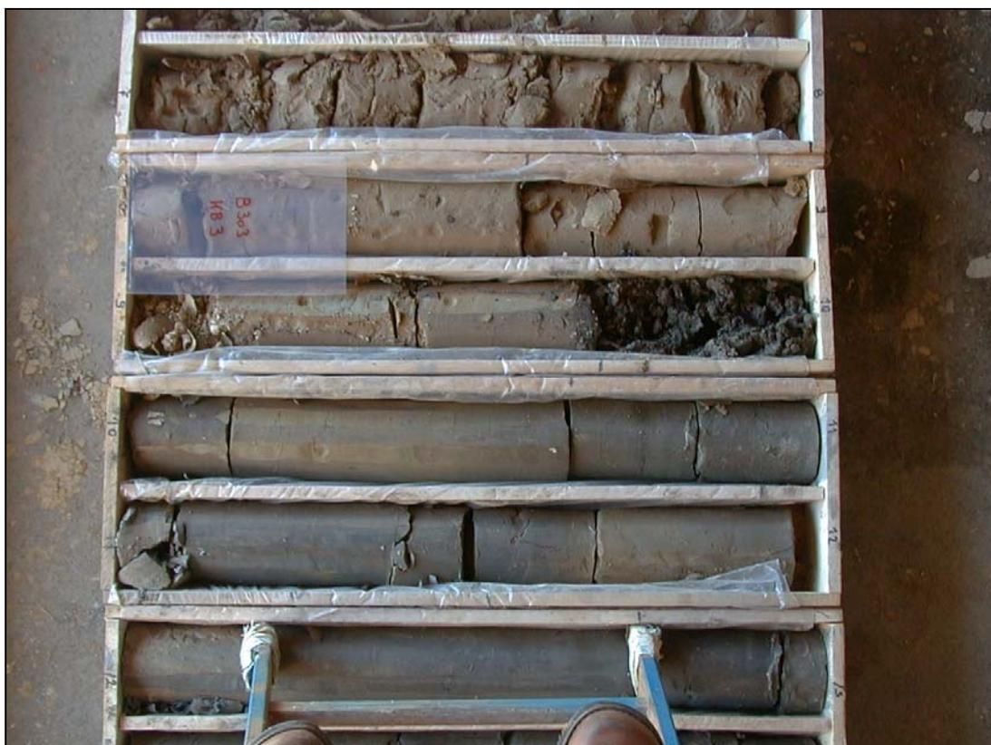
Abb. 3.1.39: KB3/04: schluffig, tonige Deckschichten im Übergang zur Grund-Formation bei 9,7m (Umfahrung B303 Weinviertler Straße) (Foto: 01/09/2004)
