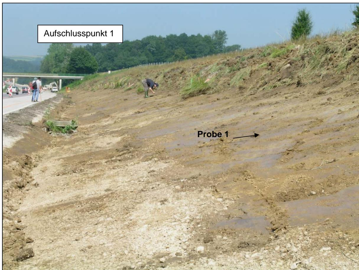
Abb. 3.1.77: Aufschlusspunkt 1 entlang der Westautobahn, NE Blindenmarkt (ÖK 53). Quartäre Löss- und Niederterrassekiese (Foto: 13/07/2005)
