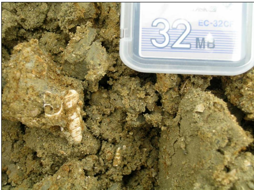
Abb. 3.1.51: KB28/04: Grund-Formation mit Molluskenbruchstücken bei 6,5m (Detail)
