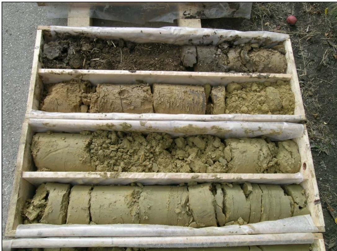
Abb. 3.1.46: KB28/04: schluffig, tonige Deckschichten im Übergang zur Grund-Formation bei 2,3 (Umfahrung B303 Weinviertler Straße) (Foto: 29/09/2004)
