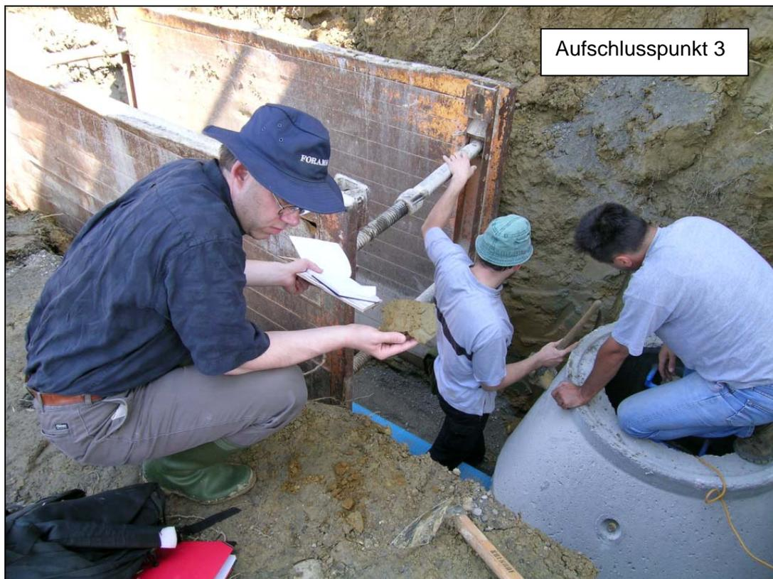
Abb. 3.1.79: Aufschlusspunkt 3 entlang der Westautobahn, NE Blindenmarkt (ÖK 53). Vergleichte, grüne Deckschicht und brauner Lehm (Foto: 13/07/2005)
