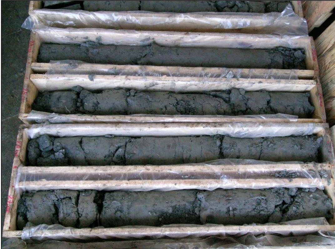
Abb. 3.2.9: City-Tunnel Waidhofen/Ybbs – KBB20/05: Wechselfolge aus Schluffsteinen, Tonsteinen, Kalkmergeln, tektonisch beansprucht (Foto: 15/11/2005)
