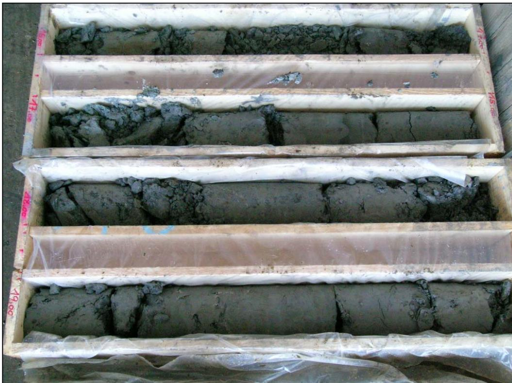
Abb. 3.2.7: City-Tunnel Waidhofen/Ybbs – KBB20/05: Wechselfolge aus Schluffsteinen, Tonsteinen, Kalkmergeln, tektonisch beansprucht (Foto: 15/11/2005)
