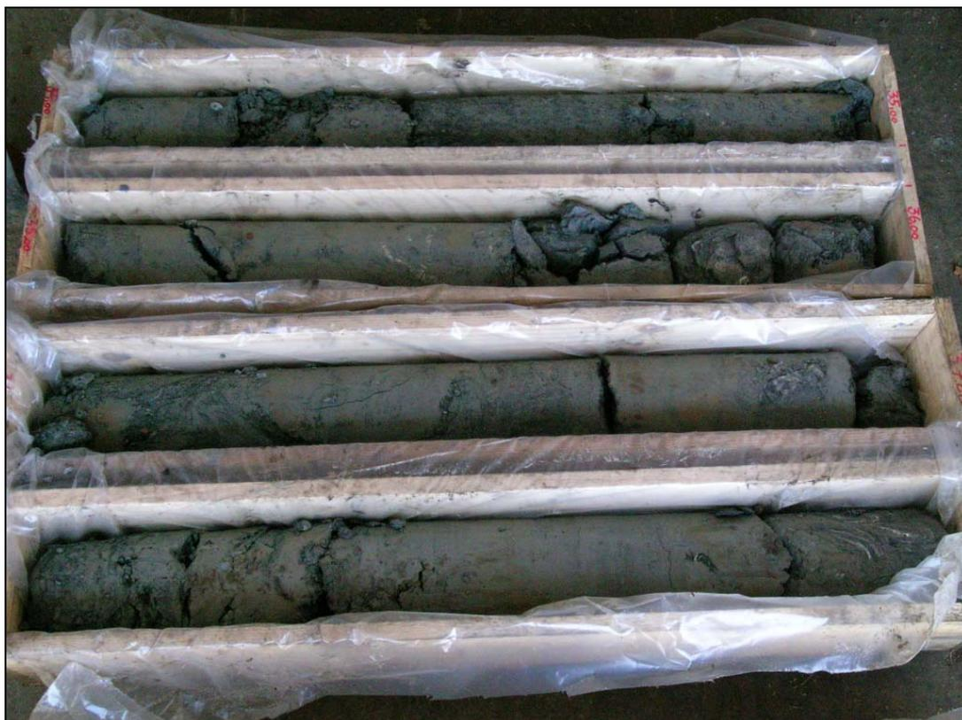
Abb. 3.2.11: City-Tunnel Waidhofen/Ybbs – KBB20/05: Wechselfolge aus Schluffsteinen, Tonsteinen, Kalkmergeln, tektonisch beansprucht (Foto: 15/11/2005)
