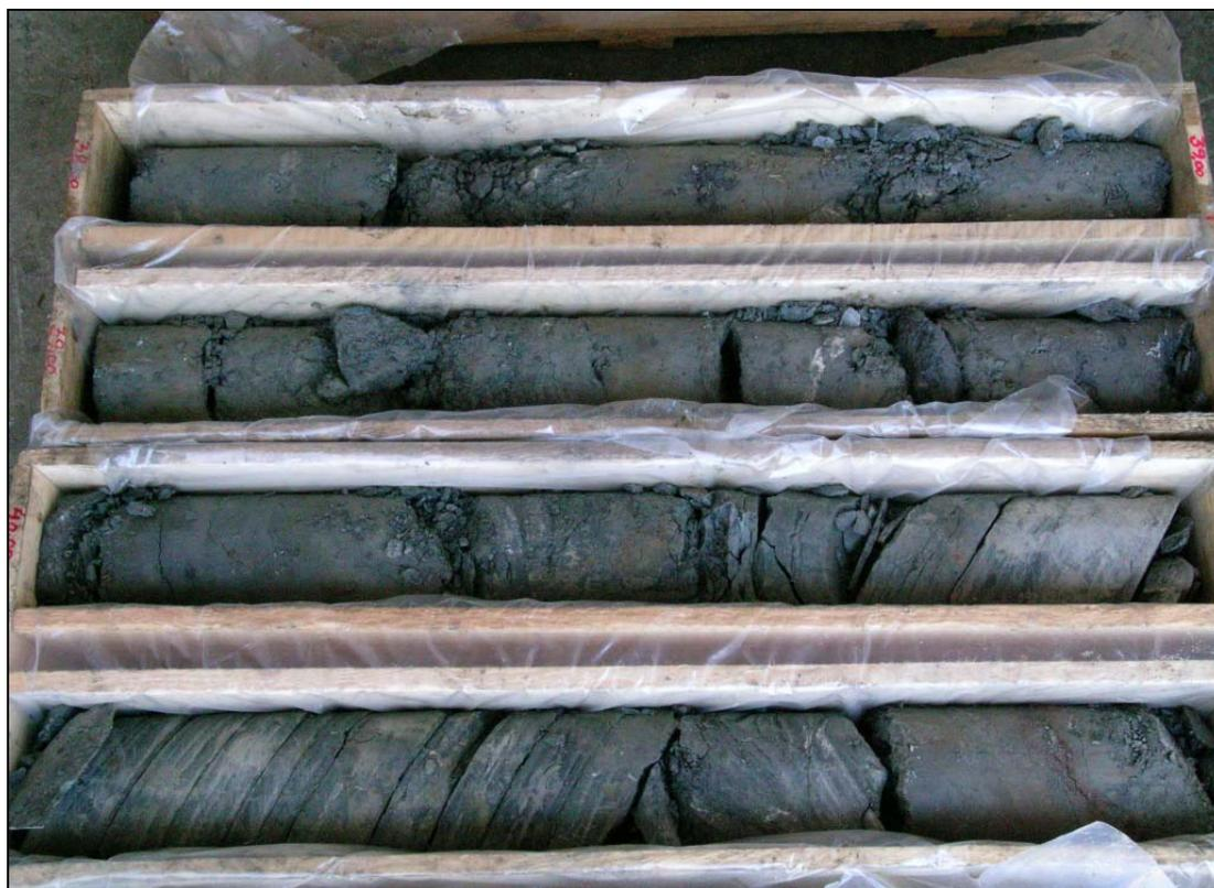
Abb. 3.2.12: City-Tunnel Waidhofen/Ybbs – KBB20/05: Wechselfolge aus Schluffsteinen und Tonsteinen, tektonisch beansprucht (Foto: 15/11/2005)
