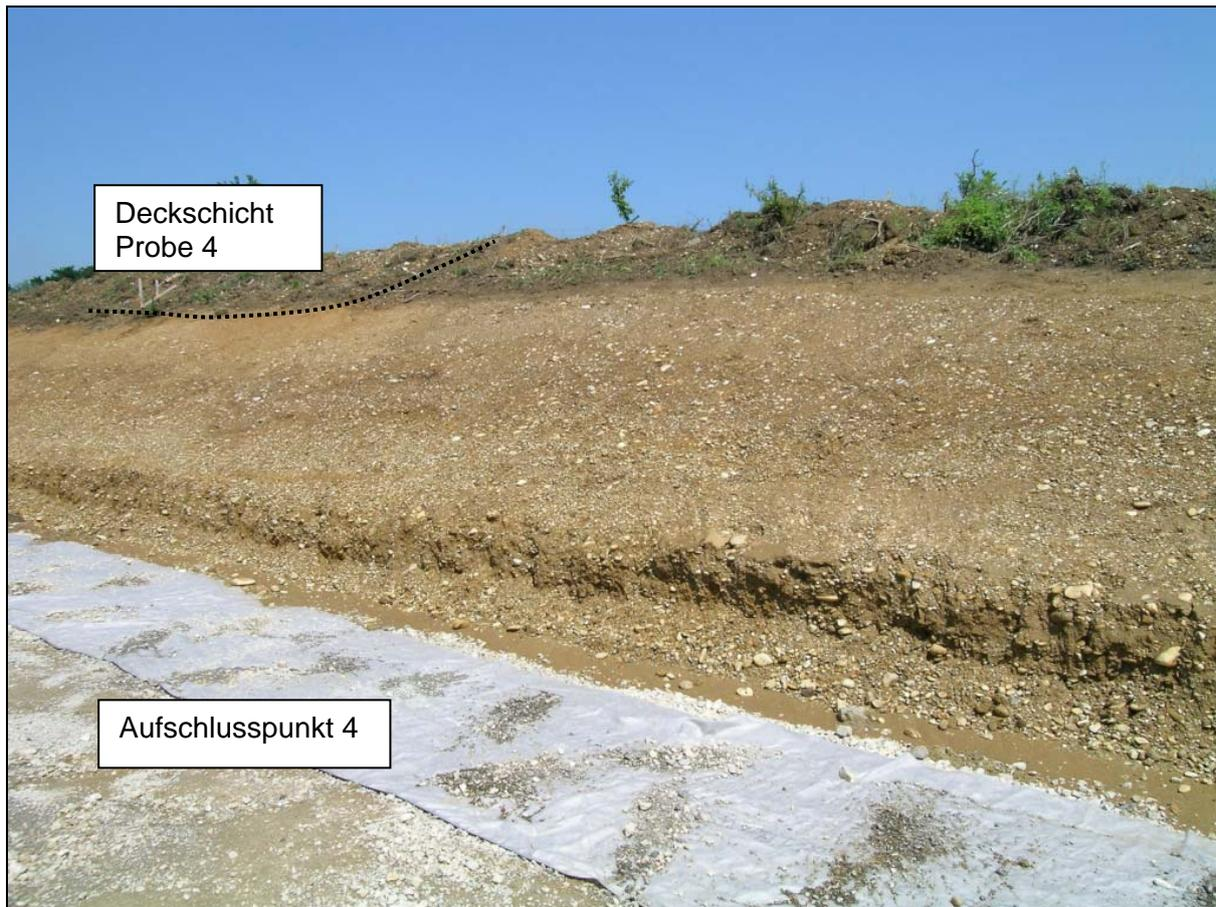
Abb. 3.1.81: Aufschlusspunkt 4 entlang der Westautobahn, S Thalling (ÖK 53). Braune Deckschicht im Hangenden gefolgt von Älteren Deckenschottern (Foto: 13/07/2005)
