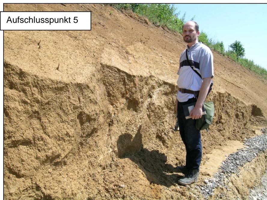
Abb. 3.1.83: Aufschlusspunkt 5: schluffig, tonige Deckschicht mit konjugierten Scherflächen
