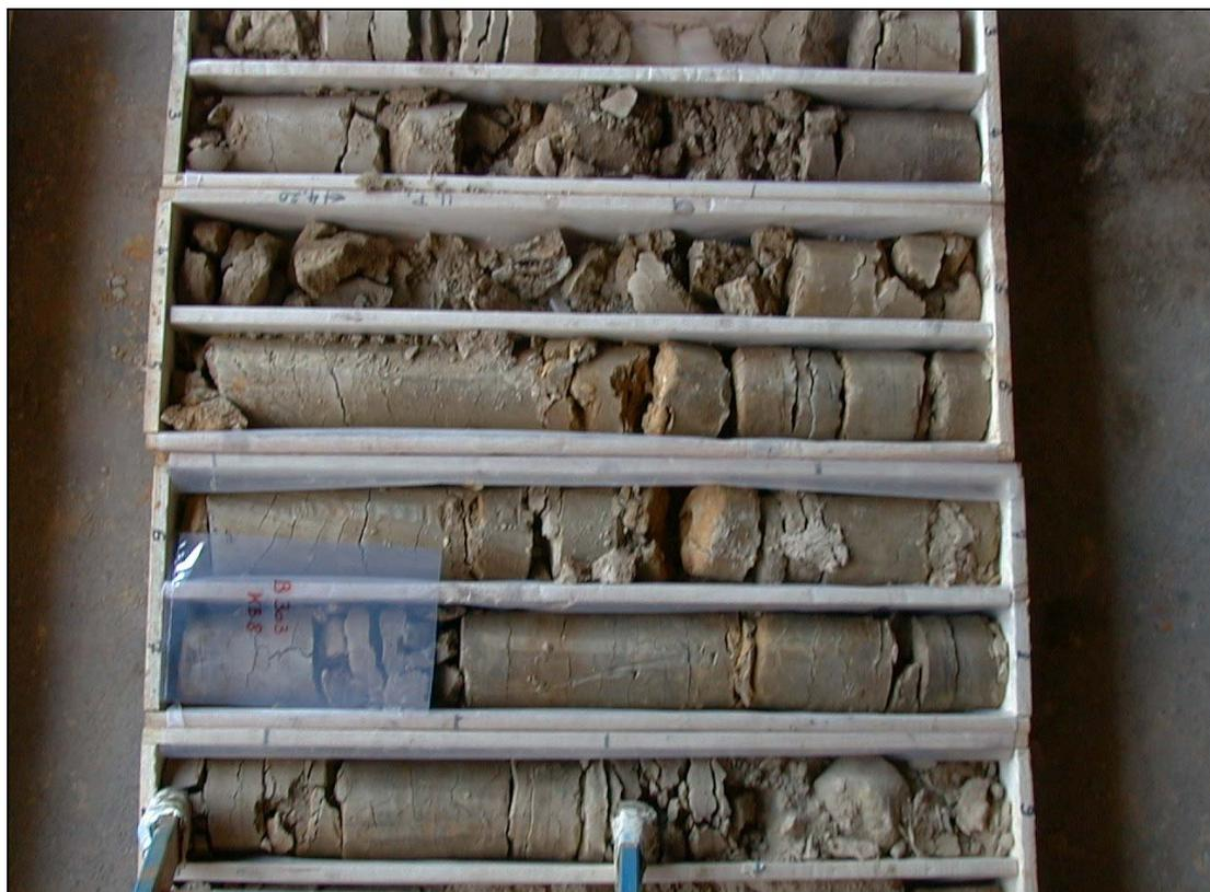
Abb. 3.1.42: KB8/04: schluffig, tonige Deckschichten im Übergang zur Grund-Formation bei 8,8m (Umfahrung B303 Weinviertler Straße) (Foto: 01/09/2004)
