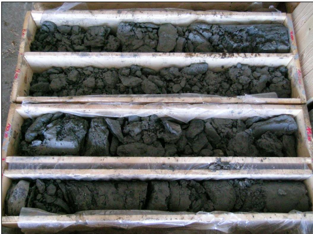
Abb. 3.2.5: City-Tunnel Waidhofen/Ybbs – KBB20/05: Wechselfolge aus Schluffsteinen und Tonsteinen, tektonisch beansprucht (Foto: 15/11/2005)
