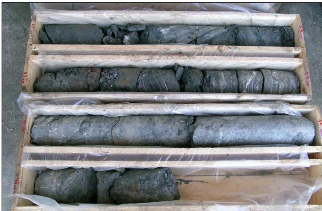
Abb. 3.2.13: City-Tunnel Waidhofen/Ybbs – KBB20/05: Wechselfolge aus Schluffsteinen, Tonsteinen, Kalkmergeln; Einschaltung von roten Buntmergeln (Foto: 15/11/2005)
