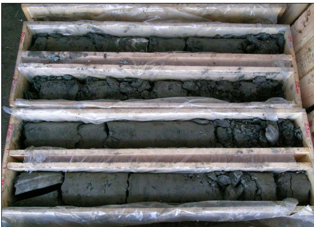
Abb. 3.2.8: City-Tunnel Waidhofen/Ybbs – KBB20/05: Wechselfolge aus Schluffsteinen, Tonsteinen, Kalkmergeln, tektonisch beansprucht (Foto: 15/11/2005)
