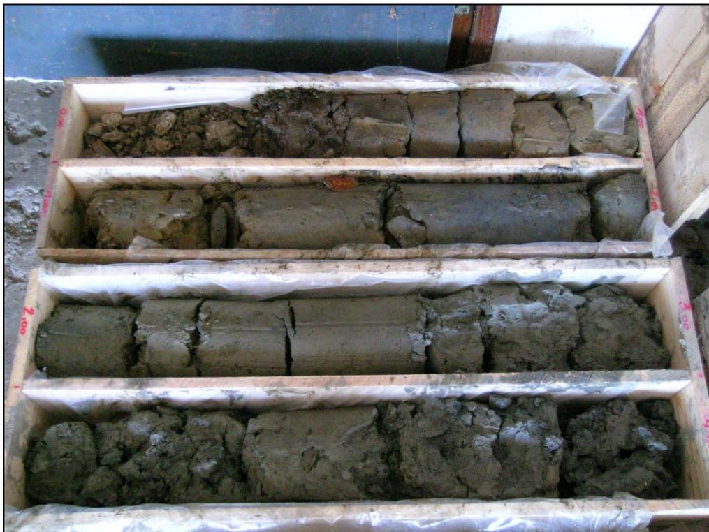
Abb. 3.2.3: City-Tunnel Waidhofen/Ybbs – KBB20/05: In den obersten 1,4m Hangschutt aus Schluffen und Kiesen, gefolgt von Schluffsteinen und Tonsteinen (Foto: 15/11/2005)
