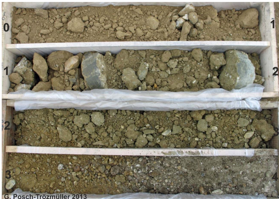
Abb. 2.4.6.: Kernbohrung SD III KB 1: 0-4 m. Die Bohrtiefenangaben beziehen sich nicht auf GOK, um die Tiefe unter GOK zu berechnen, muss jeweils 0,8 m addiert werden (siehe Bohrprofil, Tab. 2.4.2.).
