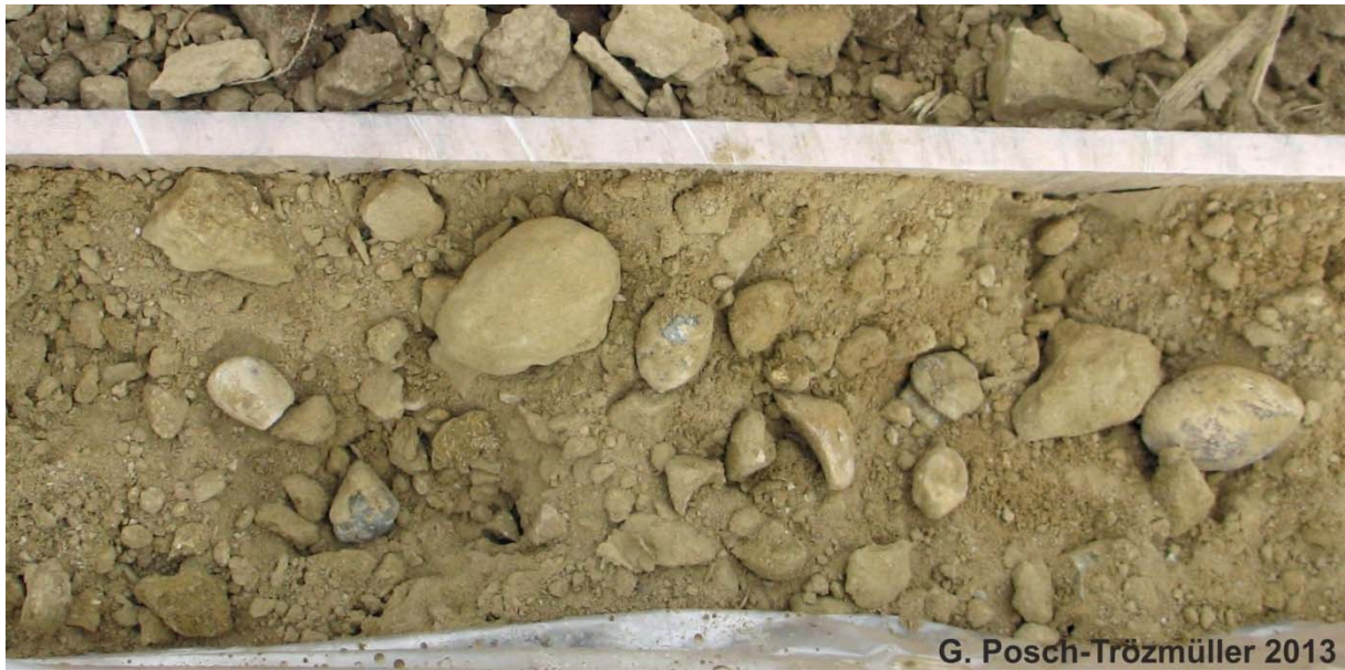
Abb. 2.4.21.: Detail von KB 6: 1,5 m Tiefe: Feinsandiger Schluff mit Kies.
