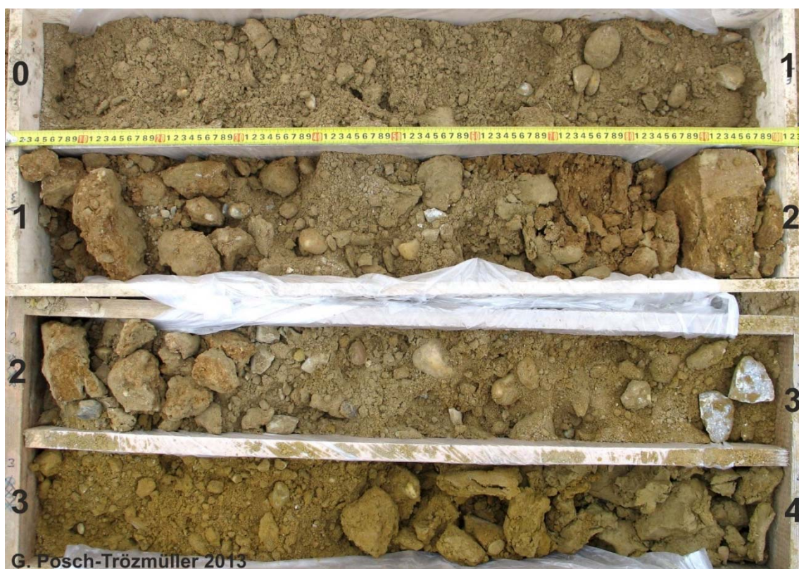
Abb. 2.4.15.: Kernbohrung SD III KB 3: 0-4m. Die Bohrtiefenangaben beziehen sich nicht auf GOK, um die Tiefe unter GOK zu berechnen, muss jeweils 0,6 m addiert werden (siehe Bohrprofil, Tab. 2.4.4.).
