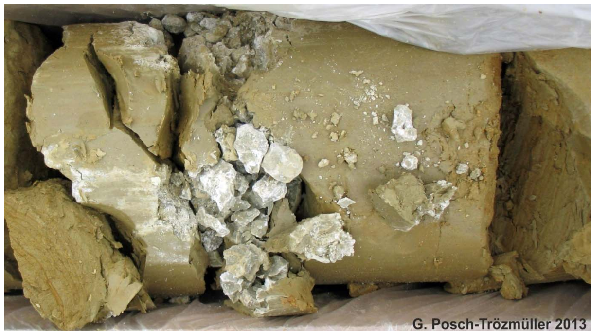
Abb. 2.4.26.: Detail von KB 6: Feste Kalkkonkretionen in 9,7 m Tiefe.
