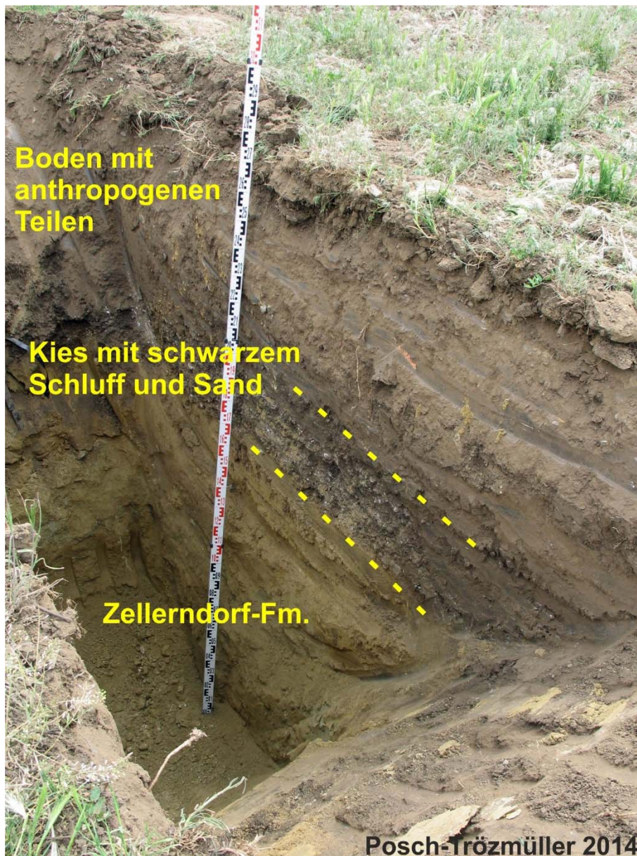
Abb. 2.1.78.: Blick in Schurf 7: Der oberste Meter von Schurf 7 war stark anthropogen beeinflusst, darunter folgten Mittel- bis Grobkiese in einer schwarzen schluffig-sandigen Matrix. Ab 1,4 m Tiefe wurden Schluffe der Zellerndorf-Fm. angetroffen.
