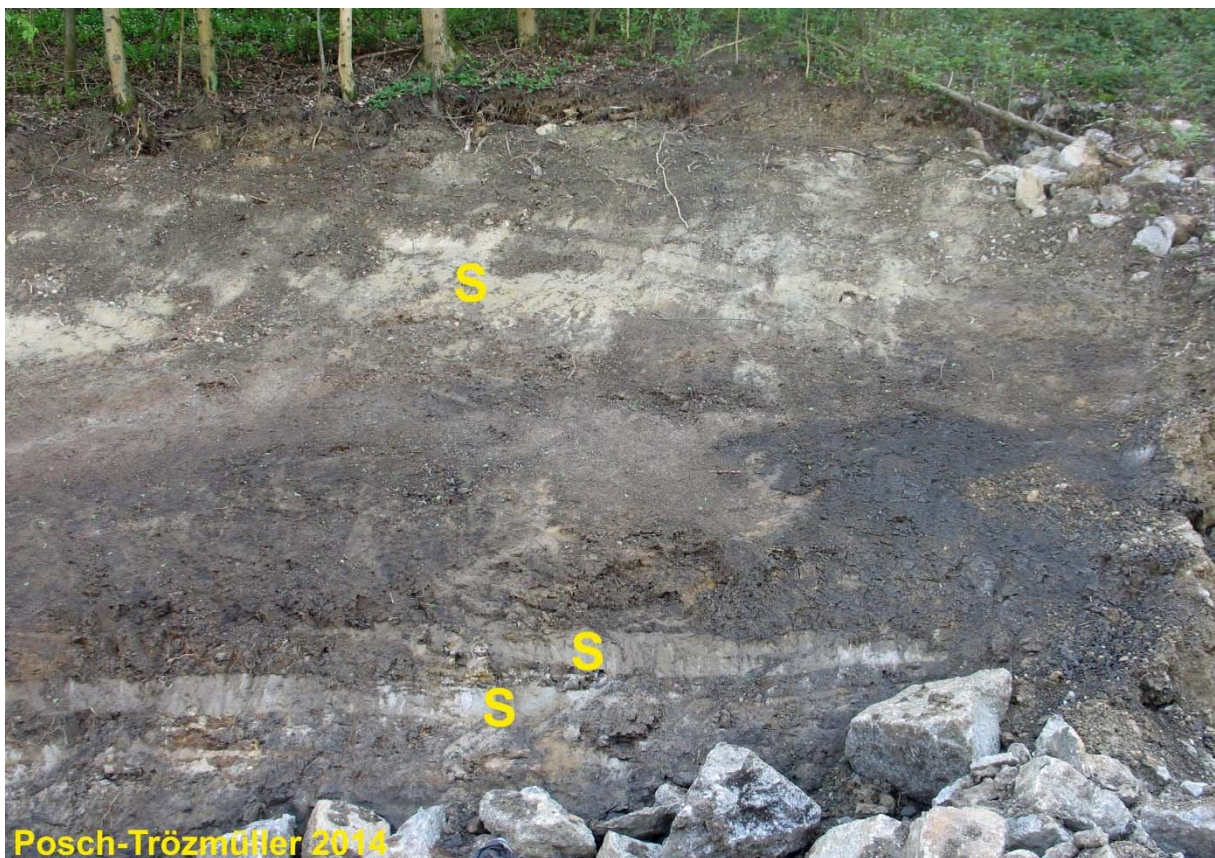
Abb. 2.1.8.: Aufschluss bei GPS 531: Schluffe und Töne der Pielach-Fm., mit mehreren Sandlagen (mit „S“ gekennzeichnet; die auf dem Bild sichtbaren Blöcke stammen nicht von hier).
