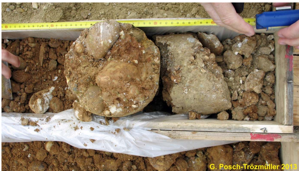
Abb. 2.4.11.: Detail von KB 2: 3,7-4,0 m: Kiese in toniger, rostroter Matrix, festgebacken.
