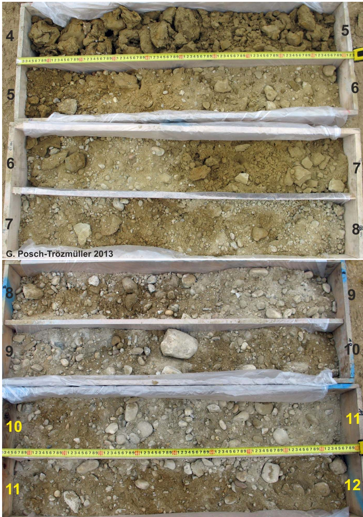
Abb. 2.4.16.: Kernbohrung SD III KB 3: 4-12 m. Die Bohrtiefenangaben beziehen sich nicht auf GOK, um die Tiefe unter GOK zu berechnen, muss jeweils 0,6 m addiert werden (siehe Bohrprofil, Tab. 2.4.4.).
