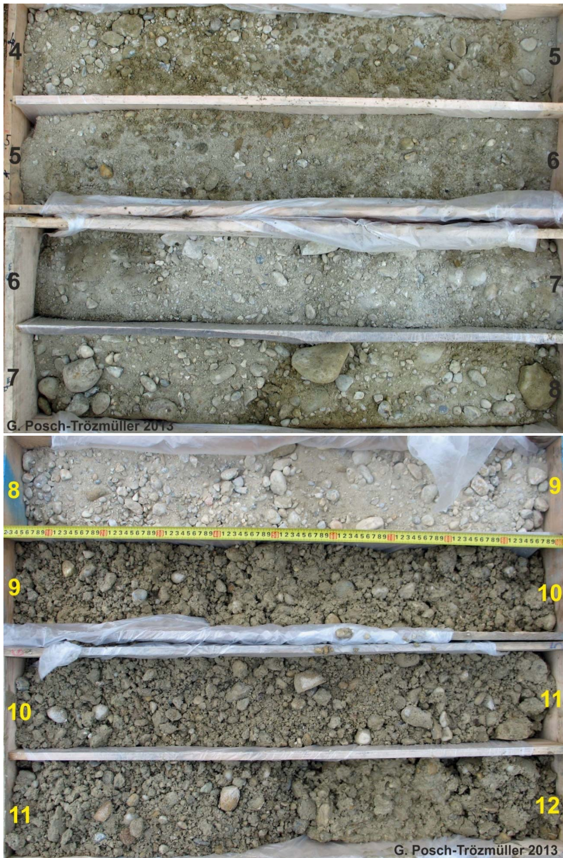
Abb. 2.4.7.: Kernbohrung SD III KB 1: 4-12 m. Die Bohrtiefenangaben beziehen sich nicht auf GOK, um die Tiefe unter GOK zu berechnen, muss jeweils 0,8 m addiert werden (siehe Bohrprofil, Tab. 2.4.2.).
