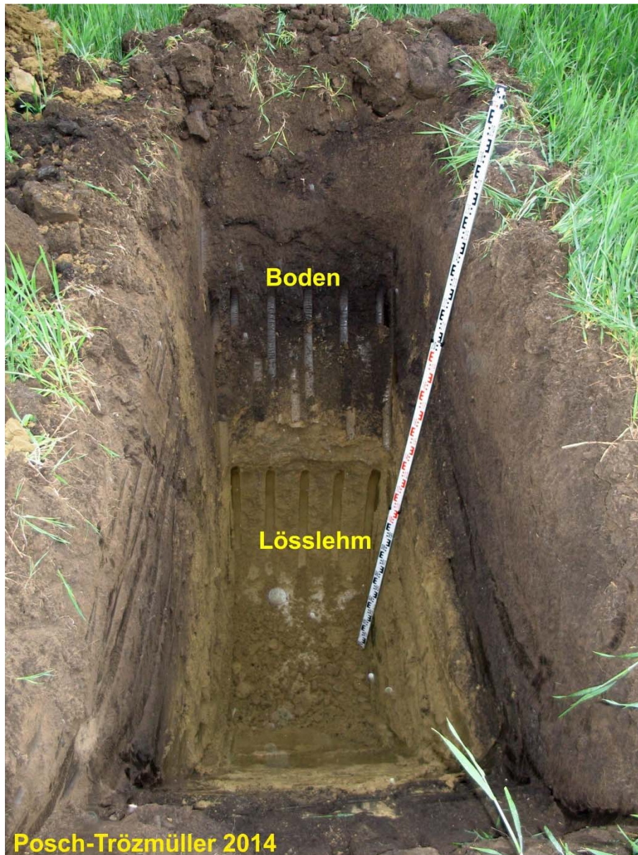
Abb. 2.1.84.: Blick in Schurf 9: Unter einer mächtigen Bodenbildung war ab 1,2 m Tiefe Lösslehm anzutreffen.
