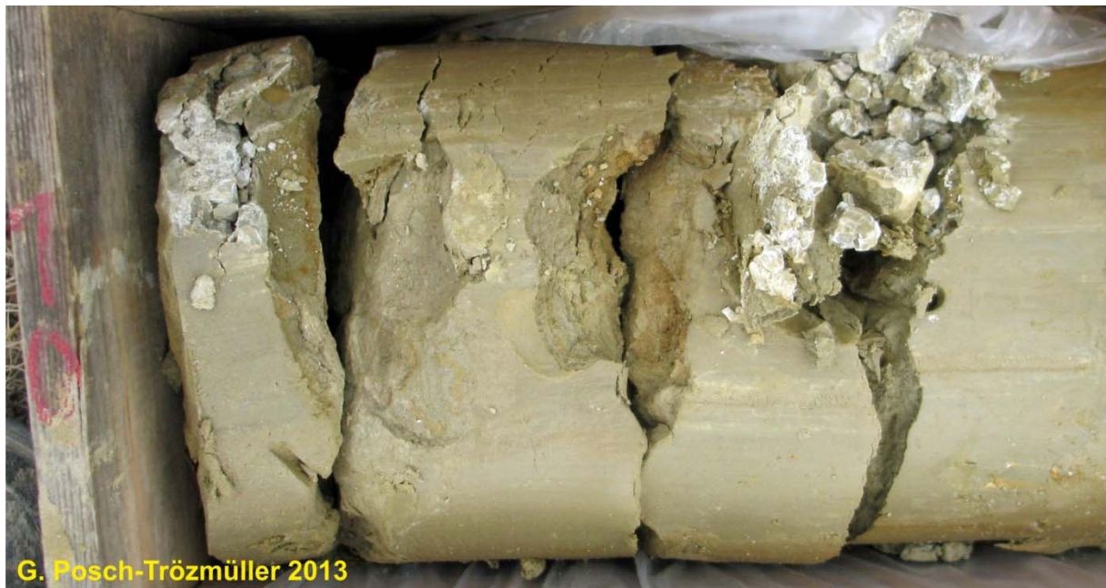
Abb. 2.4.27.: Detail von KB 6: Feste Kalkkonkretionen in 10,0-10,3 m Tiefe.
