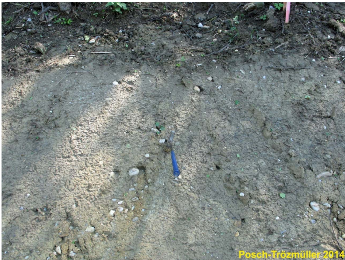
Abb. 2.1.16.: Lösslehm mit Kies zwischen GPS 533 und GPS 534. Der Lösslehm war hier relativ fest und kalkfrei, erreichte eine Mächtigkeit bis 2 m und enthielt relativ viel Kies.
