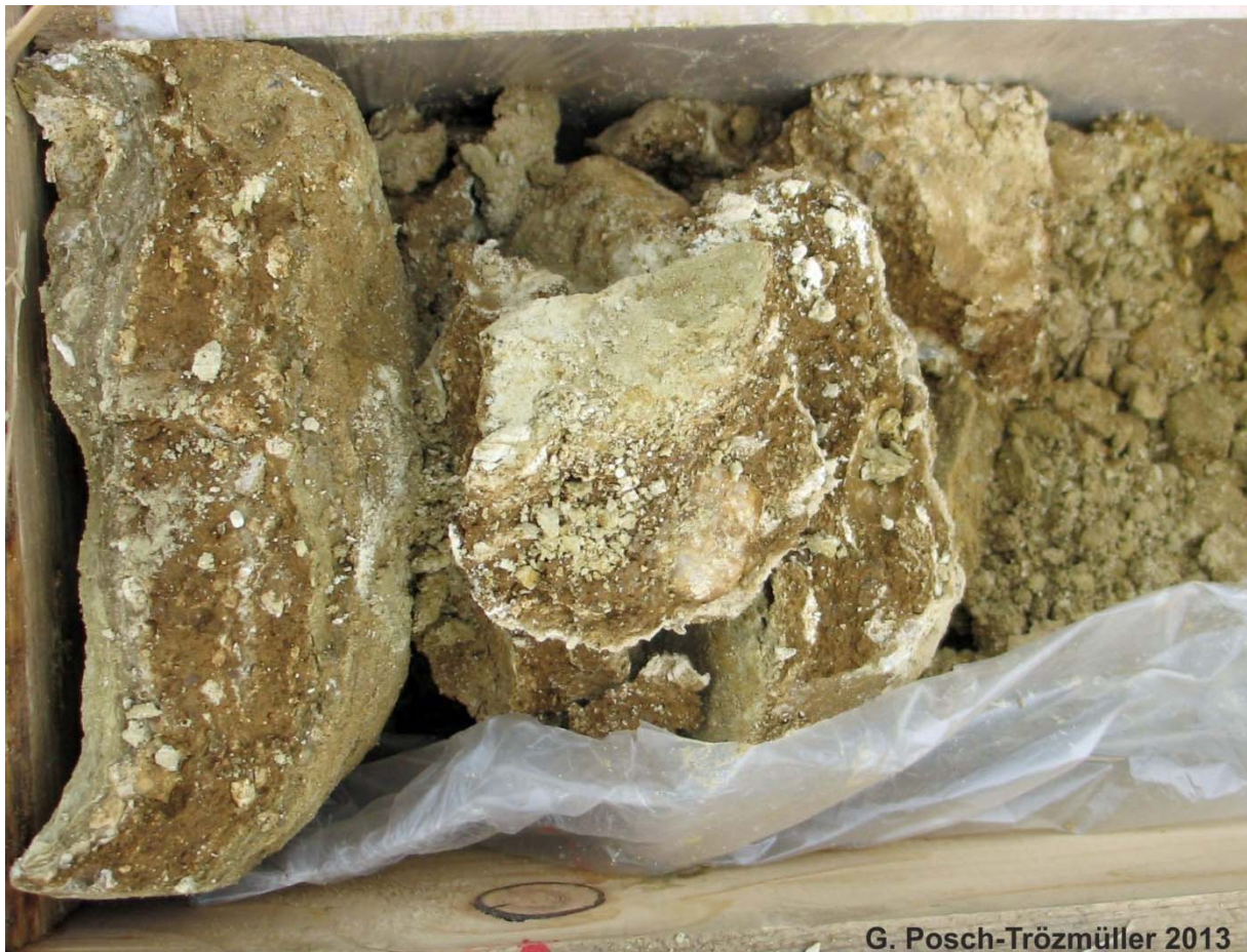
Abb. 2.4.24.: Detail von KB 6: 3,0-3,2 m Tiefe: Schokobraune, bindige Lage aus Schluff/ Ton mit vereinzelt, bis 2 cm großen Quarzkiesen.
