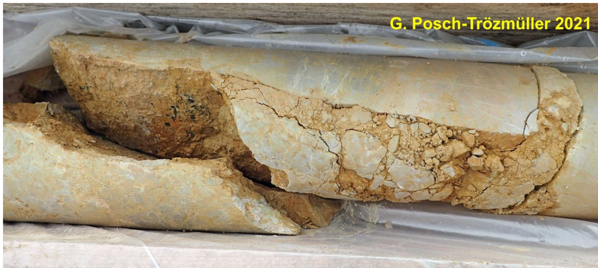
Abb. 112: Detail von KB 21/21: 27,4 m (rechts) bis 27,8 m (links): steilstehende Kluft, brekziös mit feinkörnigem Material und Dolomitkomponenten ausgefüllt.
