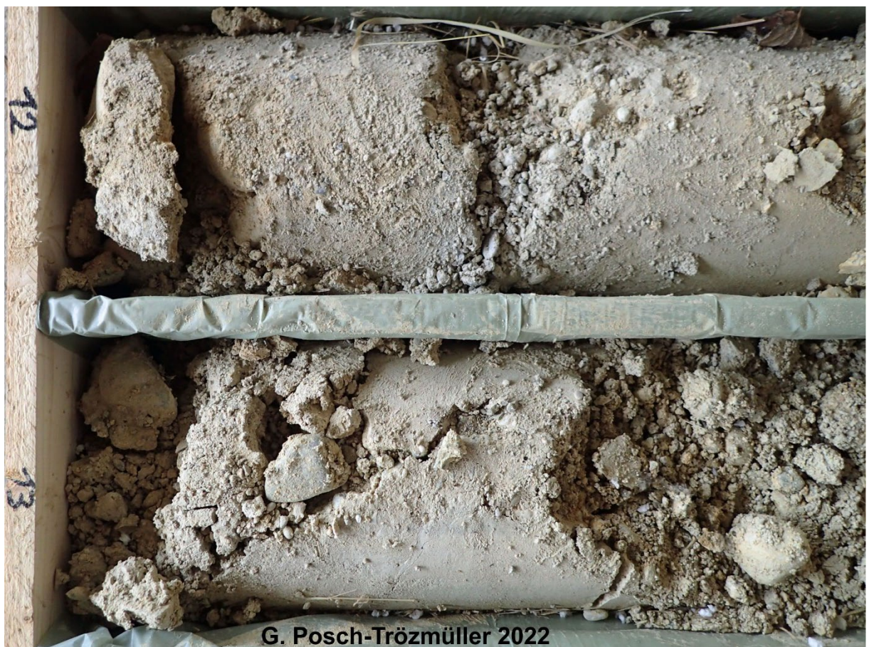
Abb. 34: KB 2 Badearena Krems - Detail von KB 2 in 12 und 13 m Tiefe: gut gerundete Kiese in schluffig-sandiger Matrix.
