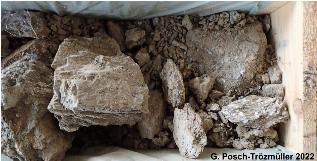
Abb. 48: KB 5 Badearena Krems - Detail in 9,8 bis 10 m Tiefe: Bruchstücke aus verwittertem Glimmerschiefer.
