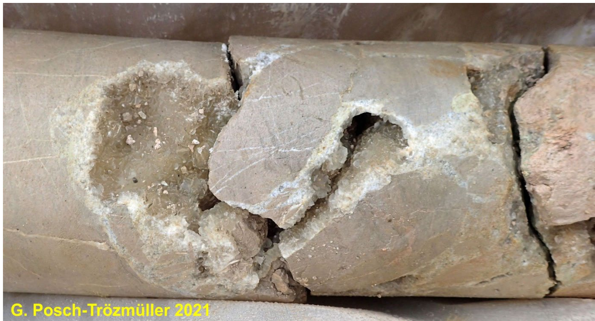
Abb. 106: Detail von KB 21/21: 12,3 (rechts) bis 12,5 m (links): mit Calcitkristallen ausgekleidete Lösungshohlräume.
