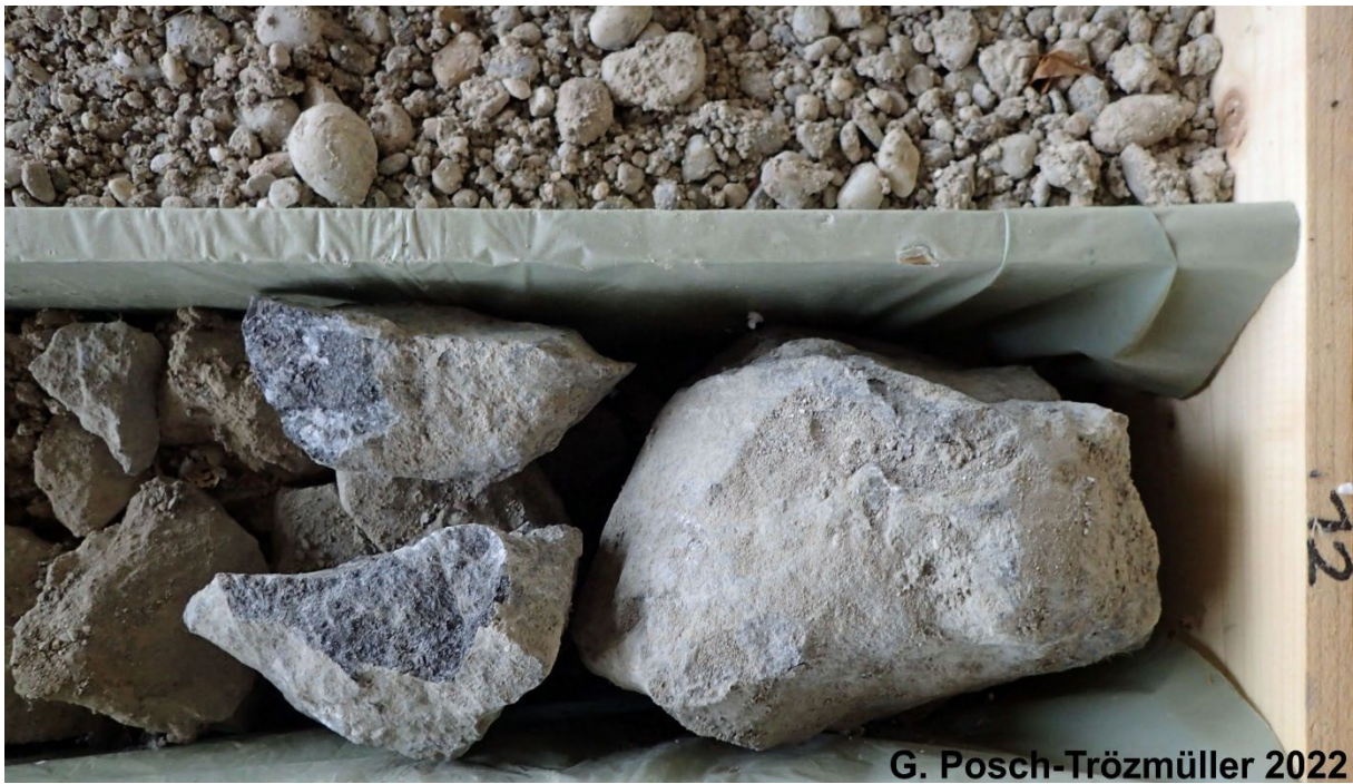
Abb. 43: Detail von KB 4 in 11,7 – 12,0 m Tiefe: Blöcke aus Amphibolit.
