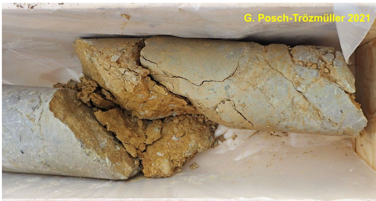
Abb. 111: Detail von KB 21/21: 25 m (rechts) bis 25,4 m (links): Kluft, mit feinkörnigem Material gefüllt.
