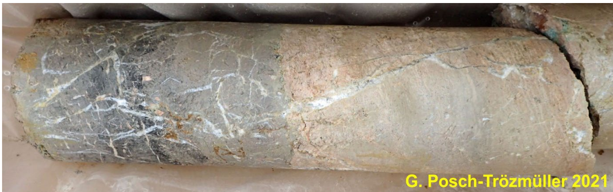
Abb. 109: Detail von KB 21/21: 19,5 m (rechts) bis 19,8 m Tiefe (links): grauer Dolomit mit zahlreichen calcitgefüllten Drucklösungsklüften (links), rötlicher, vermutlich mergeliger Abschnitt im Hauptdolomit (rechts).
