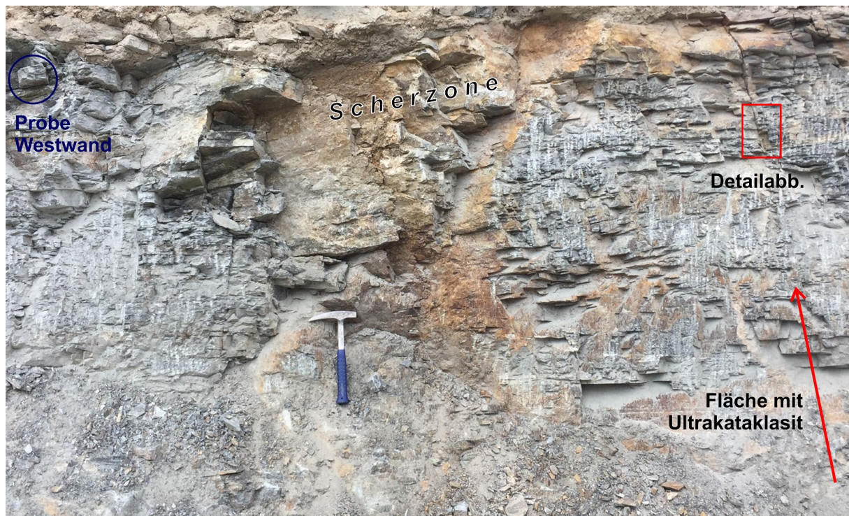
Abbildung 9: Westwand mit Fläche von Abbildung 8 (rot) und größerer Störungszone, ca. N-S-verlaufend, sowie Probenpunkt (im Kreis).
