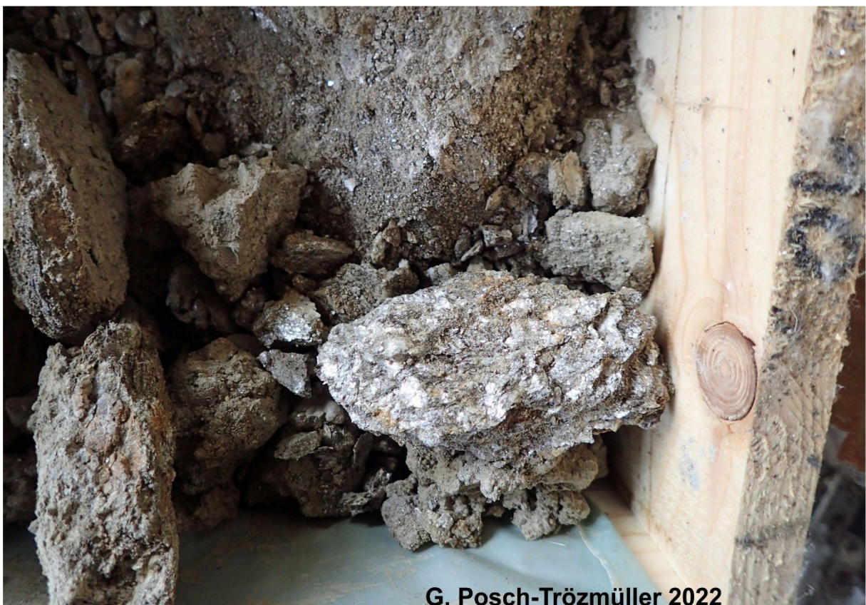
Abb. 49: KB 5 Badearena Krems - Detail in 10 m Tiefe: Verwitterter Glimmerschiefer.
