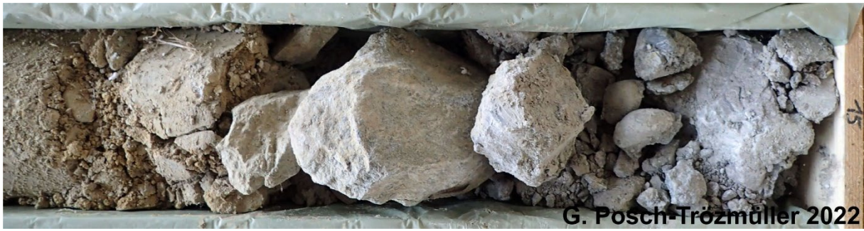
Abb. 29: Detail von KB 1: 14,5 bis 15,0 m: Kies in brauner Matrix (links), große Blöcke aus Gneis (Mitte), gut gerundeter Kies in grauer, feinkörniger Matrix (rechts).
