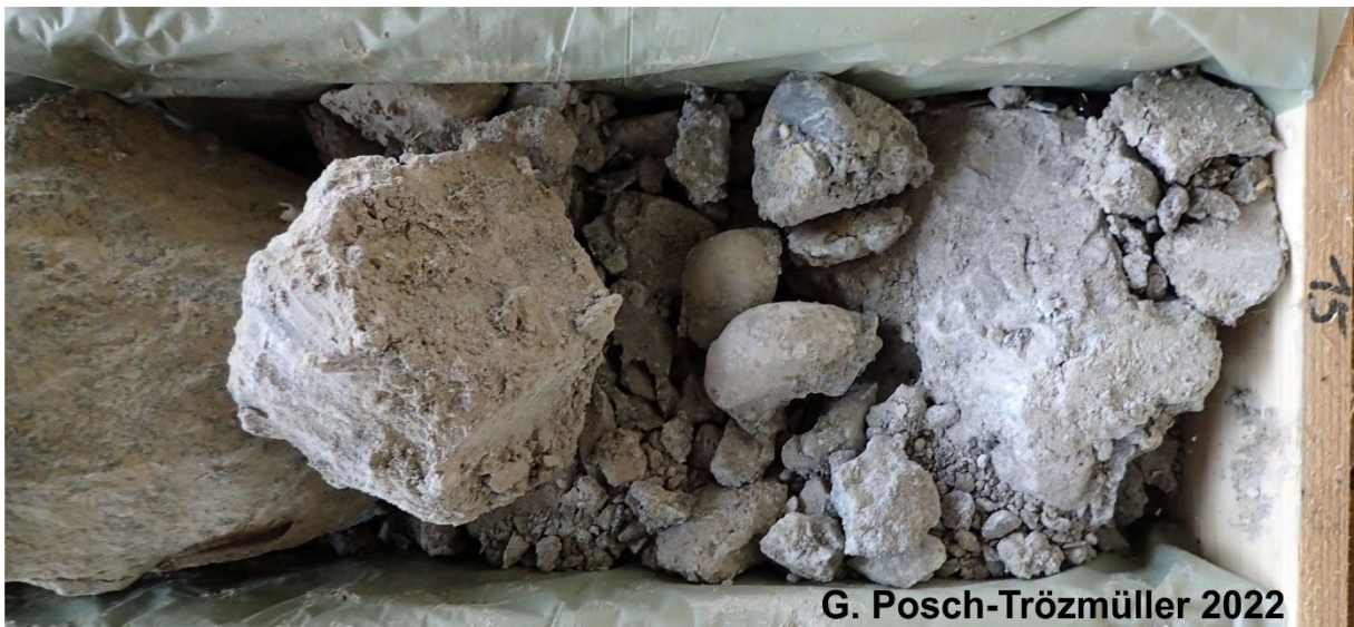
Abb. 30: Detail von KB 1: 14,8 bis 15,0 m: sehr gut gerundete Kieskomponenten in grauer Matrix.
