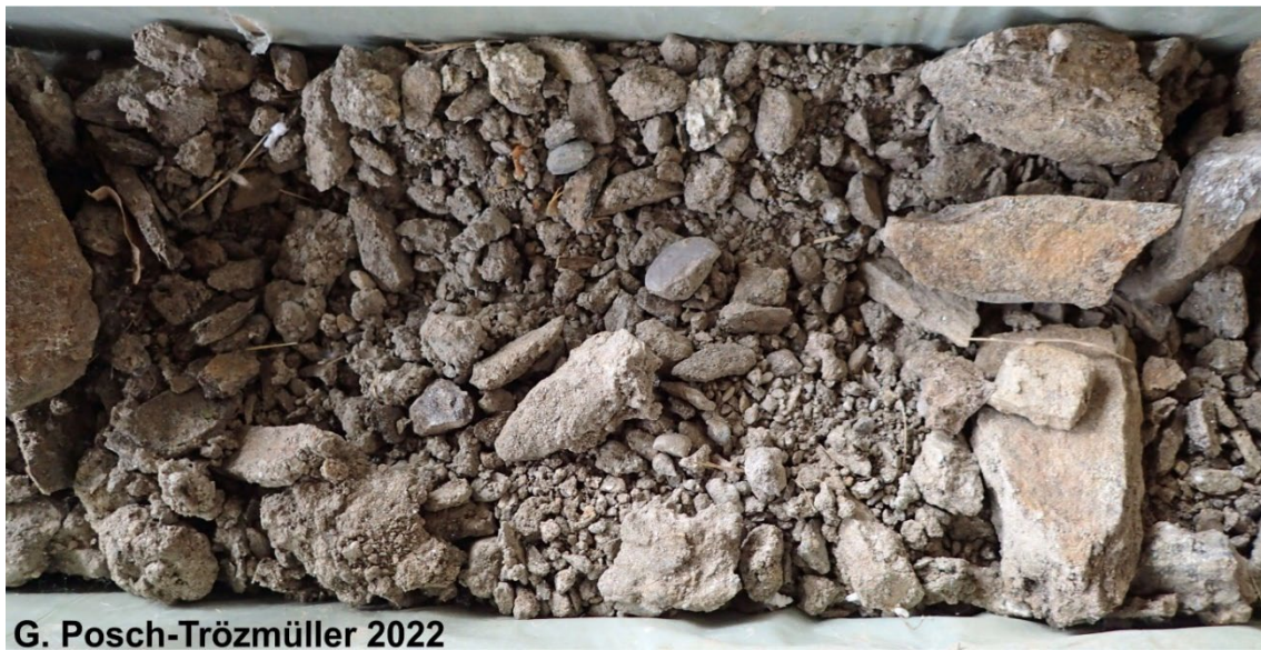
Abb. 46: KB 5 Badearena Krems - Detail in 9,3 bis 9,6 m Tiefe: Bruchstücke aus verwittertem Kristallin, mit vereinzelt gut gerundeten Kiesen.
