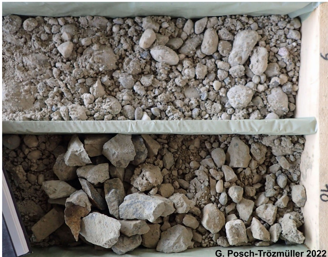
Abb. 38: KB 3 Badearena Krems - Detail von KB 3 in 9 und 10 m Tiefe: Sandiger, gut gerundeter Kies in 9 m Tiefe (oben), zerbohrter Block aus Amphibolit in 9,7 – 9,9 m Tiefe und gut gerundeter, sandiger Kies in 9,9 – 10,0 m Tiefe (unten).
