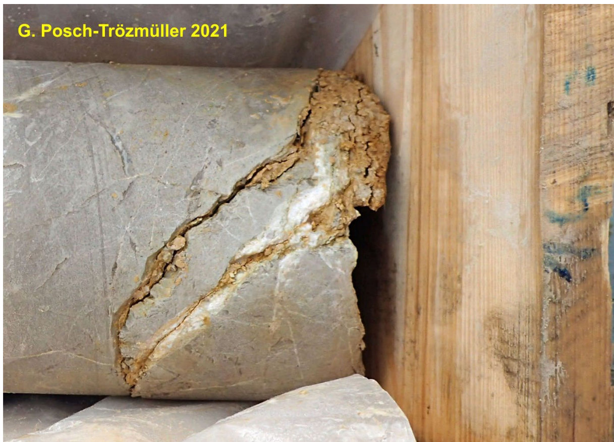
Abb. 107: Detail von KB 21/21: 14 m Tiefe: tonig belegte Kluftflächen.
