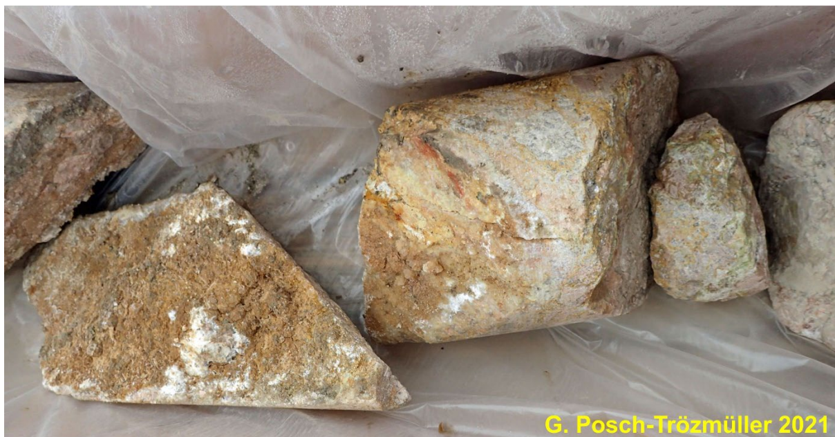
Abb. 122: Detail von KB 21/22: 15,3 (rechts) bis 15,6 m (links) Tiefe: Kluftkörper in brekziösem Abschnitt mit braunem Belag.
