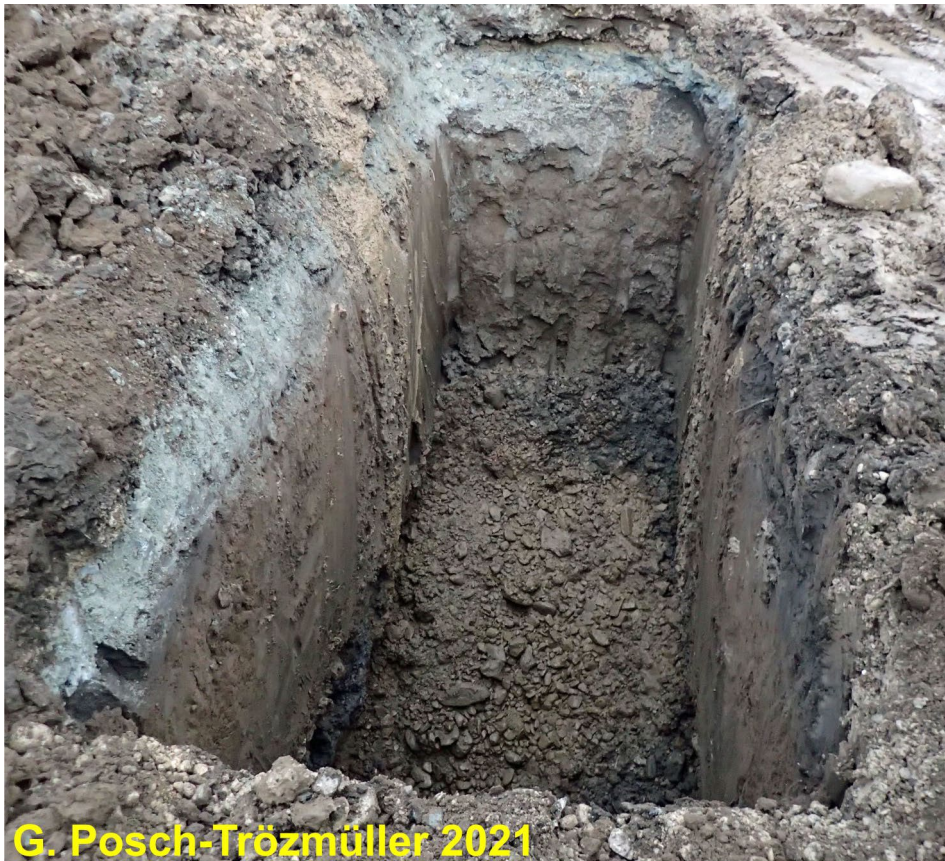
Abb. 132: Schurf 2: Unter der Anschüttung sind braune Schluffe, und in weiterer Folge Kiessande zu sehen.
