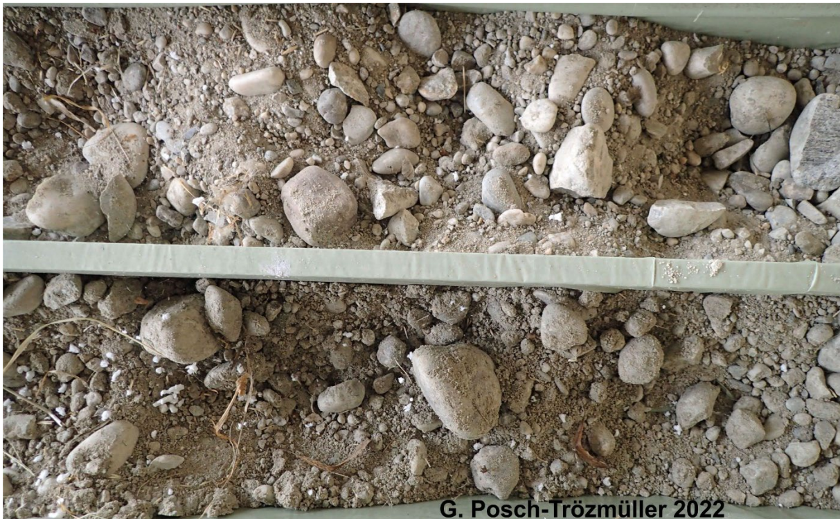
Abb. 27: Detail von KB 1: 2,4 bis 2,9 m: Gut gerundeter, stark sandiger Kies.
