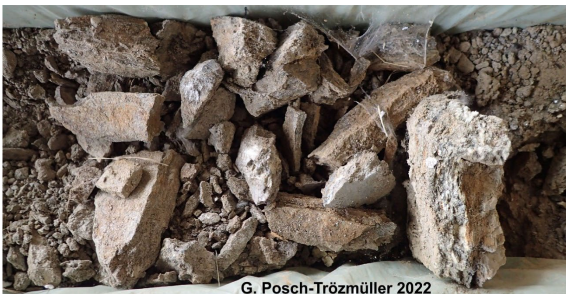
Abb. 47: KB 5 Badearena Krems - Detail in 9,5 bis 9,8 m Tiefe: Bruchstücke aus verwittertem Gneis und Glimmerschiefer.
