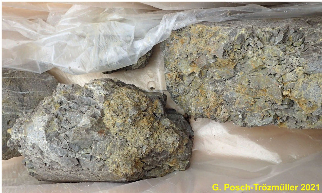
Abb. 120: Detail von KB 21/22: 12 bis 13 m Tiefe: brekziös ausgebildeter Hauptdolomit.
