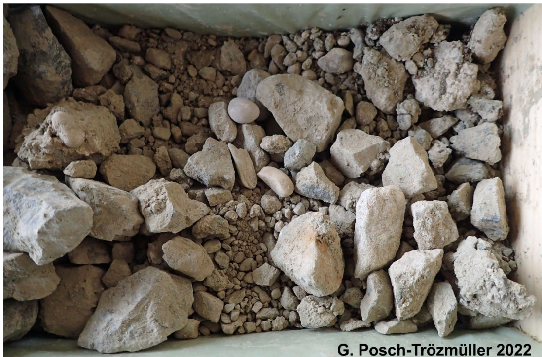
Abb. 39: KB 3 Badearena Krems - Detail von KB 3 in 9,8 bis 10,0 m Tiefe: kantige Bruchstücke eines zerbohrten Amphibolit-Blocks (links), darunter gut gerundete, sandige Kiese (mit kantigen Komponenten) in 9,9 bis 10 m Tiefe (rechts).
