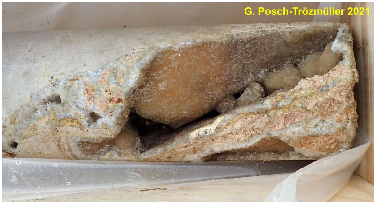
Abb. 110: Detail von KB 21/21: 20 m (rechts) bis 20,2 m (links): Lösungshohlraum, teilweise mit Calcitkristallen aufgefüllt.
