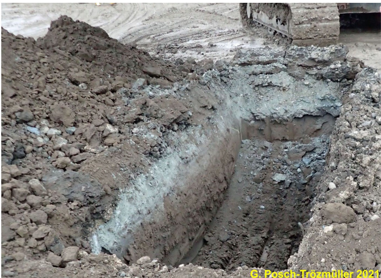
Abb. 131: Das graue Material in den oberen Bereichen von Schurf 2 ist Anschüttung, darunter sind braune Schluffe zu sehen.
