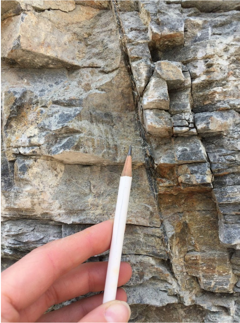
Abbildung 8: Fläche 330/70 (Westwand) mit dunkler, feinkörniger Spaltenfüllung, die als verfestigter Ultrakataklasit interpretiert wurde.
