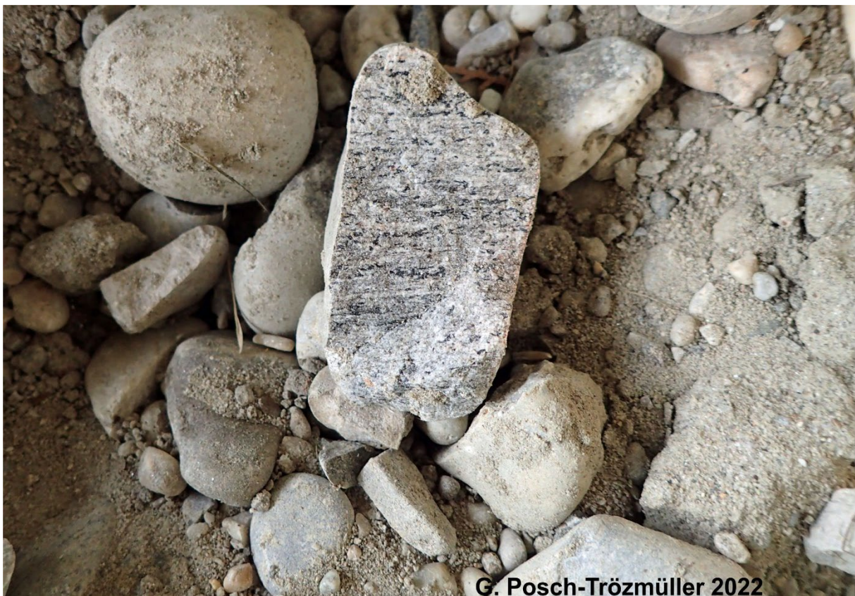
Abb. 28: Detail von KB 1: Gneis-Komponente (vmtl. Gföhl-Gneis) in 2,9 m Tiefe.
