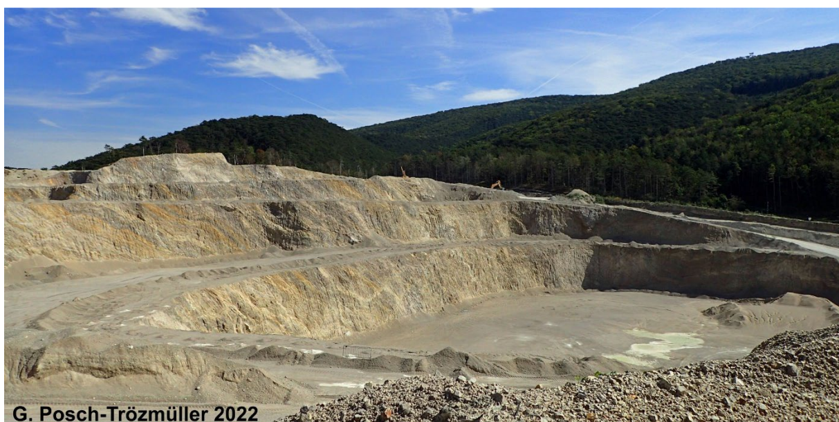
Abb. 2/36: Aktueller Abbaubereich des Steinbruchs Gaaden im E-Abschnitt, Blickrichtung ca. SE. Deutlich ist das Einfallen der gebankten Dolomite in südliche Richtung inklusive leichter Faltenbildung zu sehen.
