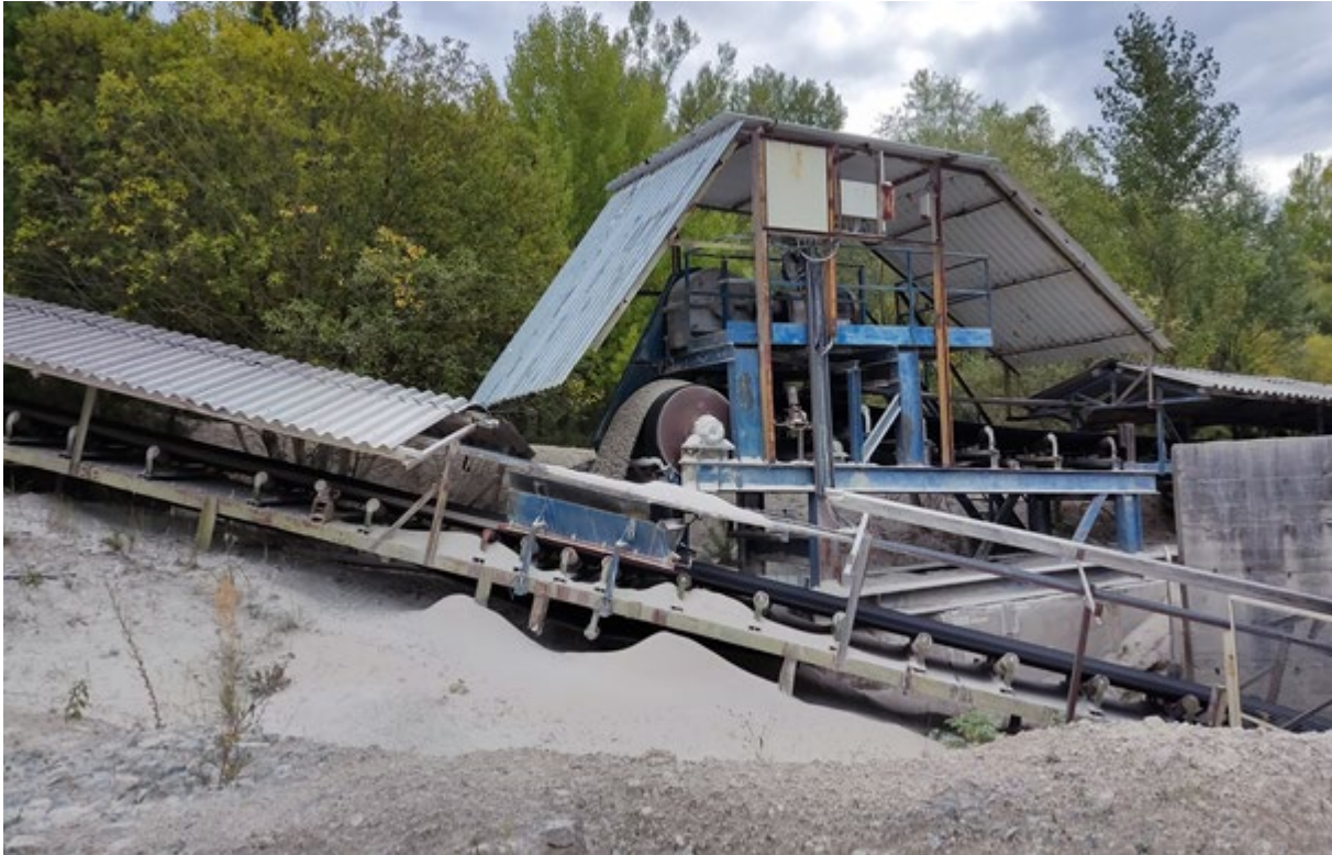
Abb. 2/111: Transport per Förderband zum Aufbereitungsstandort (Foto: H. Reitner, 2022).
