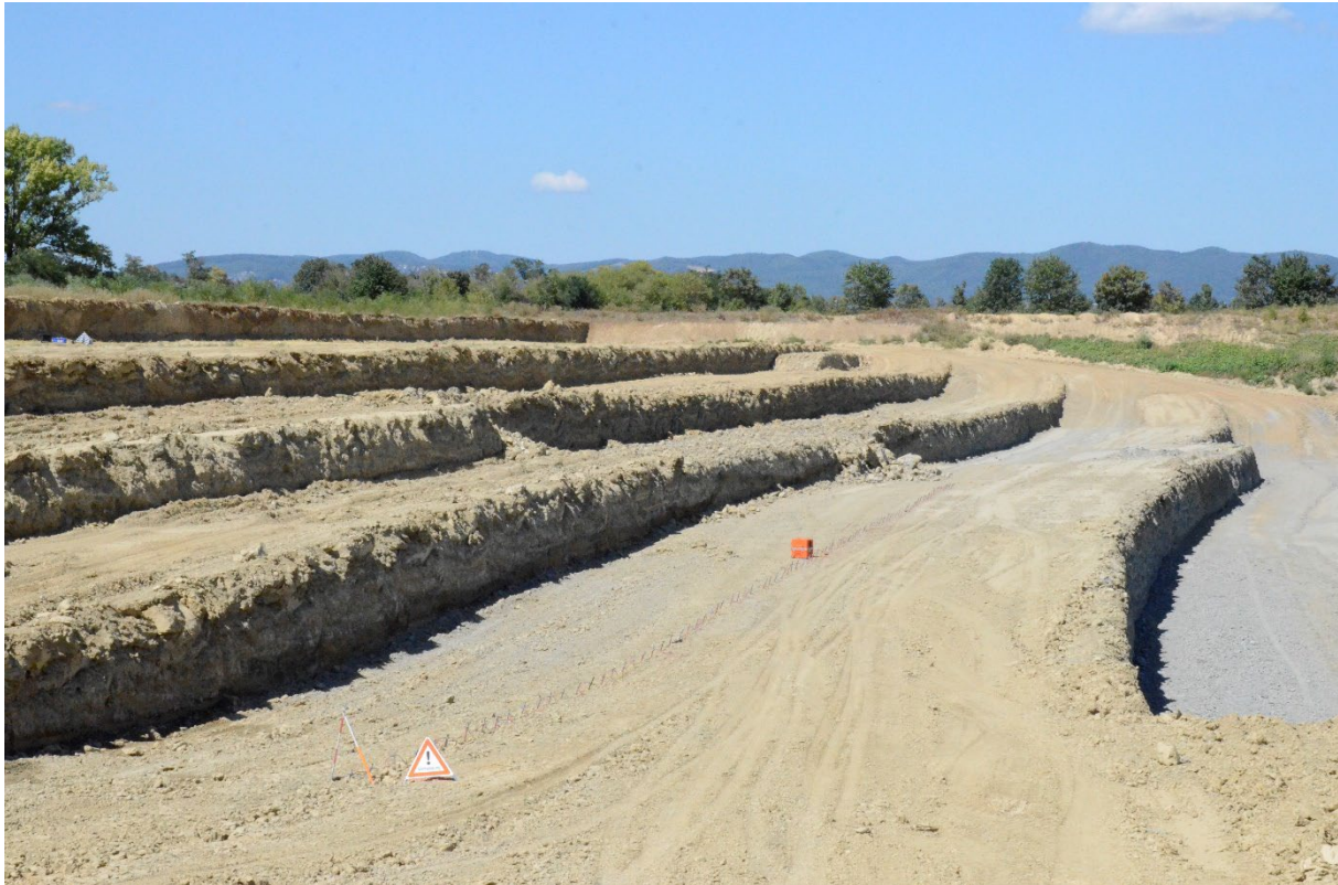
Abb. 2/90: Blick auf die oberen Abbauetagen, die vorwiegend aus braunen bis ockerfarbenen Silten mit variablen Ton- und Sandgehalten aufgebaut werden. Auf der Etage im Vordergrund sieht man die Auslage für ein Geoelektrik-Profil (Foto: A. Ita, 2022).
