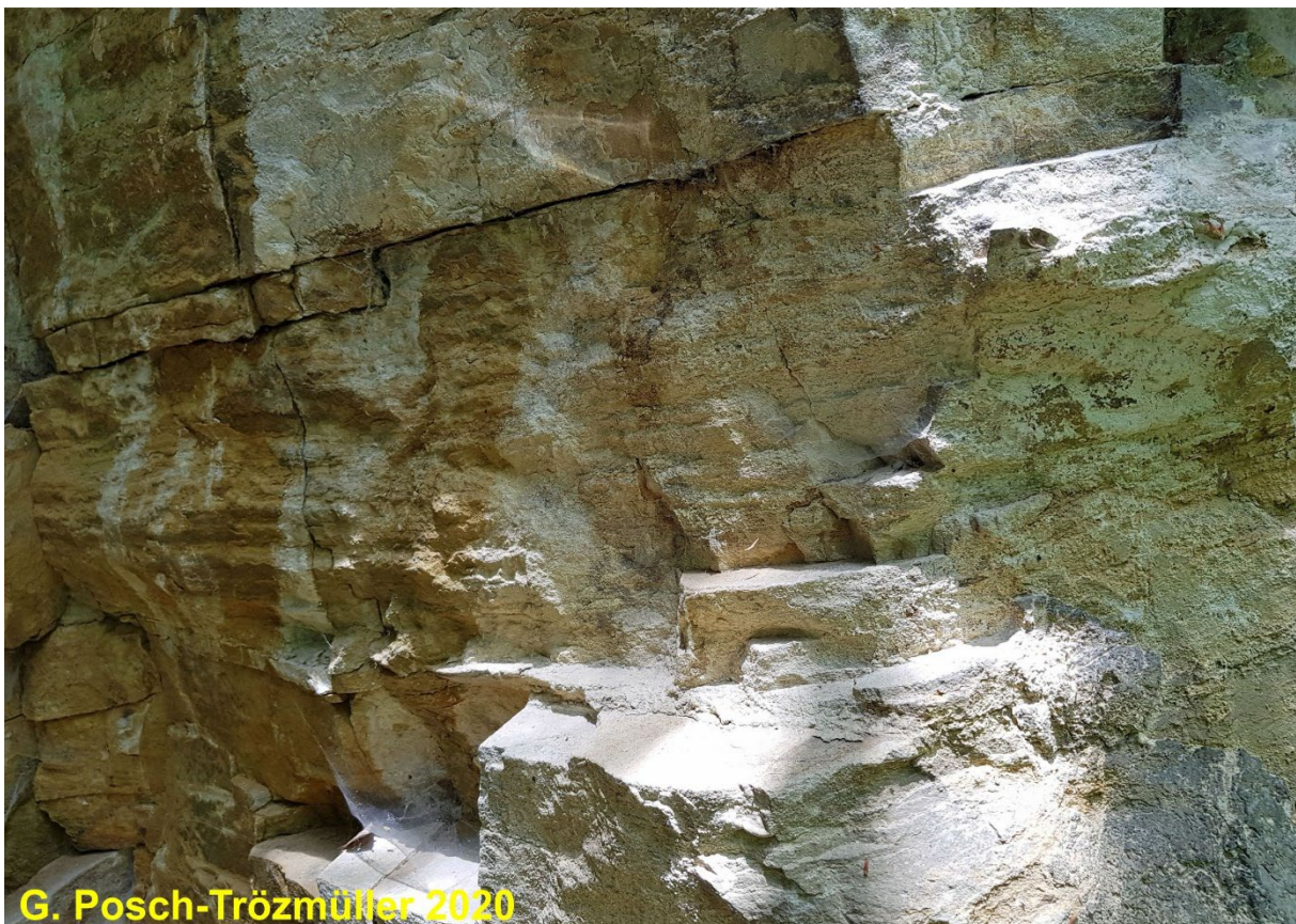
Abb. 2/81: Detail des Sandsteins – Schichtung, Klüftung – im ehemaligen Abbau 058/237 in Laab i. W.
