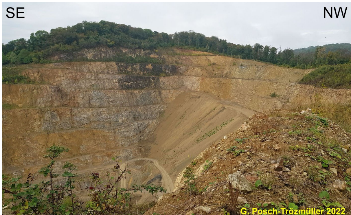
Abb. 2/56: Blick vom nördlichen Rand des Steinbruchs etwa Richtung WSW Richtung Kleiner Sattel (Berg links oben) auf die südliche (nordschauende) und die westliche (ostschauende, rechts) Abbauwand. In der Westwand, die zum Großteil überschüttet ist, sind breite Störungsbereiche sichtbar (rechts der Bildmitte).
