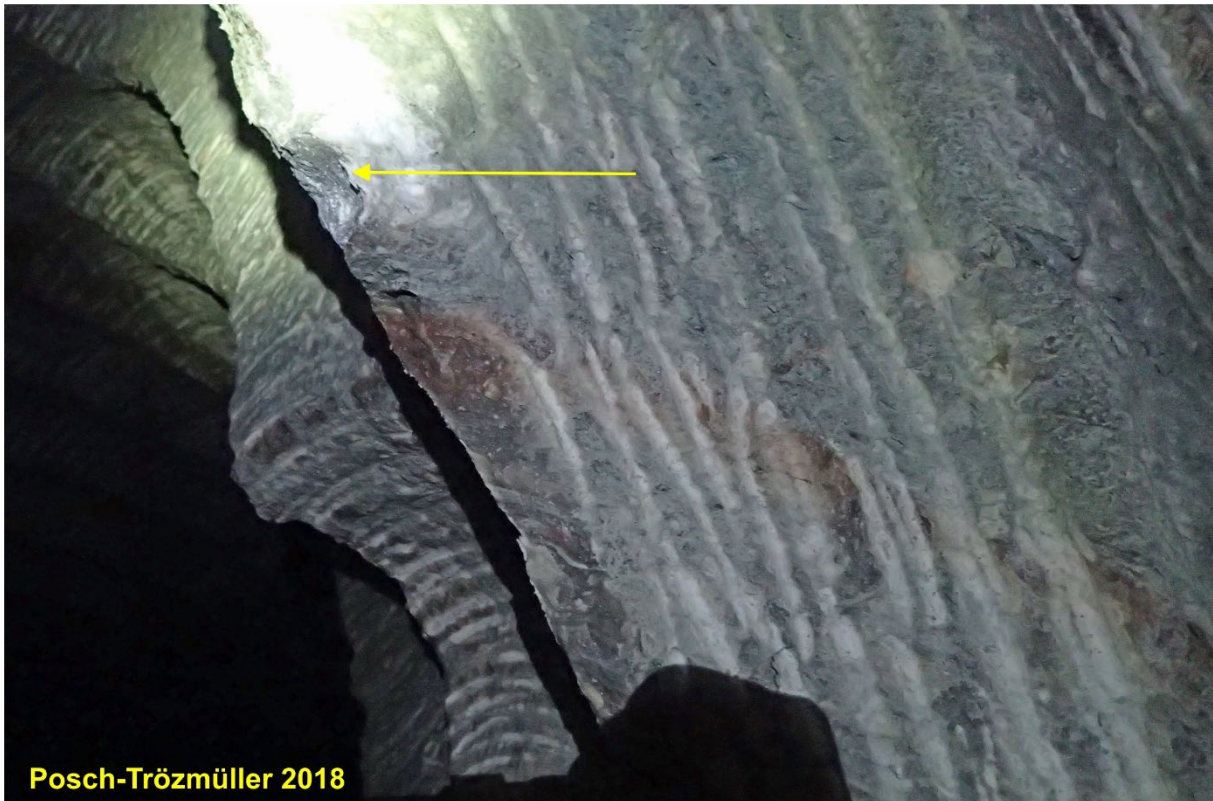
Abb. 2/198: Probenahmepunkt 3 (gelber Pfeil) auf der 7. Sohle, Lokalität 7.180 des Gipsbergbaues Preinsfeld. Unterhalb des Pfeils ist eine rote Gipslage im grauen Gips zu sehen.
