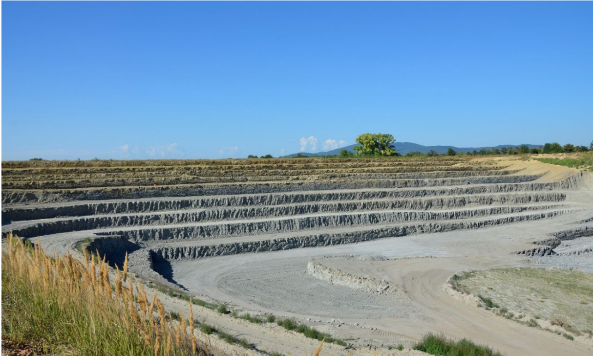
Abb. 2/87: Blick auf den aktuellen Abbaubereich der Grube in Hennersdorf. Die unteren Etagen werden von dunkelgrauen bis blaugrauen Tonmergeln aufgebaut, im Hangenden folgen ockerfarbige bis braungraue Silte. Überlagert wird die Abfolge von quartären Kiesen (Foto: A. Ita, 2022).
