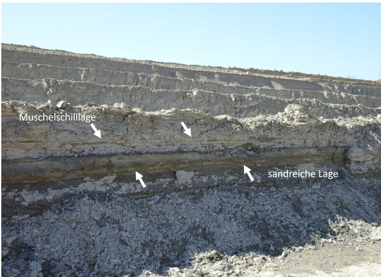
Abb. 2/88: Blick auf die untersten Abbauetagen der Grube in Hennersdorf, die aus dunkelgrauen bis blaugrauen Tonmergeln aufgebaut werden (Foto: J. Rabeder, 2022).
