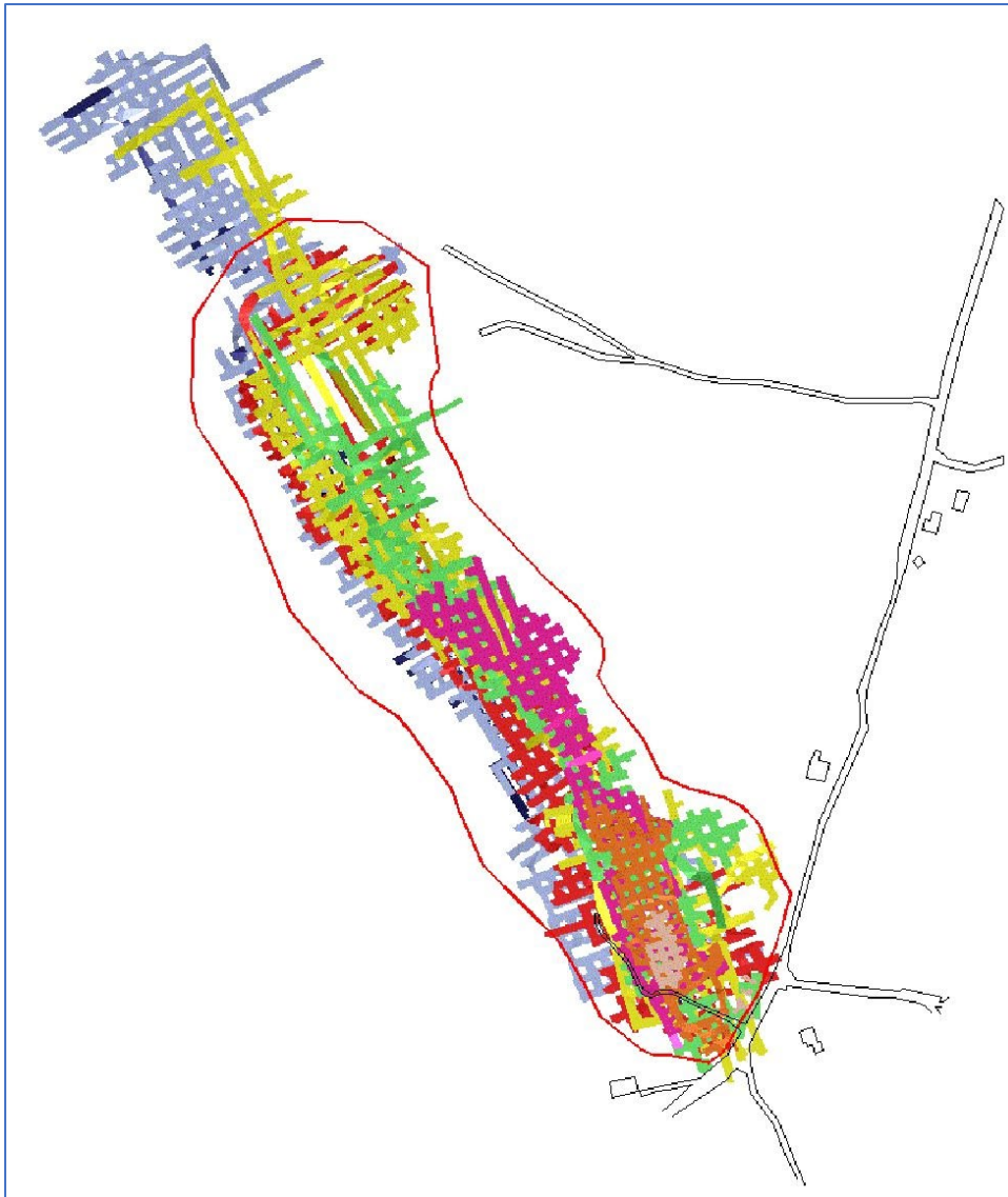
Abb. 2/179: Darstellung des Grubengebäudes im 3D-Modell Leapfrog der iC consulenten, die Sohlen sind unterschiedlich eingefärbt (Daul, 2005).
