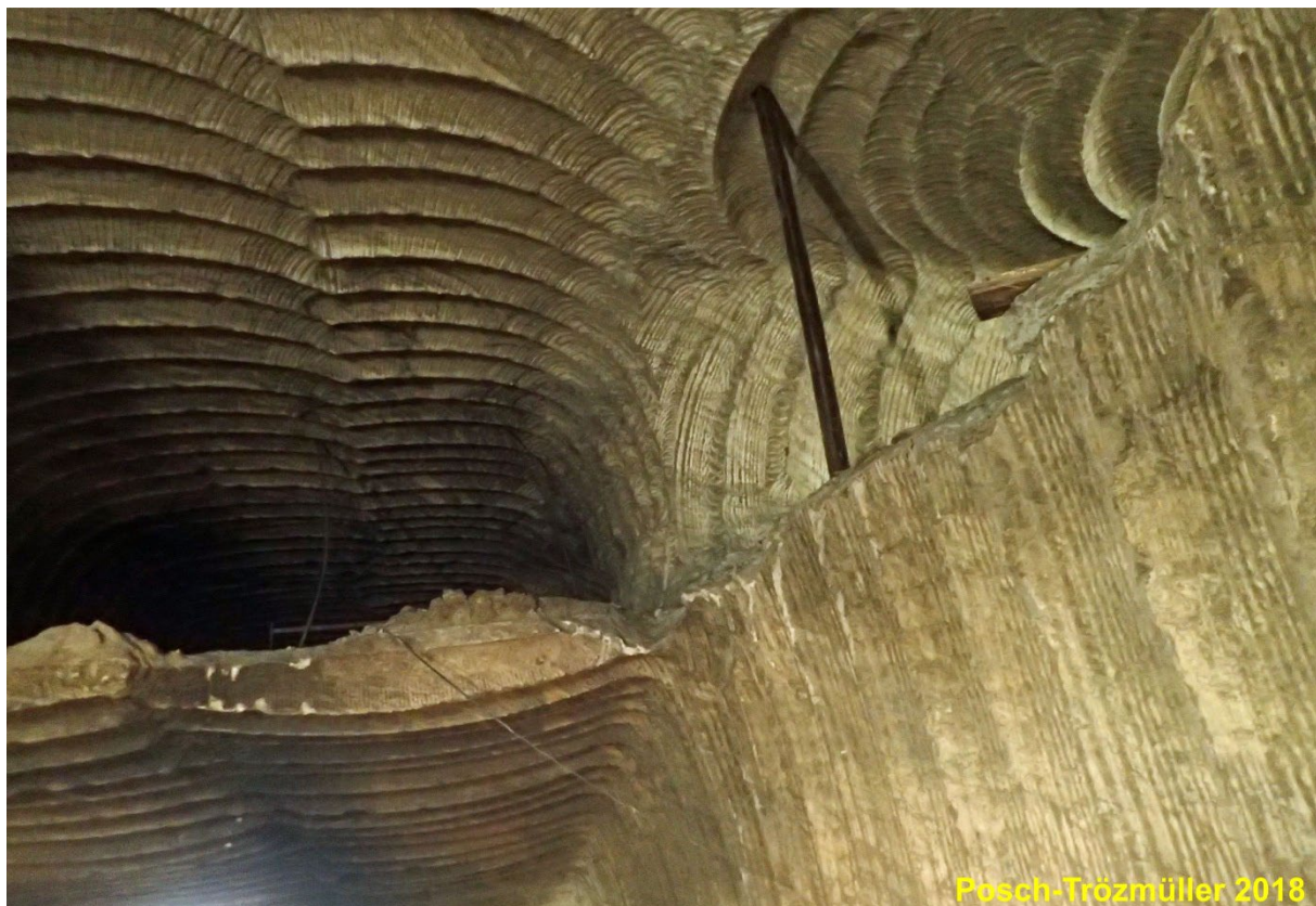
Abb. 2/181: Angeschnittene Sohle und Abbauspuren im Gipsbergbau Preinsfeld.
