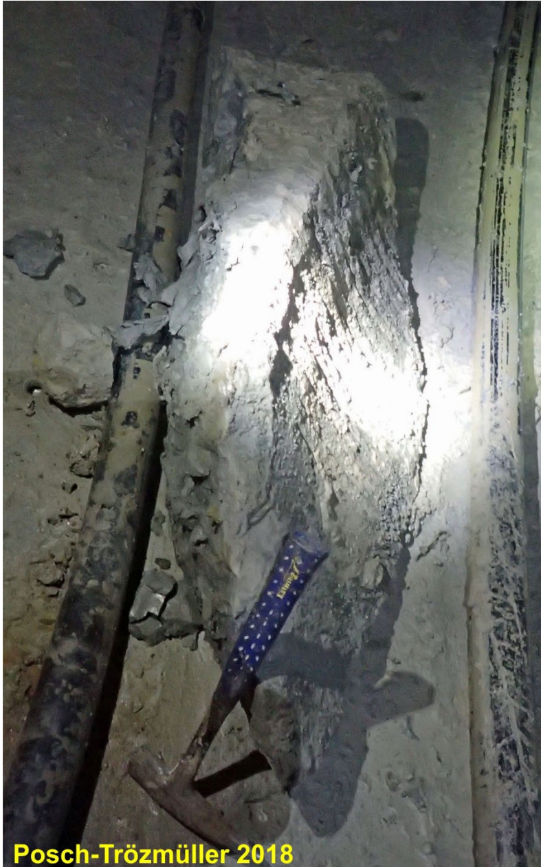
Abb. 2/203: Aus der Firste herabgestürzter Block auf Sohle 5 des Bergbaues, von dem Probe 7 abgeschlagen wurde.
