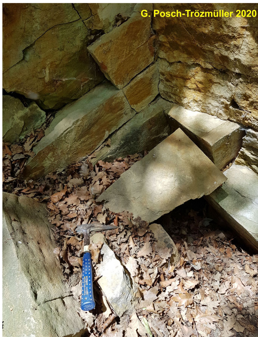
Abb. 2/83: Scharfkantige Klüftung im Sandstein des ehemaligen Abbaus 058/237 in Laab im Walde.
