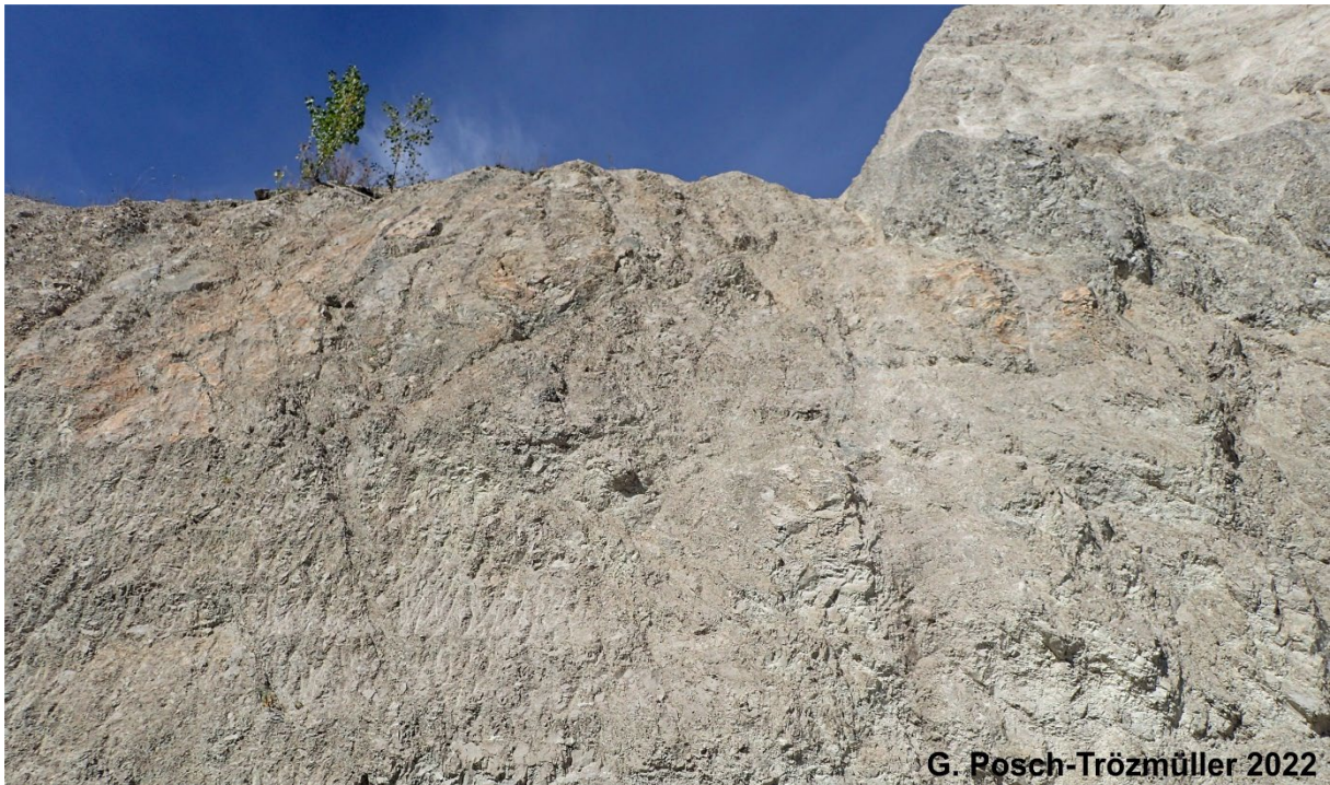
Abb. 2/43: Kleinstückig zerbrechender Hauptdolomit im Steinbruch Gaaden.
