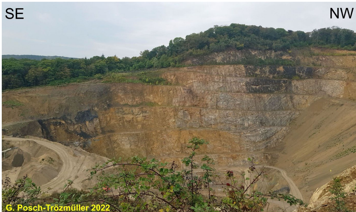
Abb. 2/55: Blick vom nördlichen Rand des Steinbruchs Richtung SW auf den Kleinen Sattel (rechts oben) auf die südliche (nordschauende) Abbauwand. Im linken Bildbereich sind Mergelschiefer zu sehen, ein großer Teil der Südwand wird aus Hierlatzkalk aufgebaut.
