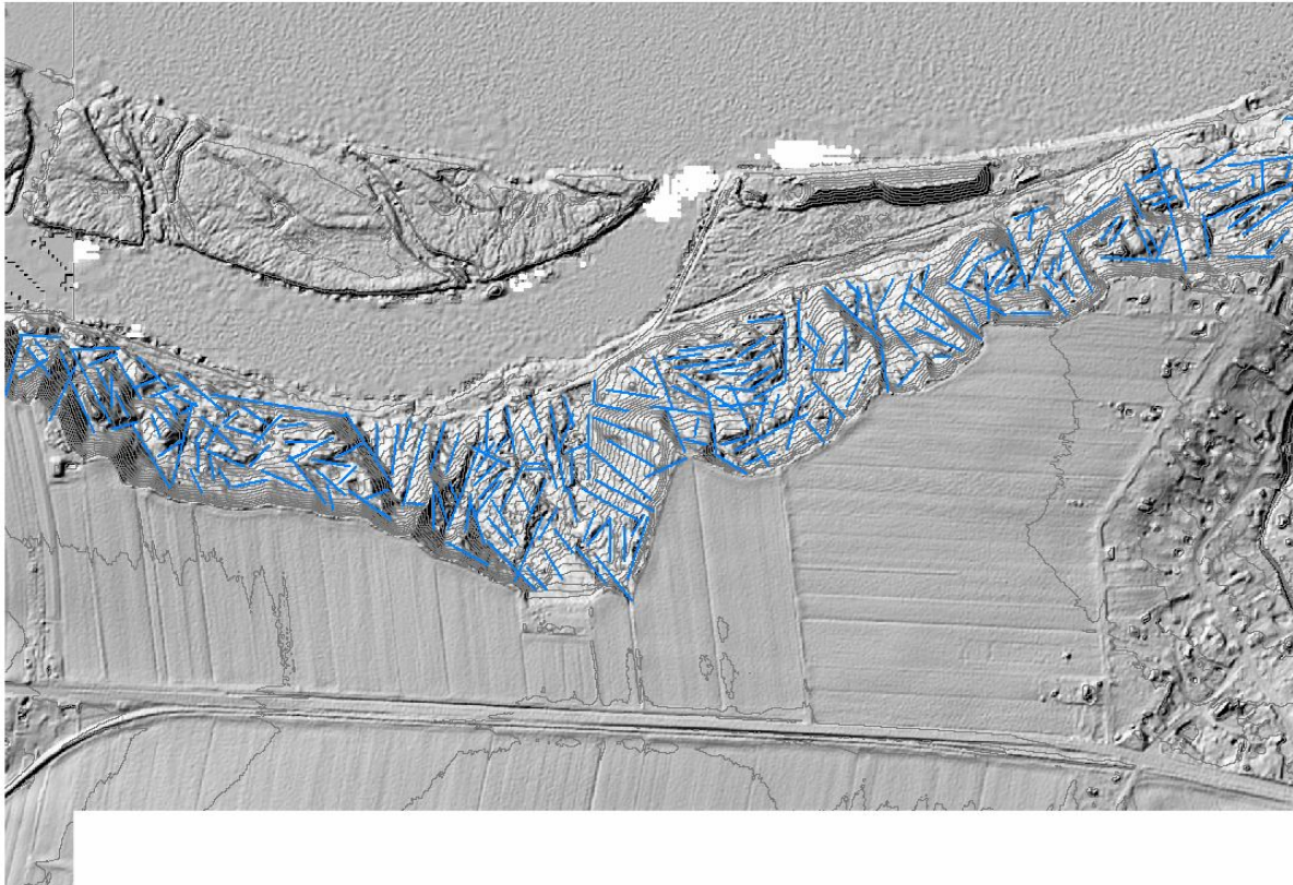
Abb. 8.-6: Lineare Strukturen entlang Terrassenkörper und innerhalb der Rutschungskörper westlich Wildungsmauer; DHM 1m: © Land Niederösterreich.
