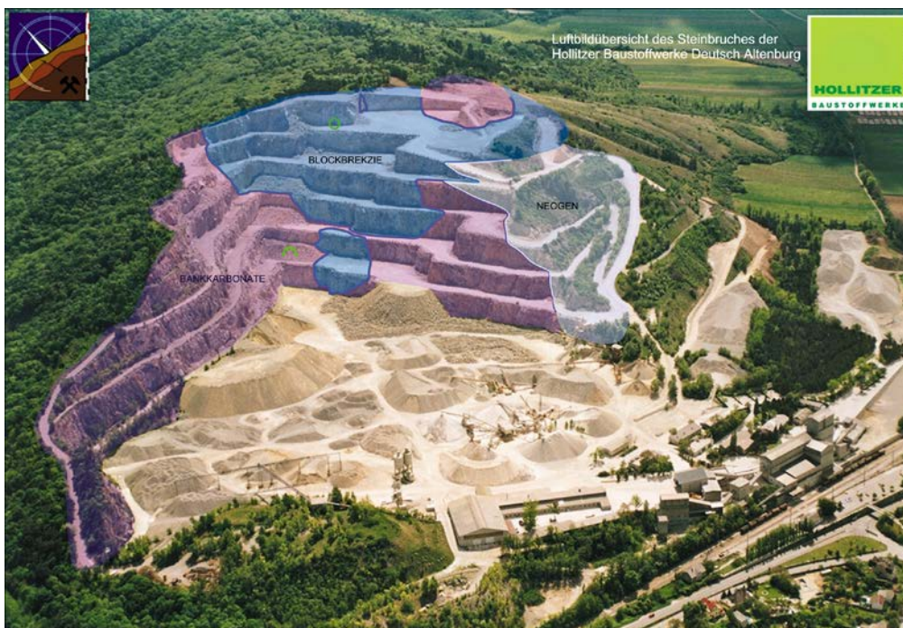
Abb. 4.-14: Geologische Übersicht zum Steinbruch Hollitzer: Triadische Bankkarbonate, jurassische Blockbrekzie und neogene Sedimente des Wiener Beckens; Quelle: WESSELY, 2006.
