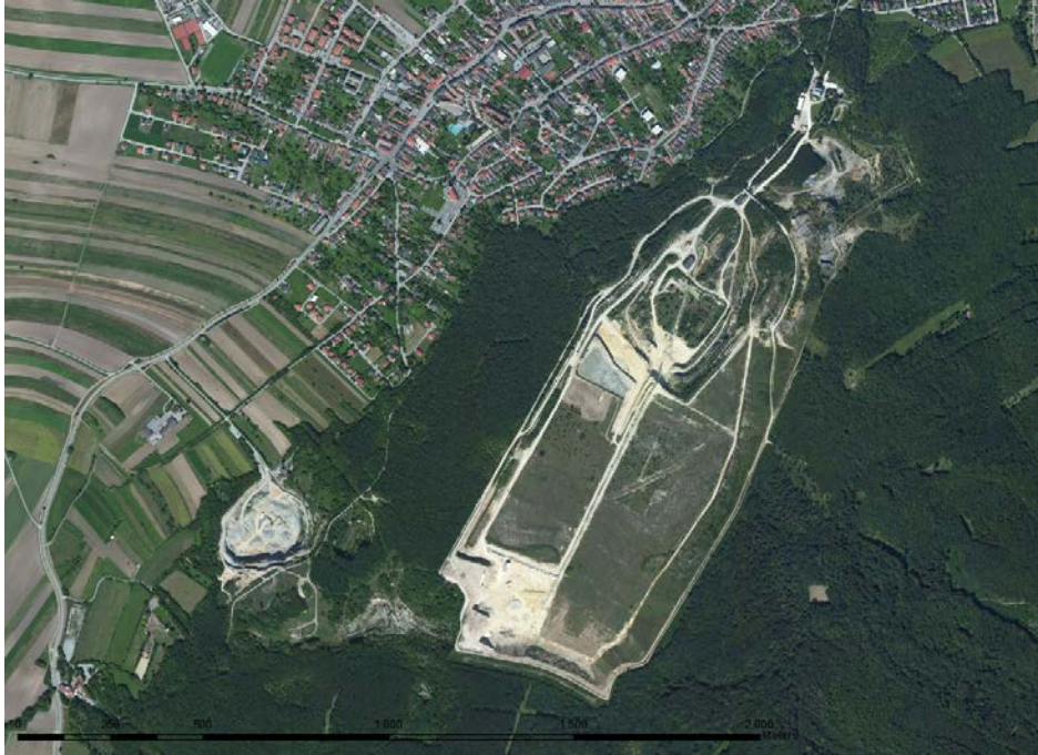
Abb. 4.-22: Das langgestreckte Steinbruchareal Mannersdorf (Leithakalk, 078/014) und südwestlich davon der Baxabruch (078/001), der in den liegenden Mitteltriaskarbonaten des Grundgebirges umgeht; Quelle: Bing Maps.
