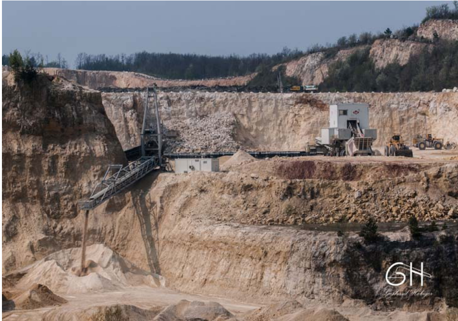
Abb. 4.-24: Abbau, mobiler Brecher und Förderband im Leithakalk-Steinbruch in Mannersdorf (078/014), aufgenommen anlässlich der Abschlussexkursion des Projektes; Aufnahme: G. Hobiger, 2013.
