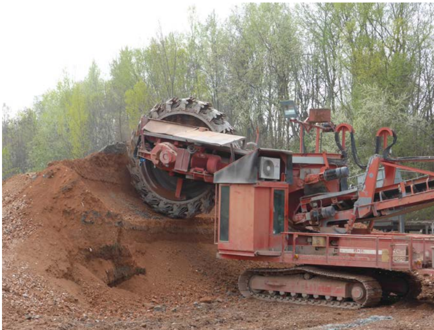
Abb. 4.-11b: Abbau der aus schichtweise wechselnden Lagen von Ziegelsplitt und Pannon-Tonen aufgebauten und etwa 6 m hohen Halde; Aufnahme: M. Heinrich, 2013.
