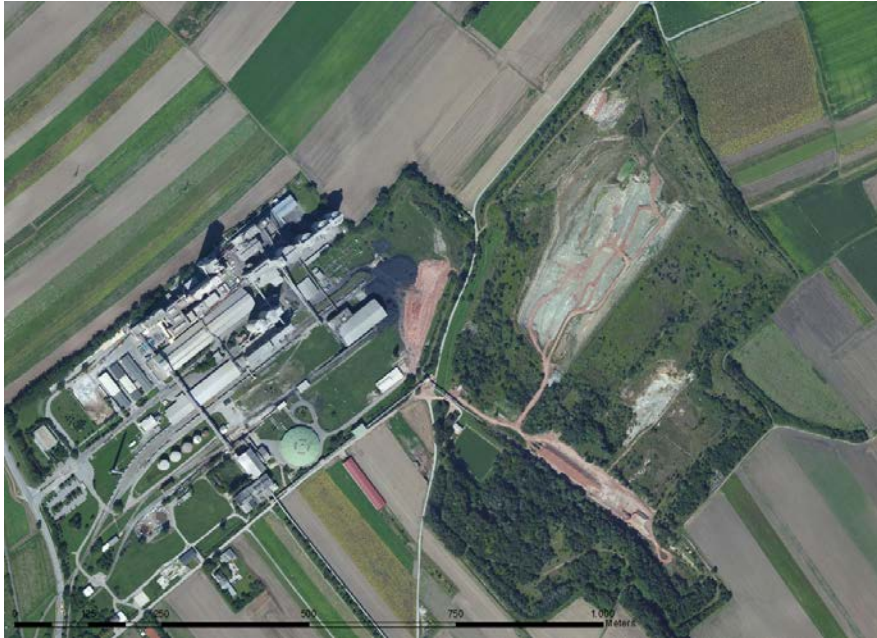
Abb. 4.-11a: In-situ Tonabbau (078/077) und Haldenverwertung für das Zementwerk Mannersdorf; Quelle: Bing Maps.
