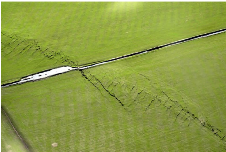
Abb. 8.-24: Bruchstrukturen an der Oberfläche in Folge des „Christchurch-Erdbebens“ / Neuseeland vom 4. September 2010; Bildmaterial aus Presseberichten.
