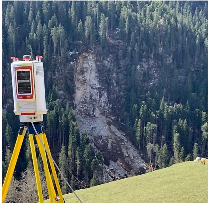
Abb. 13: Terrestrischer Laserscanner des Landes Tirol im Weiler Mellitz mit Blick auf Abrisskante und Sturzbahn des Felssturzes vom 14. April 2020 auf der orografisch rechten Talseite der Schwarzach im Gemeindegebiet von Sankt Veit in Deferegggen (© Foto: Johannes Anegg/Land Tirol; Quelle: Webseite des Landes Tirol) [7].
